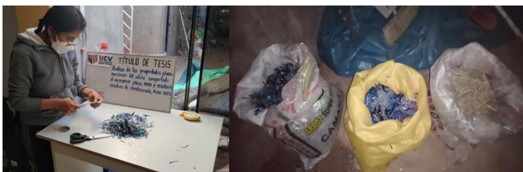
Figura 10. Producción de fibras PEBD
