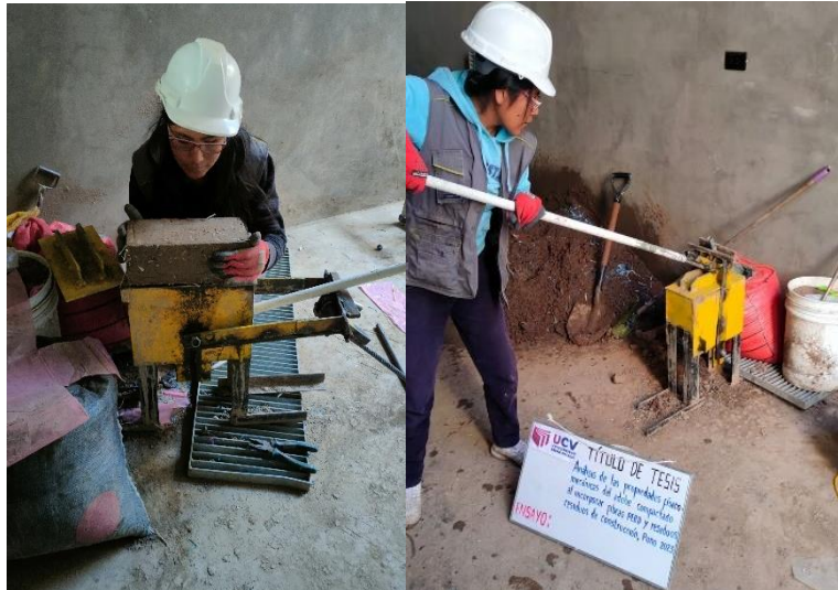
Figura 22. Producción de adobes comprimidos
