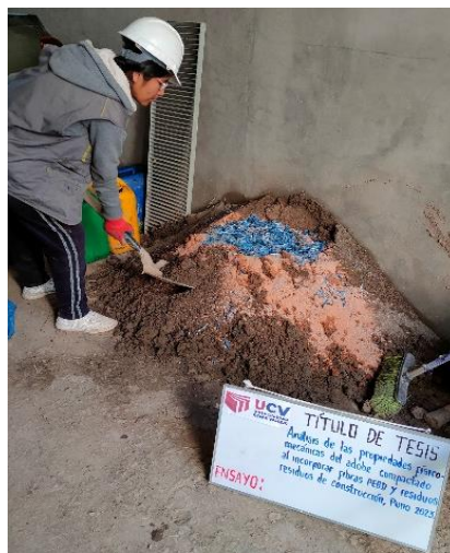
Figura 21. Mezclando las fibras 0.5%PEBD + 15%RRC
