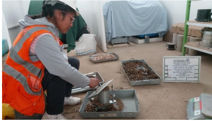
Figura 18. Realizando el ensayo Proctor
