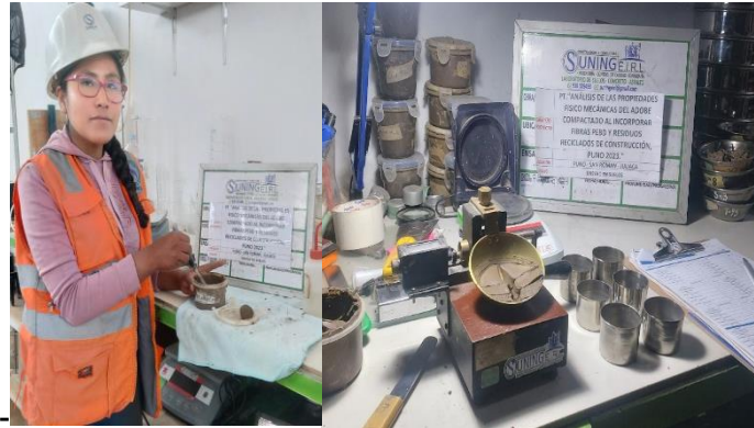
Figura 17. Realizando los Limites de Atterberg
