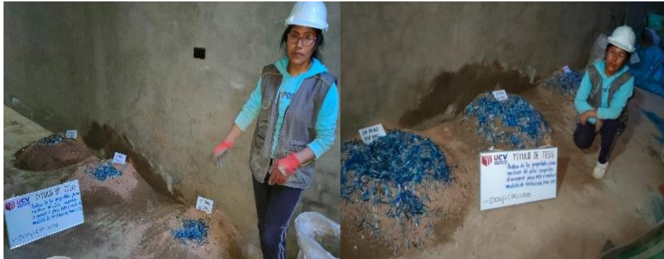
Figura 20. Dosificando el suelo + fibras PEBD + agregados RRC
