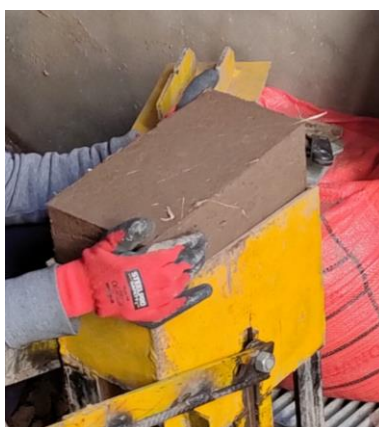
Figura 2. Adobe ya prensado por CINVA RAM.
