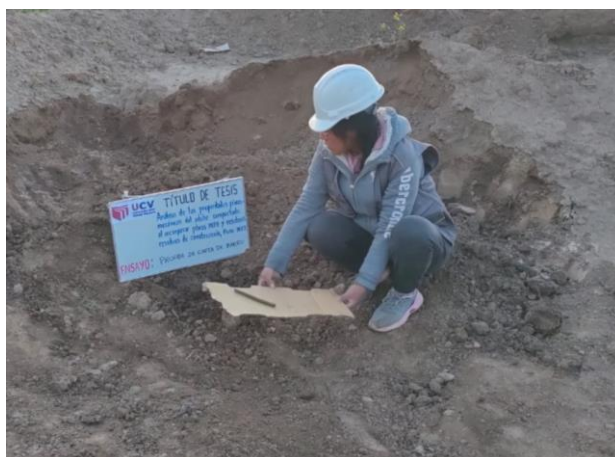
Figura 13. Realizando rollo de barro en el mismo lugar
