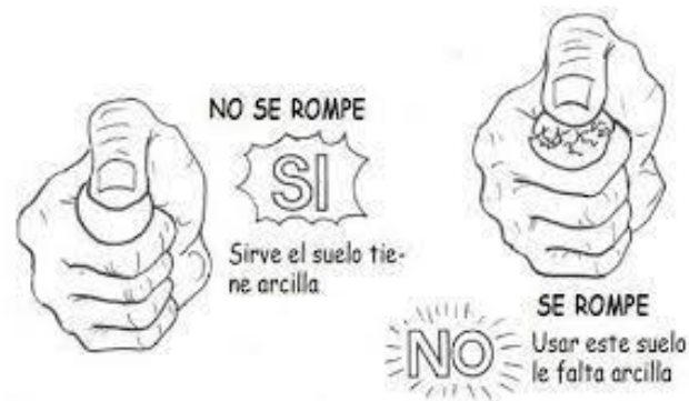
Figura 6. Prueba de resistencia seca
