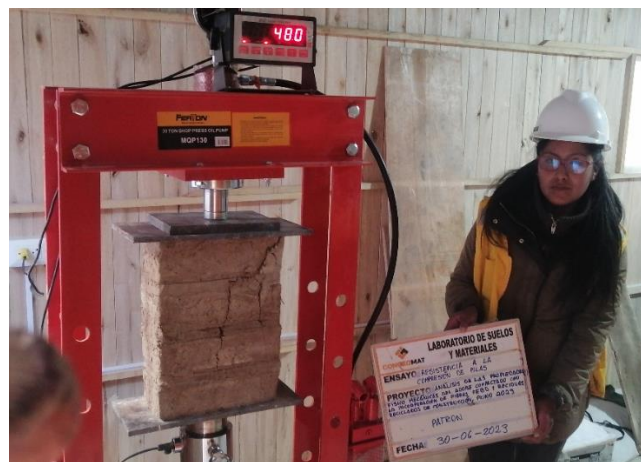
Figura 29. Efectuando la prueba de resistencia en prismas
