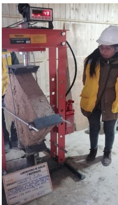
Figura 41. Realizando la prueba de tracción diagonal en muros
