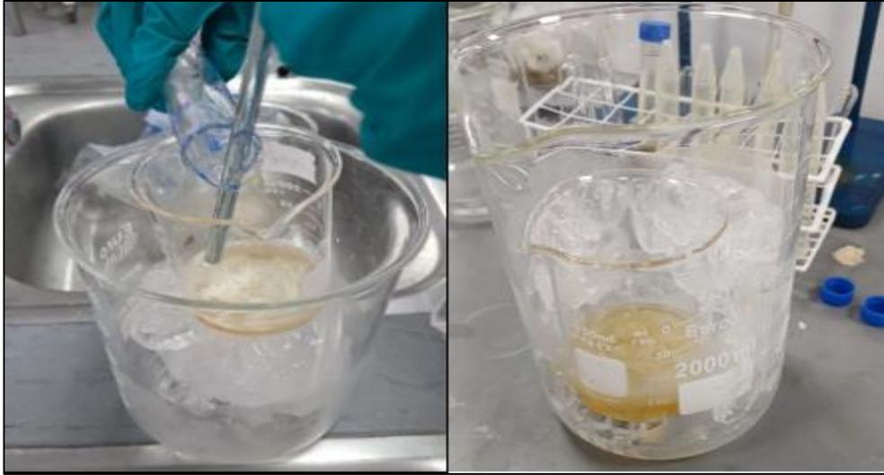
**Figura 15.** Separación del polihidroxi butirato y el cloroformo mediante el metanol.
