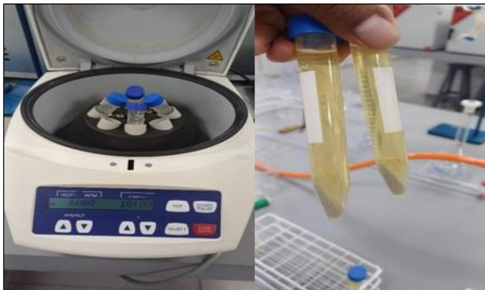
**Figura 12.** Centrifugación y obtención de fase orgánica.
