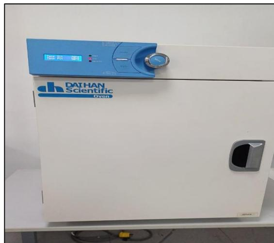
**Figura 22.** Secado del bioplástico en la estufa de la Universidad Cesar Vallejo.
