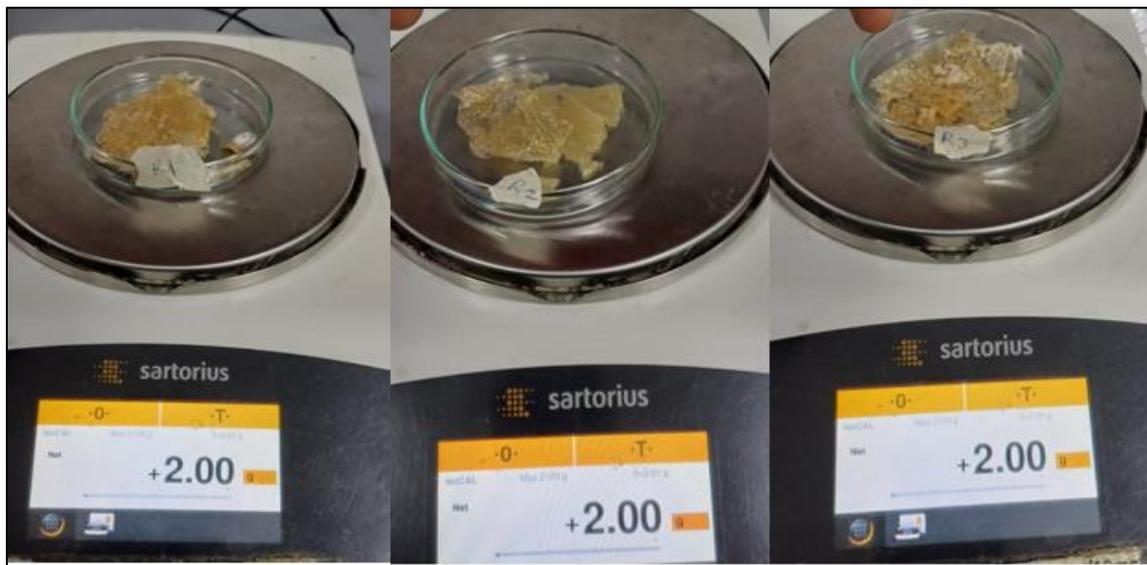
**Figura 24.** Pesaje de piezas de bioplástico para biodegradación.
