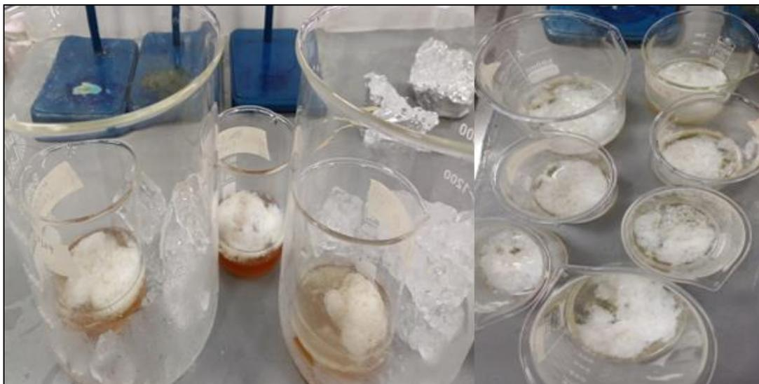
**Figura 16.** Separación del polihidroxi butirato.
