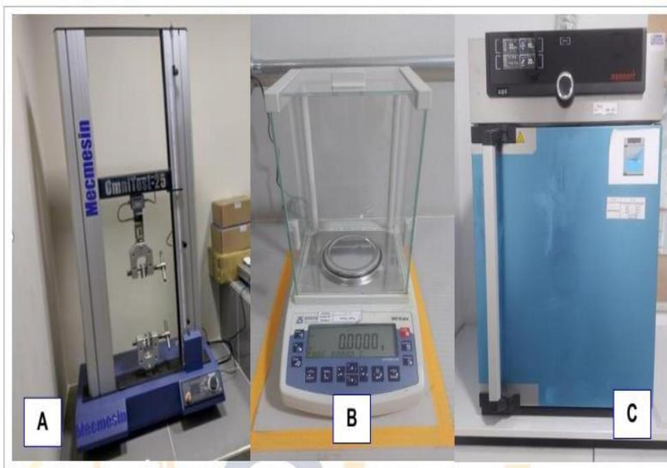
Figura N°1: EQUIPOS USADOS: A- EQUIPO DE TRACCIÓN UNIVERSAL; B- BALANZA ANALÍTICA; C- ESTUFA DE LABORATORIO
