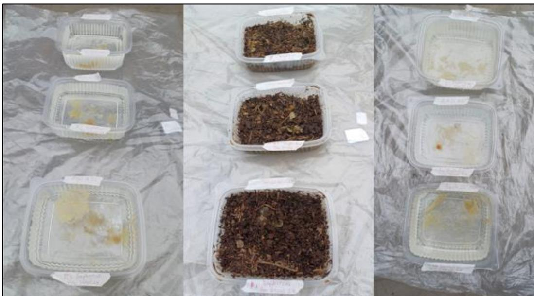
**Figura 25.** Recipientes con agua de río, suelo agrícola y agua de mar con muestras de bioplásticos introducidas para su biodegradación.
