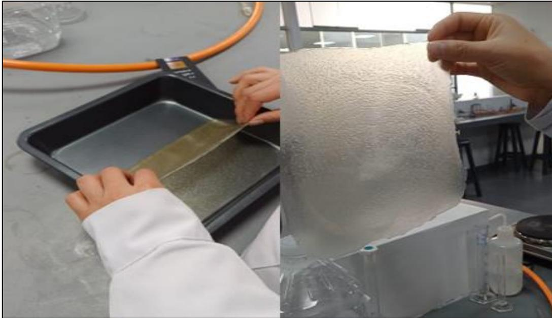
**Figura 23.** Obtención del bioplástico.
