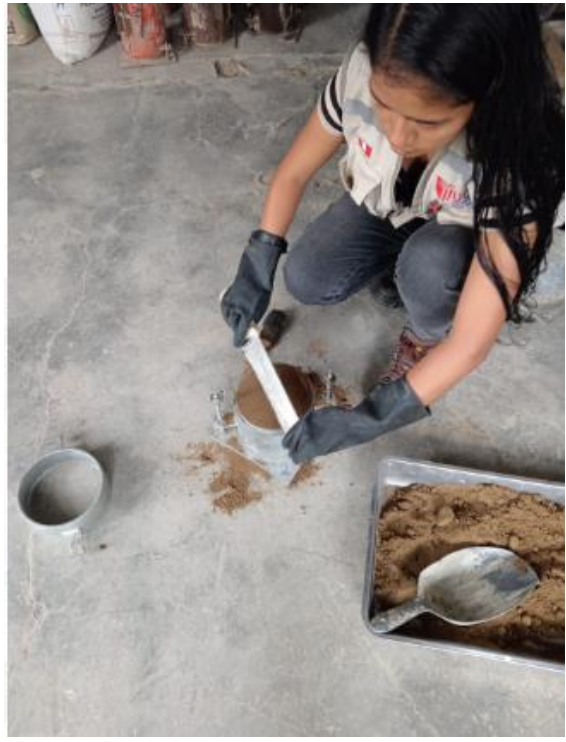
Figura 40 Ensayo de Proctor Modificado con muestra patrón sin CPA.
