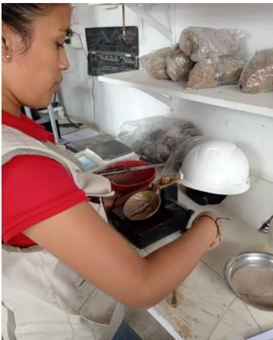
Figura 37 Utilización de copa de Casagrande y toma de muestras de ensayo.
