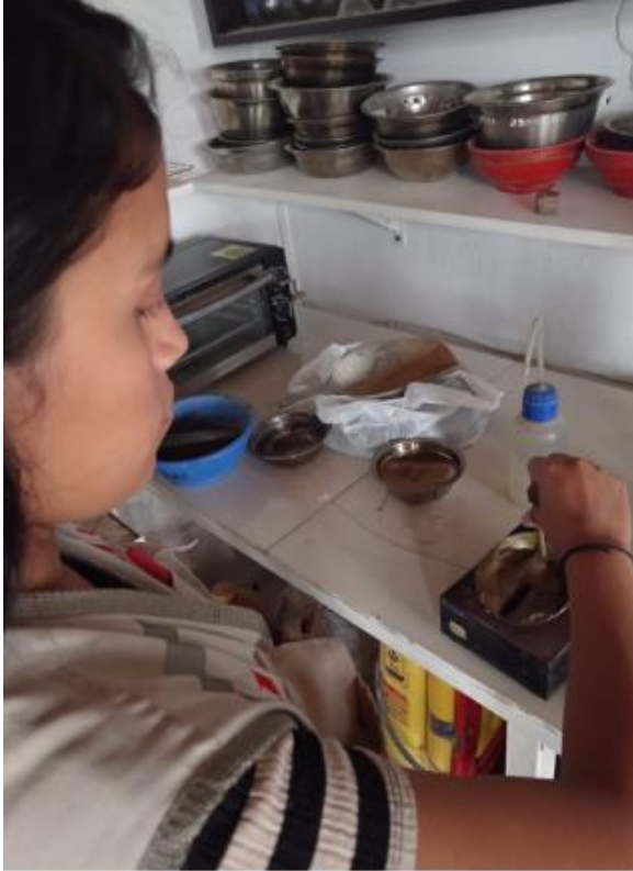
Figura 50 Utilización de copa de Casagrande con CPA + MUESTRA PATRON
