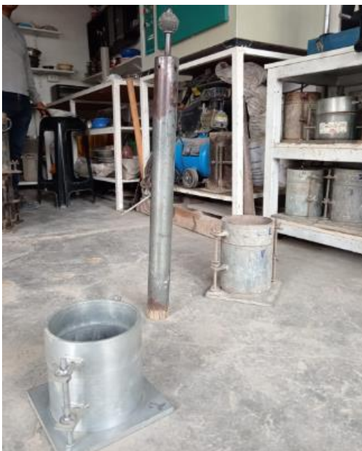
Figura 39 Equipos y material para ensayo de Proctor Modificado con muestra de suelo natural
