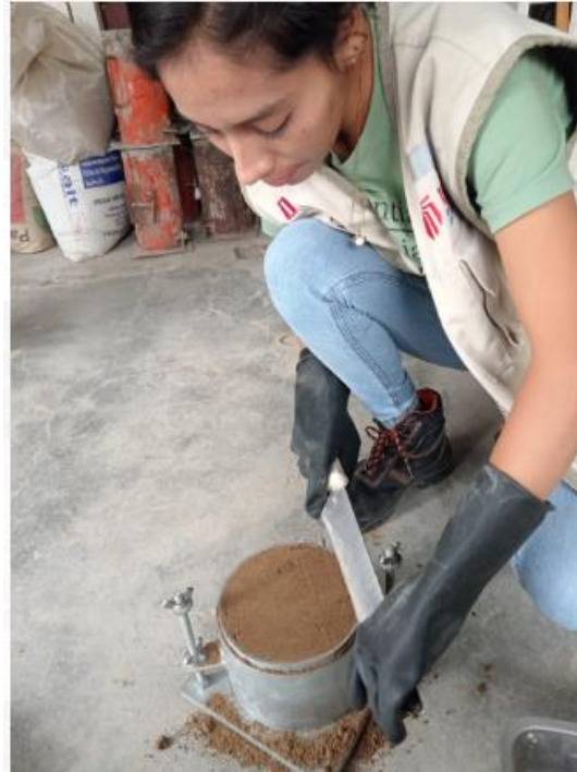
Figura 52 Ensayo de Proctor Modificado con Mezcla de CPA + Muestra Patrón
