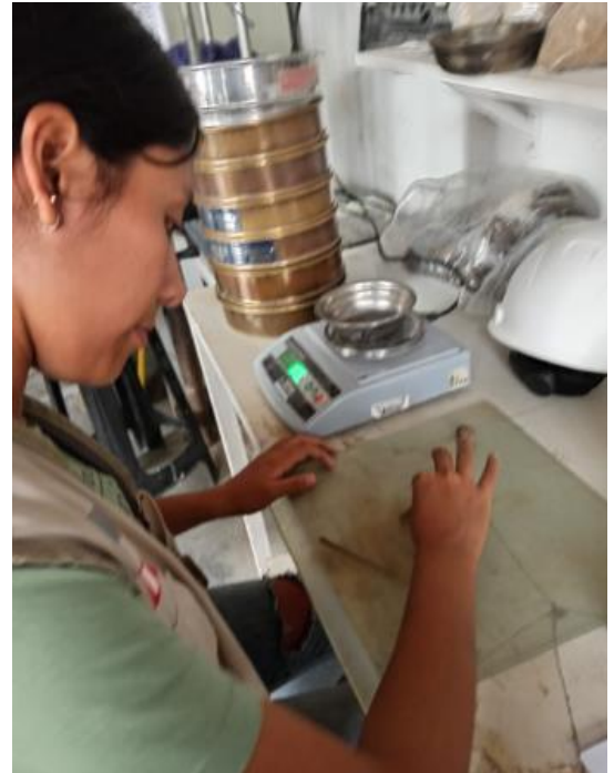
Figura 38 Toma de muestras de ensayo de límite plástico del suelo natural.
