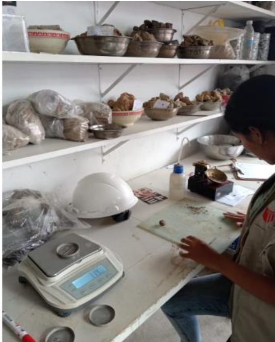
Figura 38 Toma de muestras de ensayo de límite plástico del suelo natural.
