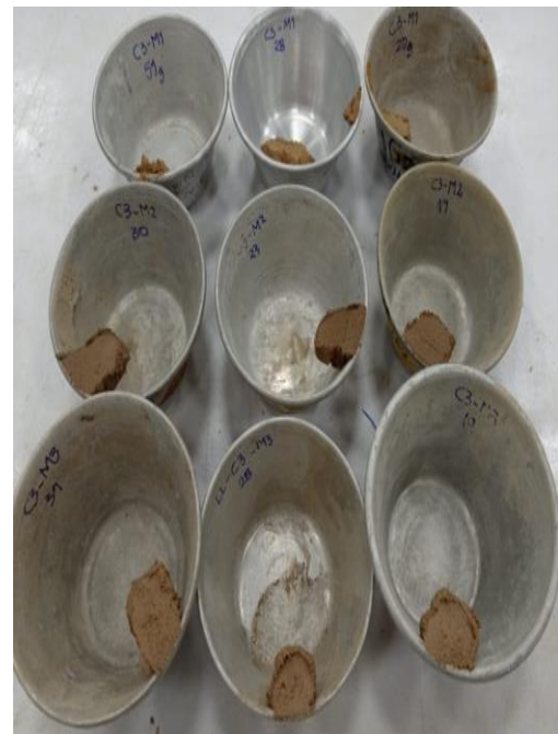
Figura 37 Utilización de copa de Casagrande y toma de muestras de ensayo.
