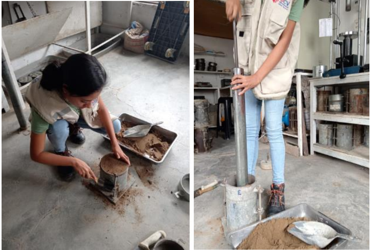
Figura 54 Ensayo de CBR con Mezcla CPA + Muestra Patrón para CBR
