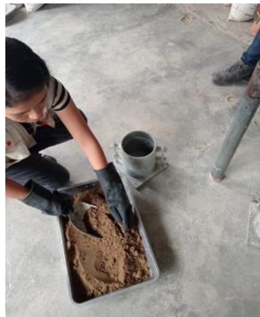
Figura 39 Equipos y material para ensayo de Proctor Modificado con muestra de suelo natural
