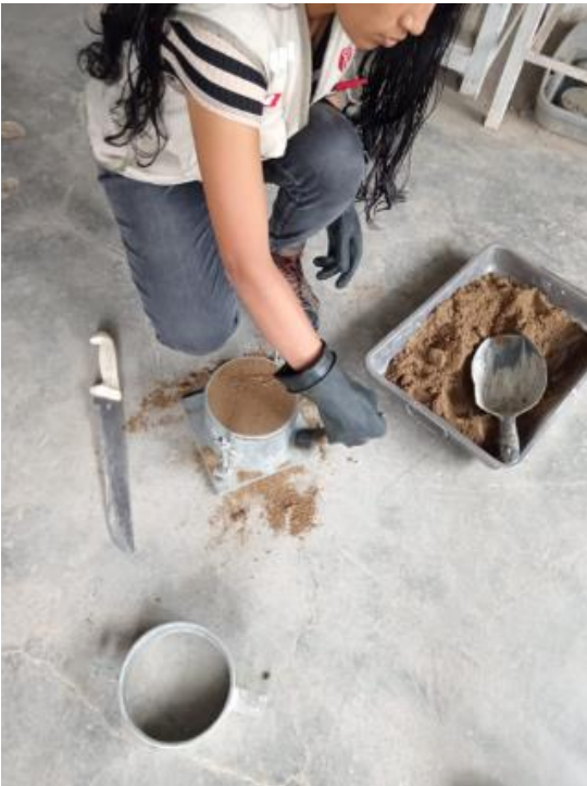
Figura 41 Enrasado y medición de peso durante el ensayo de Proctor Modificado
