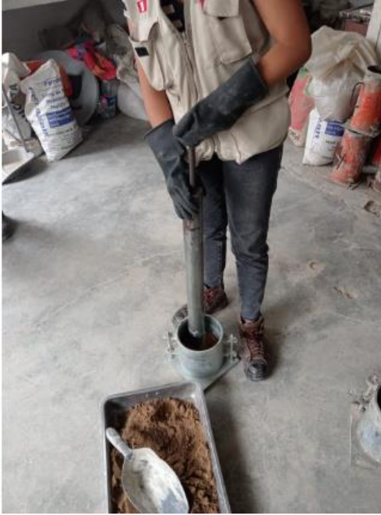
Figura 40 Ensayo de Proctor Modificado con muestra patrón sin CPA.
