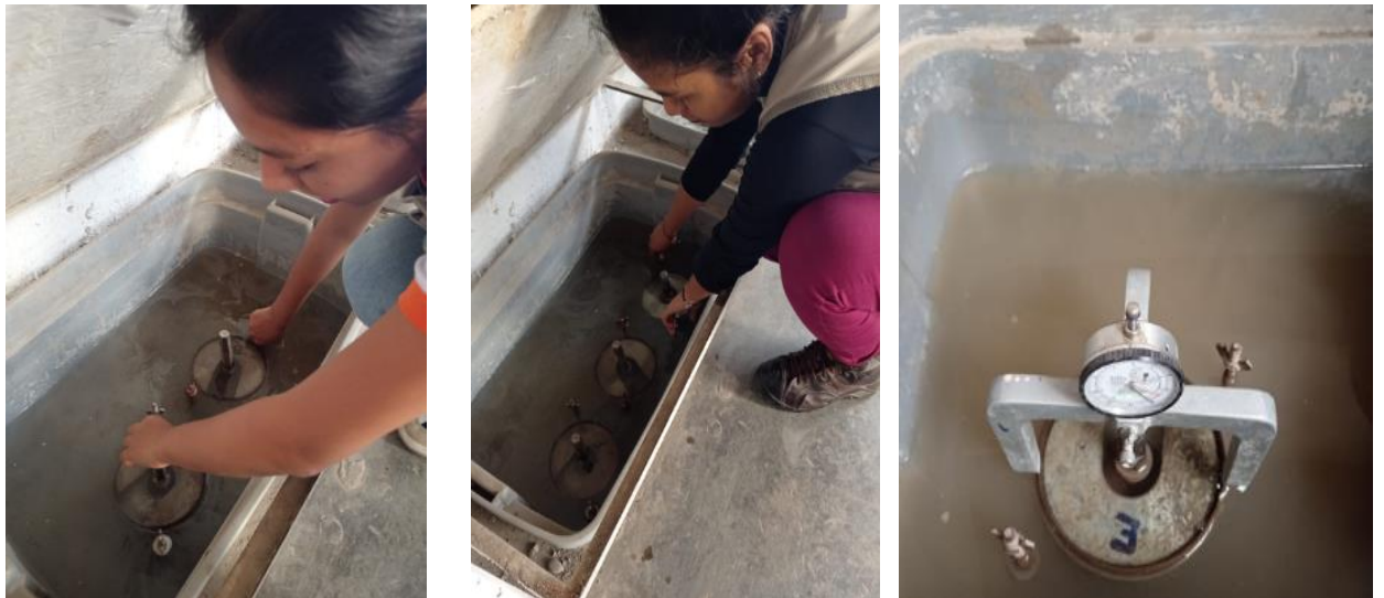
Figura 55 Ensayo de Expansión de Muestra Natural y con porcentajes de adición de CPA
