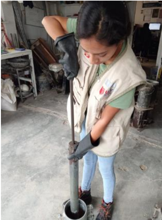
Figura 52 Ensayo de Proctor Modificado con Mezcla de CPA + Muestra Patrón
