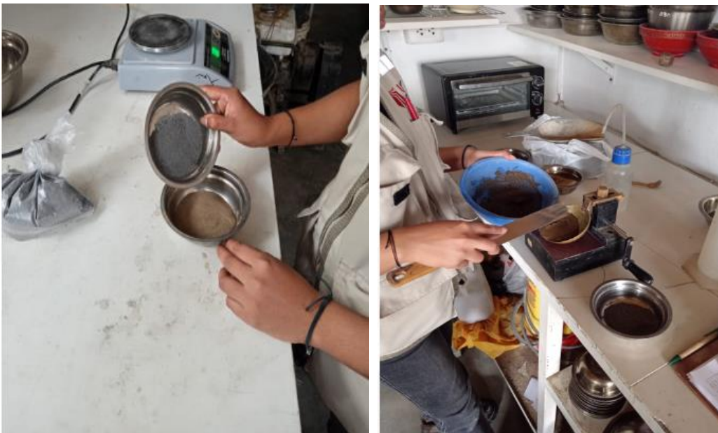
Figura 49 Mezcla de CPA + Muestra Patrón para Ensayo de Límite Líquido
