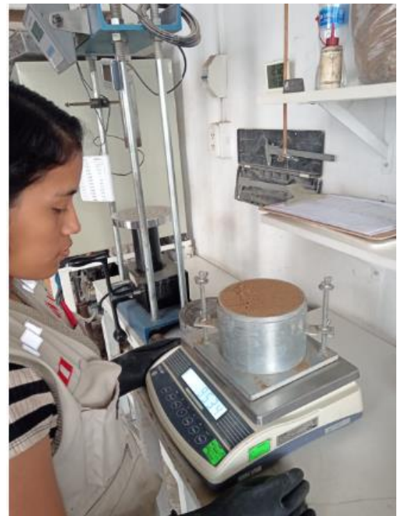
Figura 41 Enrasado y medición de peso durante el ensayo de Proctor Modificado
