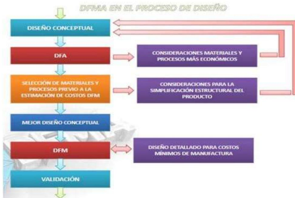
**Figura 2:** DFMA en el proceso de diseño.
