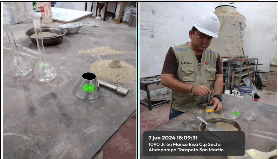
Fotos n° 15-16: En las imágenes podemos observar el ensayo de gravedad específica.
