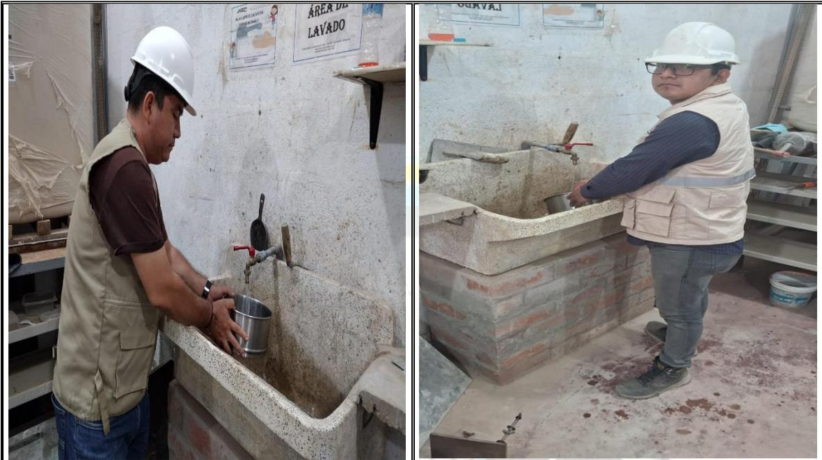
Fotos n° 17-18: En las imágenes se puede apreciar el ensayo de lavado del agregado.
