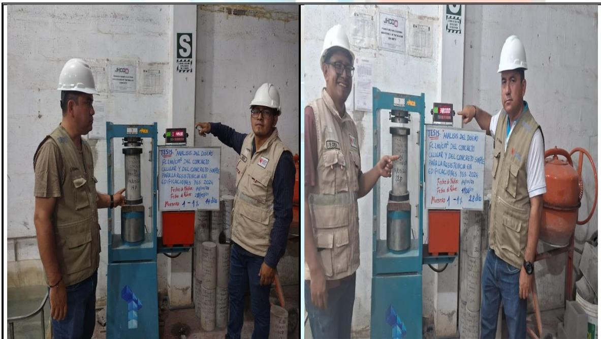
Fotos nº 25-26: En las imágenes podemos observar la resistencia a la compresión axial de los testigos de concreto
