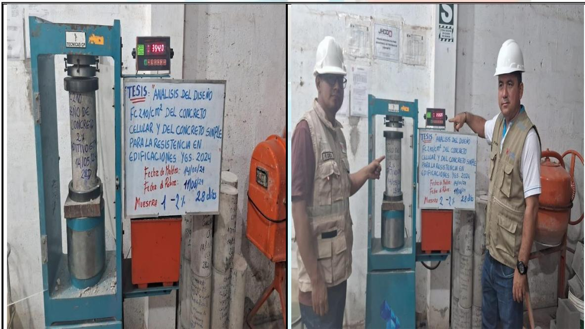
Fotos n° 33-34: En las imágenes podemos observar la resistencia a la compresión axial de los testigos de concreto
