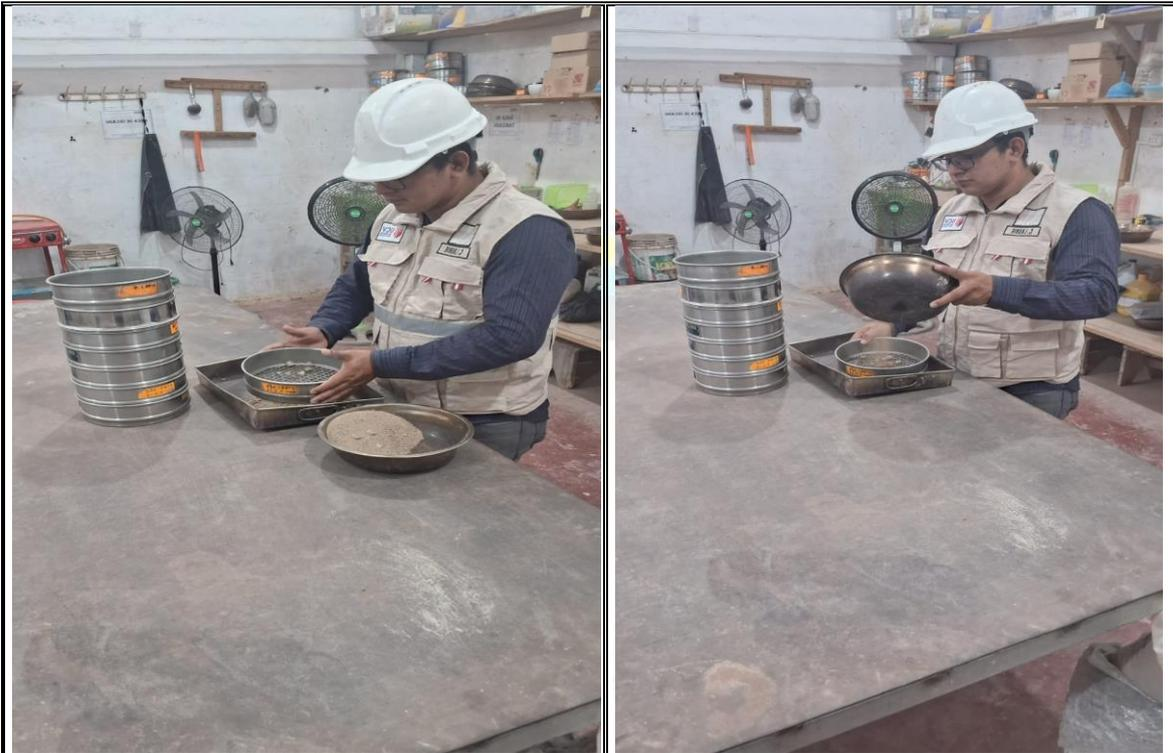
Fotos n° 09-10: En las imágenes se puede apreciar el ensayo de análisis granulométricos.
