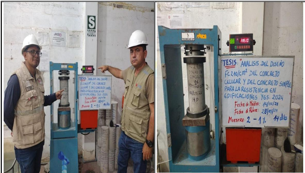
Fotos nº 23-24: En las imágenes podemos observar la resistencia a la compresión axial de los testigos de concreto
