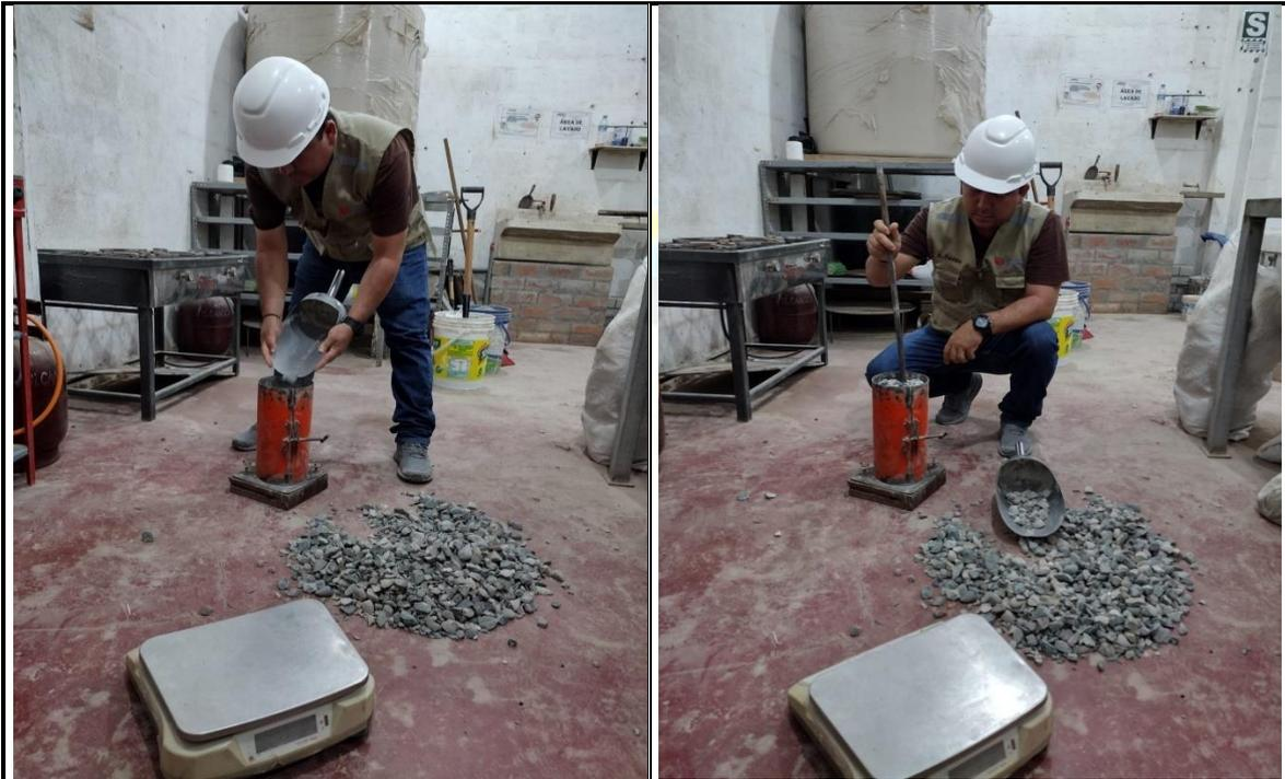
Fotos n° 13-14: En las imágenes podemos observar realización del ensayo de peso unitario de la grava.
