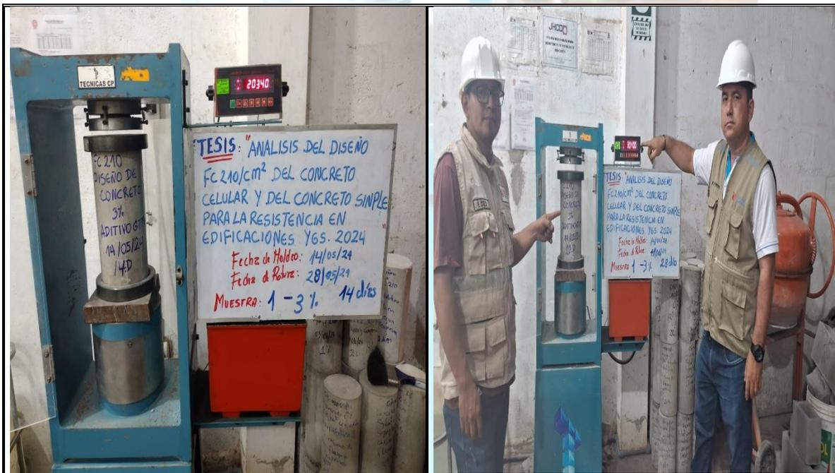
Fotos nº 37-38: En las imágenes podemos observar la resistencia a la compresión axial de los testigos de concreto
