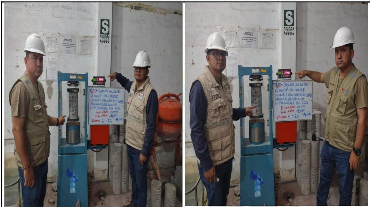
Fotos nº 27-28: En las imágenes podemos observar la resistencia a la compresión axial de los testigos de concreto
