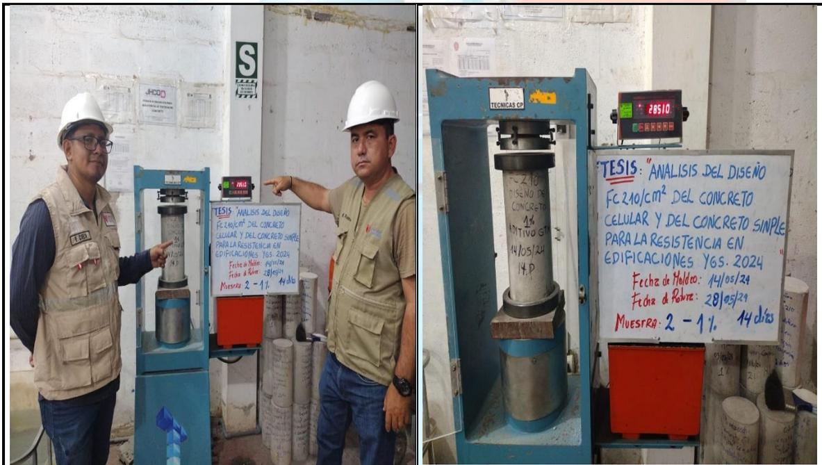
Fotos nº 29-30: En las imágenes podemos observar la resistencia a la compresión axial de los testigos de concreto
