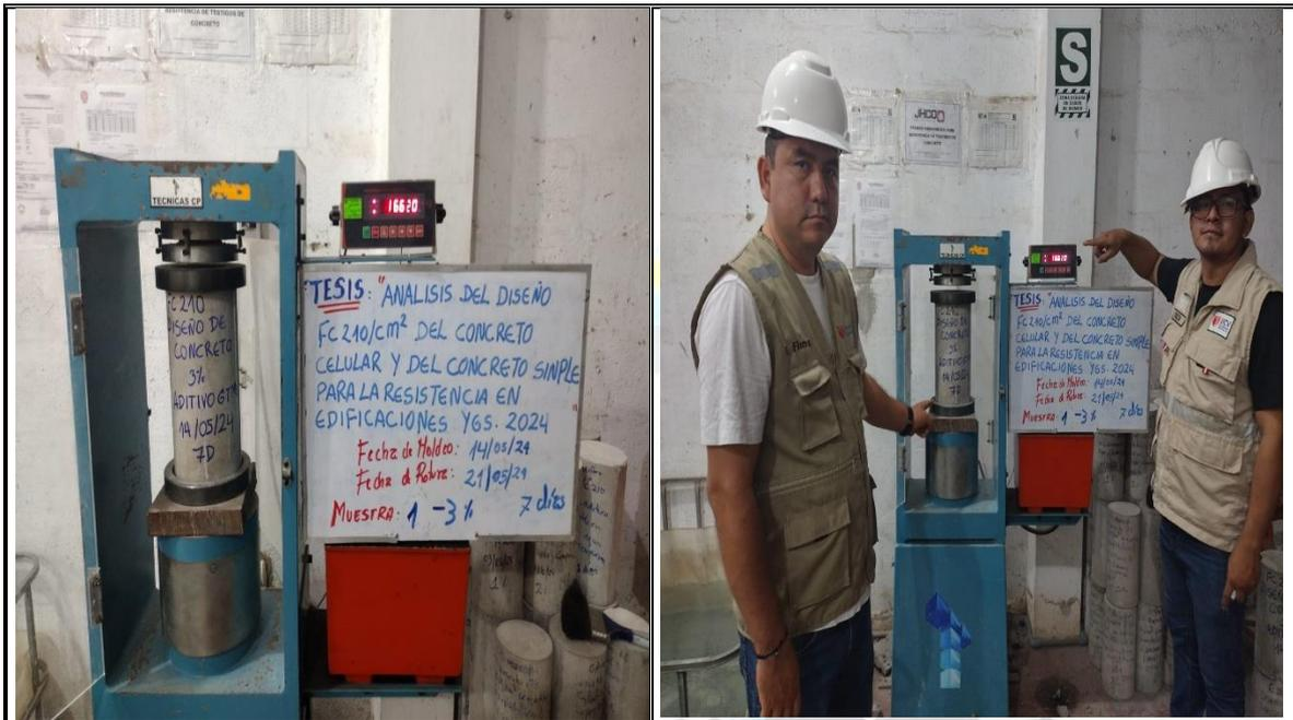
Fotos nº 35-36: En las imágenes podemos observar la resistencia a la compresión axial de los testigos de concreto
