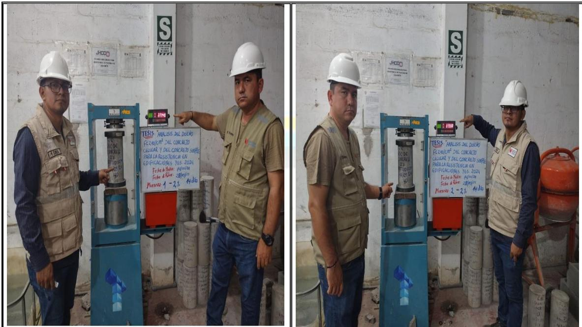
Fotos n° 31-32: En las imágenes podemos observar la resistencia a la compresión axial de los testigos de concreto
