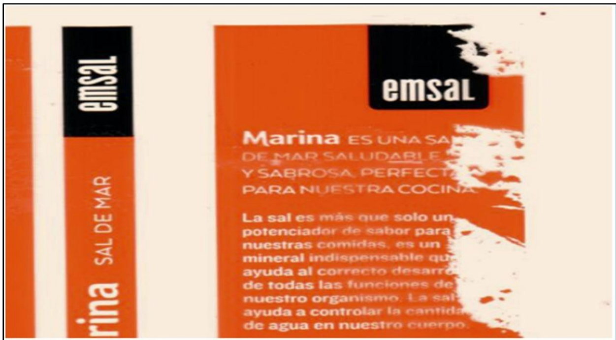
Figura 30. Materia prima defectuosa que refleja en la impresión.
