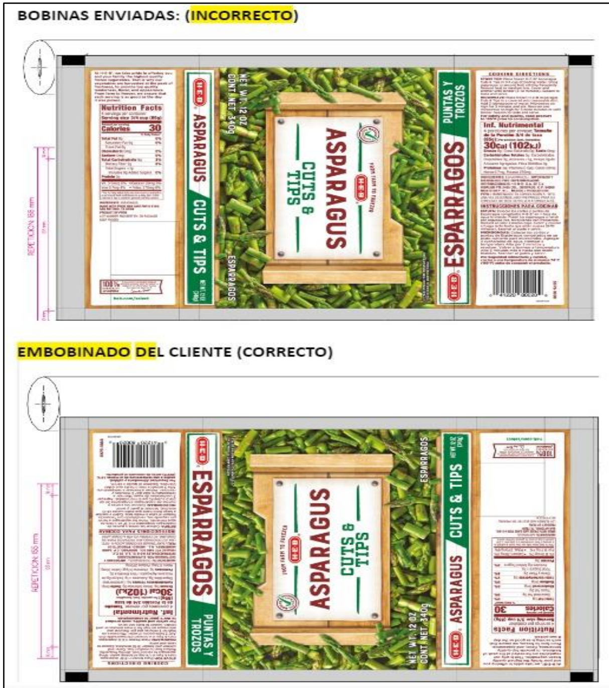
Figura 35. Diferencia de un embobinado correcto e incorrecto.
