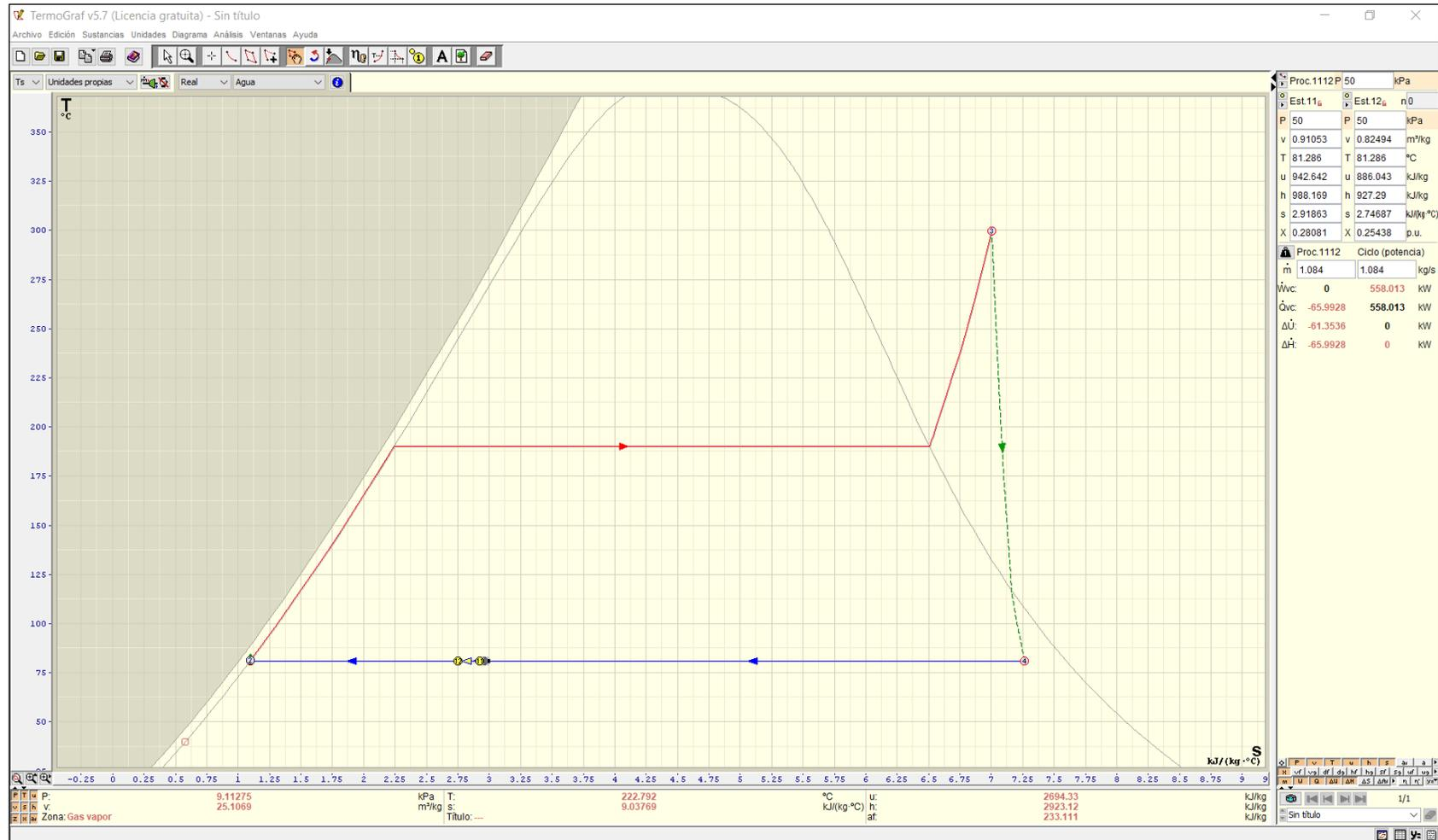
Figura 4. Diagrama termodinámico Temperatura vs Entropía (T-s) del sistema de trigeneración del centro de salud de Pósope Alto.
