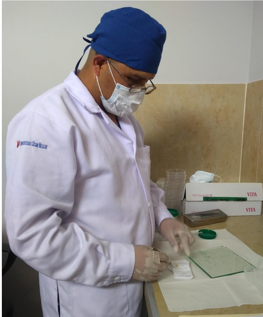
Tomando el color de los discos con el espectrofotómetro VITA Easyshade V.
