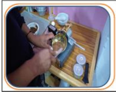
Foto: 13: Preparación de muestra para limite líquido
