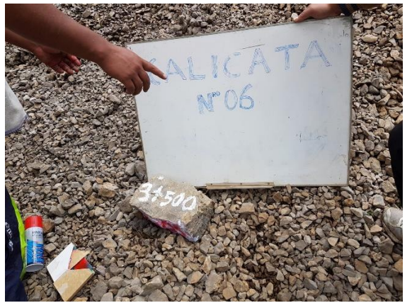
Figura 6: Toma de muestra de la calicata 6.
