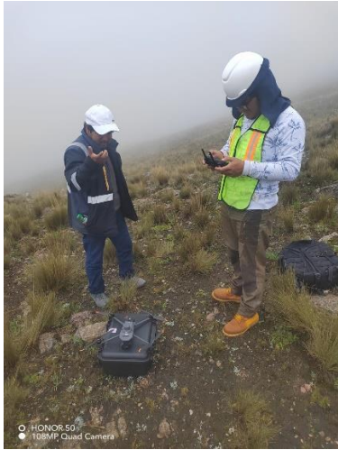
Figura 1: Configuración del dron para el levantamiento topográfico.
