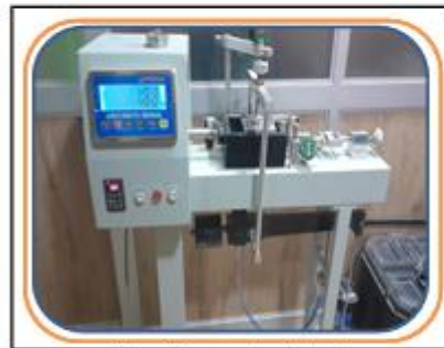
Foto: 16: Ensayo de corte directo
