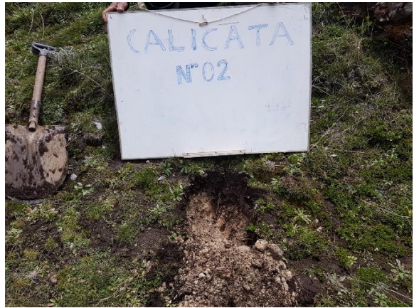
Figura 2: Toma de muestra de la calicata 2.
