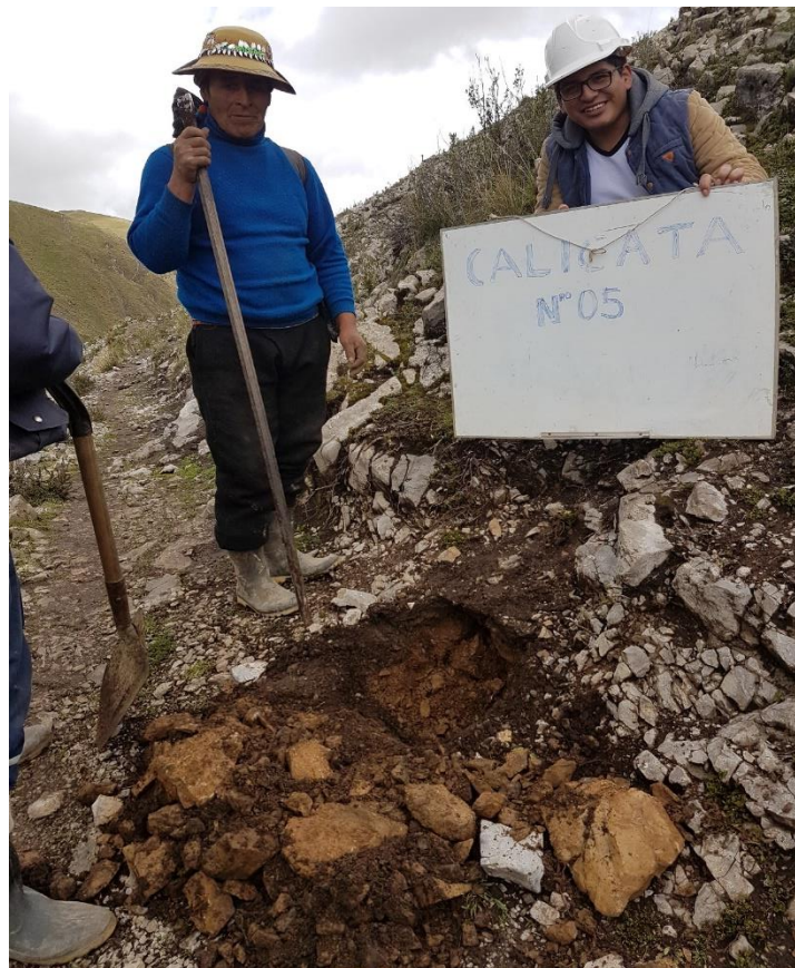
Figura 3: Excavación de calicatas para toma de muestras.
