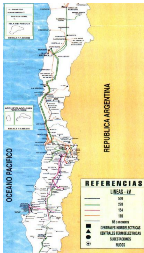
Figura 21 Sistema Electrico Chileno
