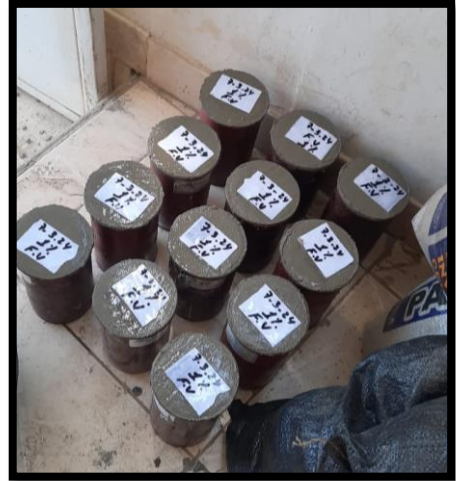
MUESTRAS DEL HORMIGÓN REFORZADO CON F.V.
