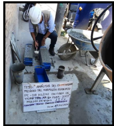
MOLDEO DE VIGAS CON F.V.
