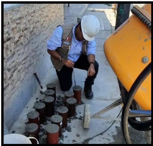
MOLDEO DE PROBETAS CON F.V.
