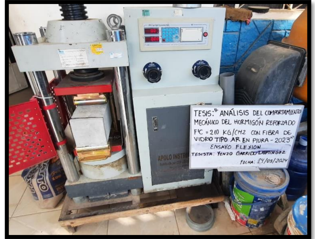
ENSAYO DE RESISTENCIA A LA FLEXIÓN
