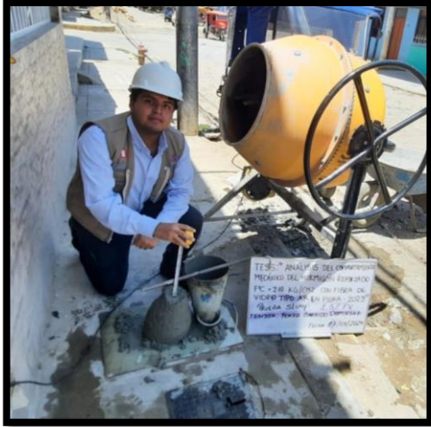
PRUEBA SLUMP DEL HORMIGÓN REFORZADO CON F.V.
