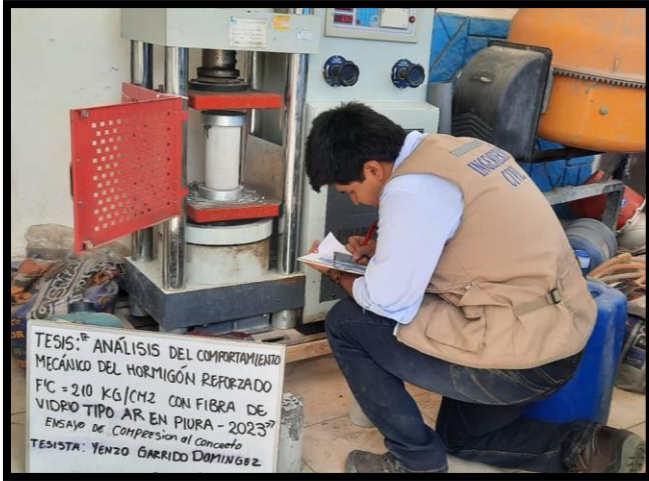
ENSAYO DE RESISTENCIA A LA COMPRESIÓN
