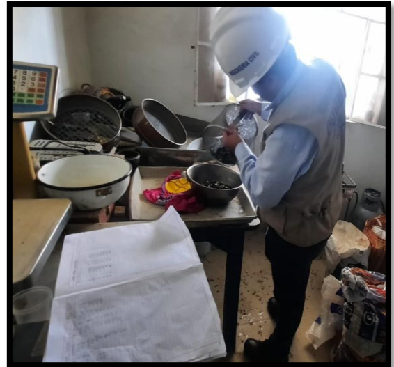
ENSAYO DE PESO UNITARIO EN LABORATORIO
