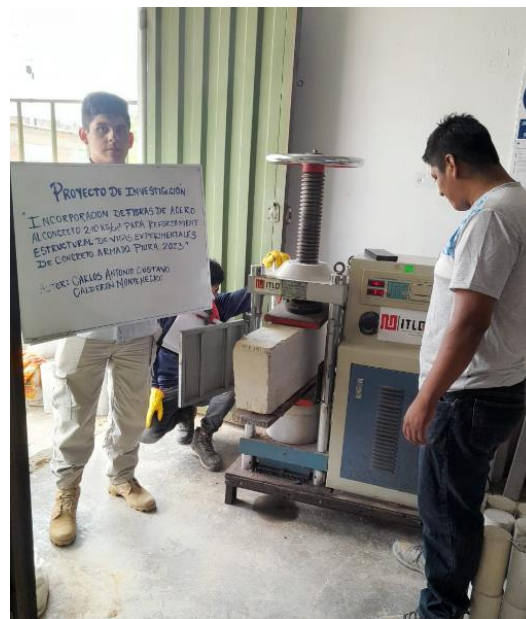
Figura N° 59. Elemento prismático colocado en prensa monotónica de carga estática.
