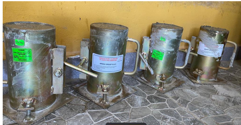
FIGURA N° 49. Toma de muestras para ser ensayados a compresión.
