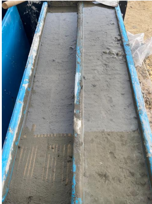
Figura N° 52. Elementos prismáticos posterior al encofrado.
