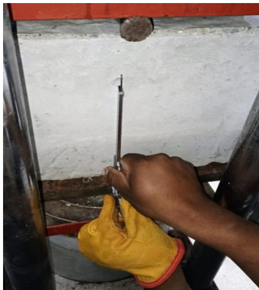
Figura N° 61. Toma de datos de la deflexión de la viga posterior al ensayo de laboratorio.
