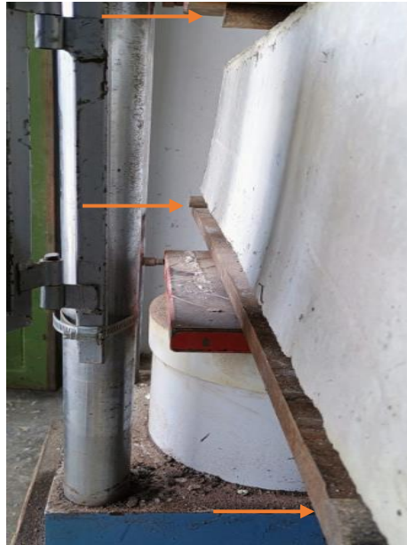
Figura N° 60. Visualización del elemento prismático apoyada en dos puntos con carga puntual al centro.
