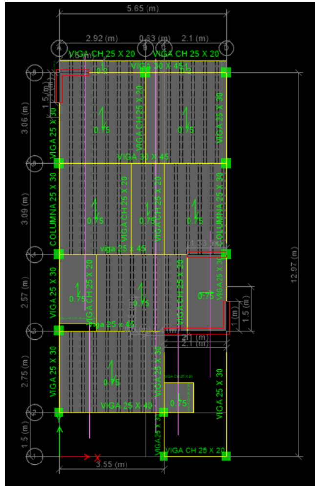
Figura N° 27. Incremento de carga viva a 750 kg/m 2 .
