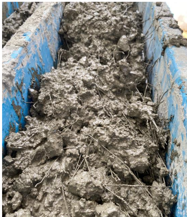
FIGURA N° 55. Vista frontal del concreto que incorpora dentro de sus componentes la fibra de acero.
