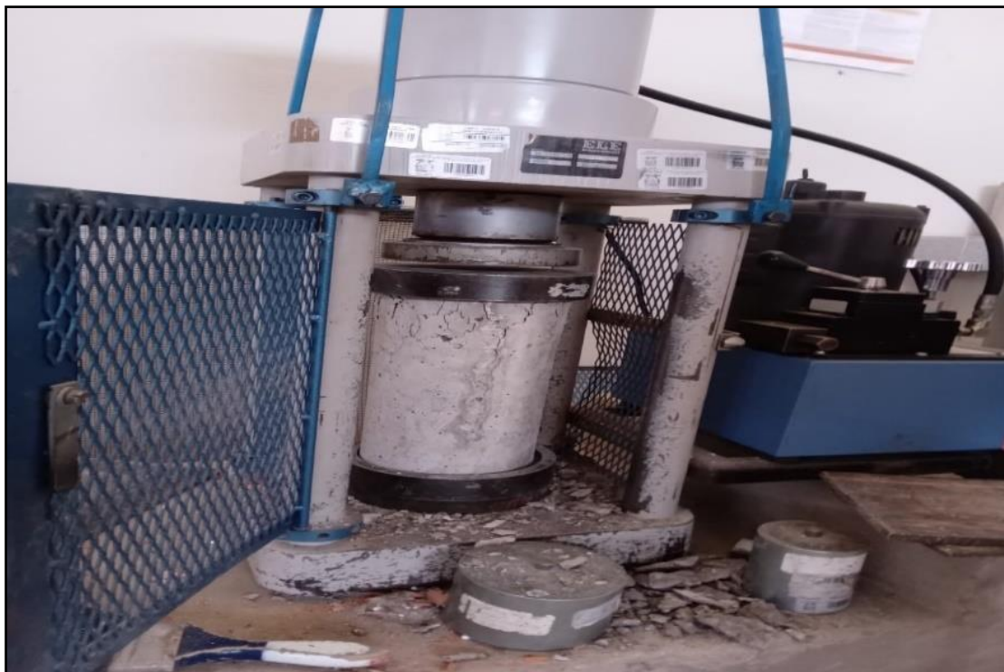
Rotura de testigos de compresión y tracción
