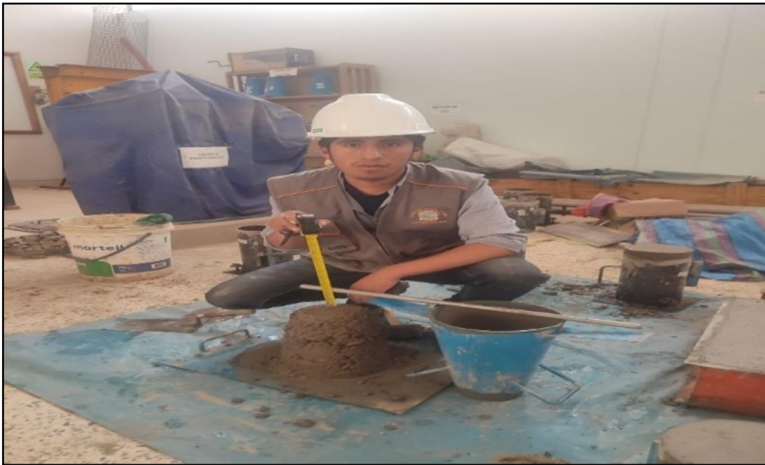
Prueba de Slump
