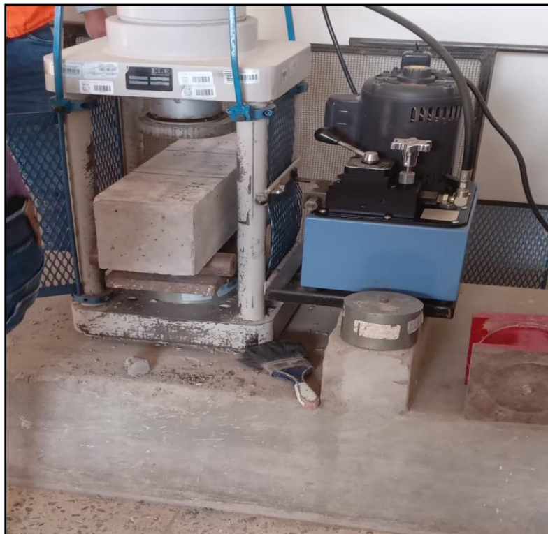
Figura 13 Rotura ensayo a flexión
