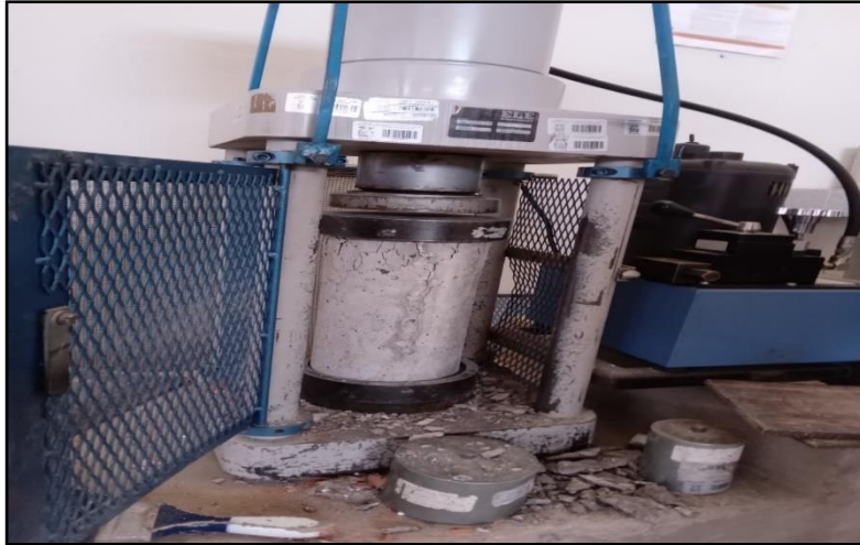
Figura 12. Rotura de testigos de compresión y tracción
