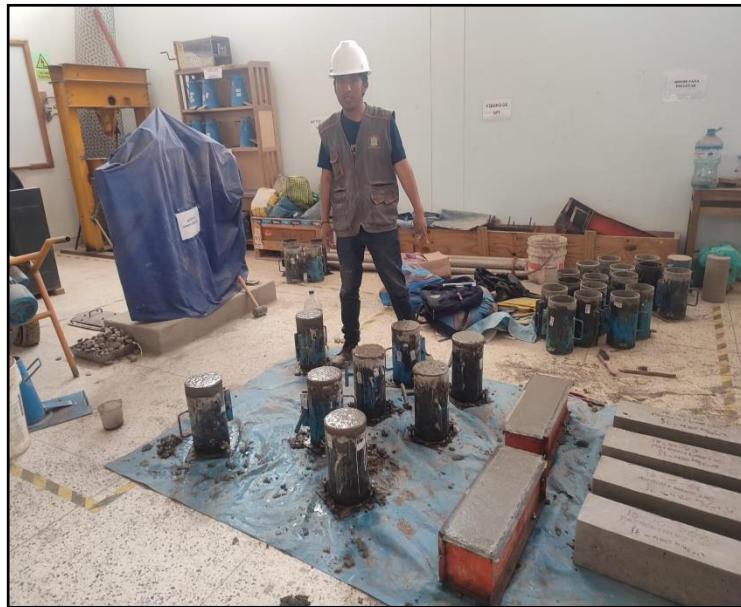
Figura 11. Elaboración de los testigos de concreto
