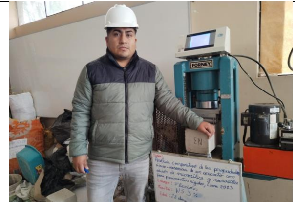
Se llevaron a cabo ensayos de flexión en especímenes de concreto con una adición de 3 % de nanosíllice. Los especímenes fueron curados durante 7, 14 y 28 días para evaluar el efecto del tiempo de curación en la resistencia a la flexión.
