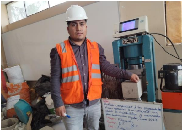
Se llevaron a cabo ensayos de flexión en especímenes de concreto con una adición de 3 % de nanosíllice. Los especímenes fueron curados durante 7, 14 y 28 días para evaluar el efecto del tiempo de curación en la resistencia a la flexión.
