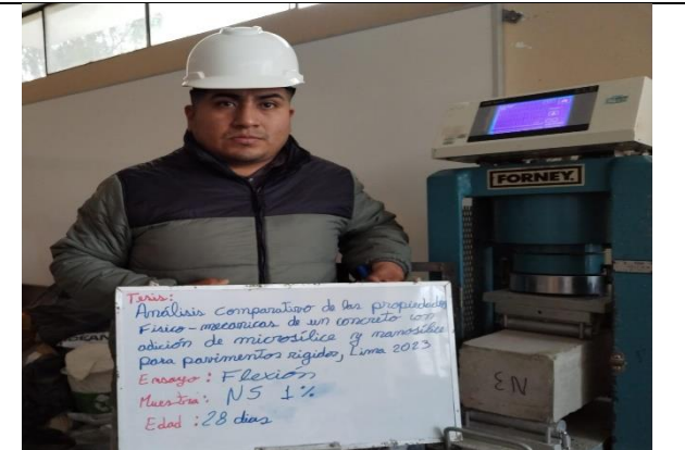
Se llevaron a cabo ensayos de flexión en especímenes de concreto con una adición de 1 % de nanosíllica. Los especímenes fueron curados durante 7, 14 y 28 días para evaluar el efecto del tiempo de curación en la resistencia a la flexión.
