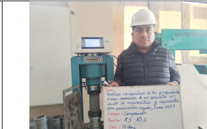
Se realizaron ensayos de compresión en especímenes de concreto con adición de 10 % de microsilice. Los especímenes fueron curados durante 7, 14 y 28 días para evaluar la evolución de la resistencia a la compresión con el tiempo.
