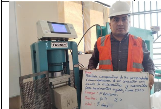
Se llevaron a cabo ensayos de flexión en especímenes de concreto con una adición de 2 % de nanosíllica. Los especímenes fueron curados durante 7, 14 y 28 días para evaluar el efecto del tiempo de curación en la resistencia a la flexión.
