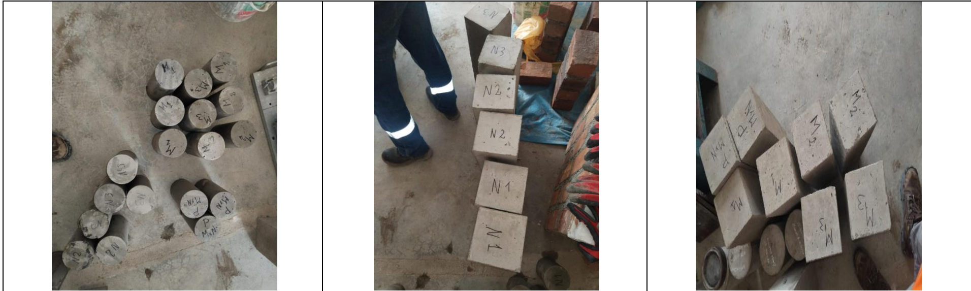
Las probetas cilíndricas, con dimensiones de 4x8 pulgadas, se utilizan para medir la resistencia a la compresión del concreto. Por otro lado, las vigas de concreto, de 15x15x50 cm, sirven para evaluar la resistencia y el comportamiento estructural del concreto bajo carga.
