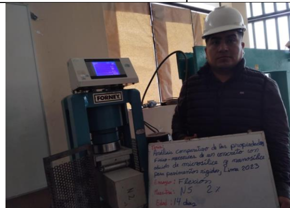
Se llevaron a cabo ensayos de flexión en especímenes de concreto con una adición de 2 % de nanosíllica. Los especímenes fueron curados durante 7, 14 y 28 días para evaluar el efecto del tiempo de curación en la resistencia a la flexión.
