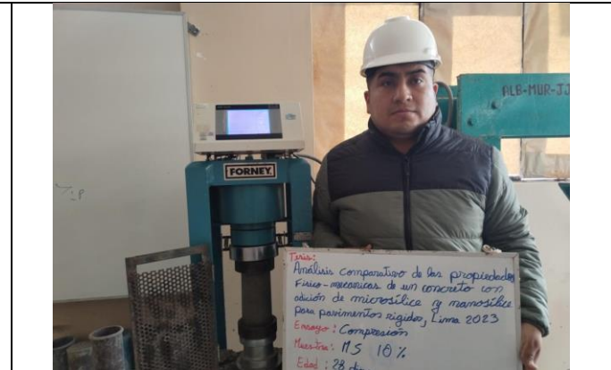
Se realizaron ensayos de compresión en especímenes de concreto con adición de 10 % de microsilice. Los especímenes fueron curados durante 7, 14 y 28 días para evaluar la evolución de la resistencia a la compresión con el tiempo.
