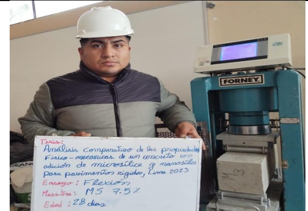
Se llevaron a cabo ensayos de flexión en especímenes de concreto con una adición de 7.5 % de microsíllice. Los especímenes fueron curados durante 7, 14 y 28 días para evaluar el efecto del tiempo de curación en la resistencia a la flexión.
