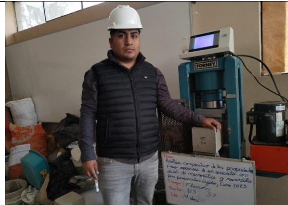
Se llevaron a cabo ensayos de flexión en especímenes de concreto con una adición de 3 % de nanosíllice. Los especímenes fueron curados durante 7, 14 y 28 días para evaluar el efecto del tiempo de curación en la resistencia a la flexión.
