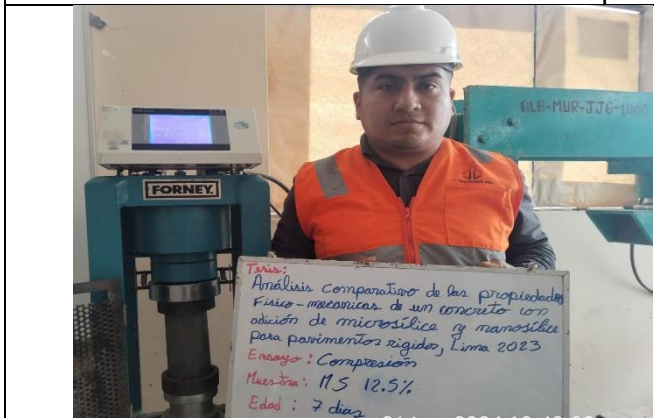
Se realizaron ensayos de compresión en especímenes de concreto con adición de 12.5 % de microsilice. Los especímenes fueron curados durante 7, 14 y 28 días para evaluar la evolución de la resistencia a la compresión con el tiempo.
