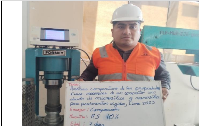
Se realizaron ensayos de compresión en especímenes de concreto con adición de 10 % de microsilice. Los especímenes fueron curados durante 7, 14 y 28 días para evaluar la evolución de la resistencia a la compresión con el tiempo.
