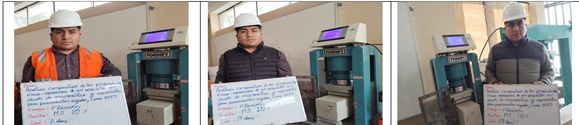
Se llevaron a cabo ensayos de flexión en especímenes de concreto con una adición de 10 % de microsilice. Los especímenes fueron curados durante 7, 14 y 28 días para evaluar el efecto del tiempo de curación en la resistencia a la flexión.
