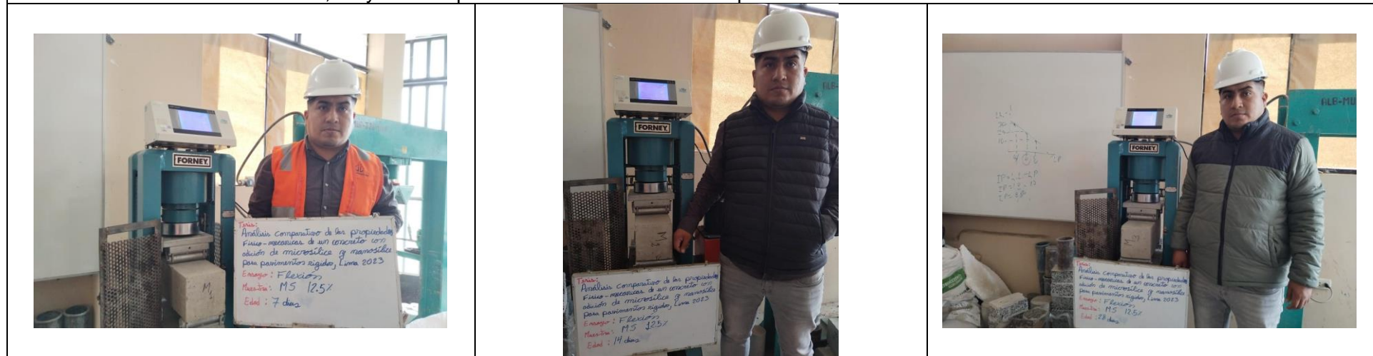
Se llevaron a cabo ensayos de flexión en especímenes de concreto con una adición de 12.5 % de microsilice. Los especímenes fueron curados durante 7, 14 y 28 días para evaluar el efecto del tiempo de curación en la resistencia a la flexión.
