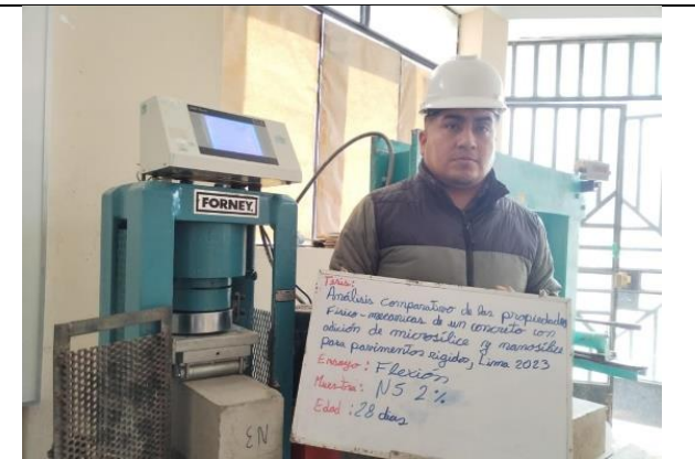
Se llevaron a cabo ensayos de flexión en especímenes de concreto con una adición de 2 % de nanosíllica. Los especímenes fueron curados durante 7, 14 y 28 días para evaluar el efecto del tiempo de curación en la resistencia a la flexión.
