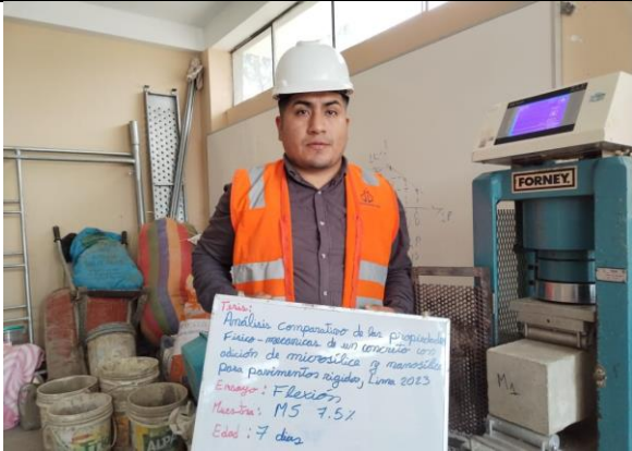
Se llevaron a cabo ensayos de flexión en especímenes de concreto con una adición de 7.5 % de microsíllice. Los especímenes fueron curados durante 7, 14 y 28 días para evaluar el efecto del tiempo de curación en la resistencia a la flexión.
