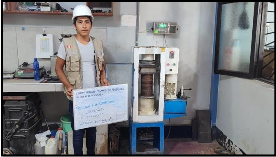
Foto N° 19: Se realizó el ensayo de resistencia a la compresión de los adoquines elaborados a los 7 Días de curado.
