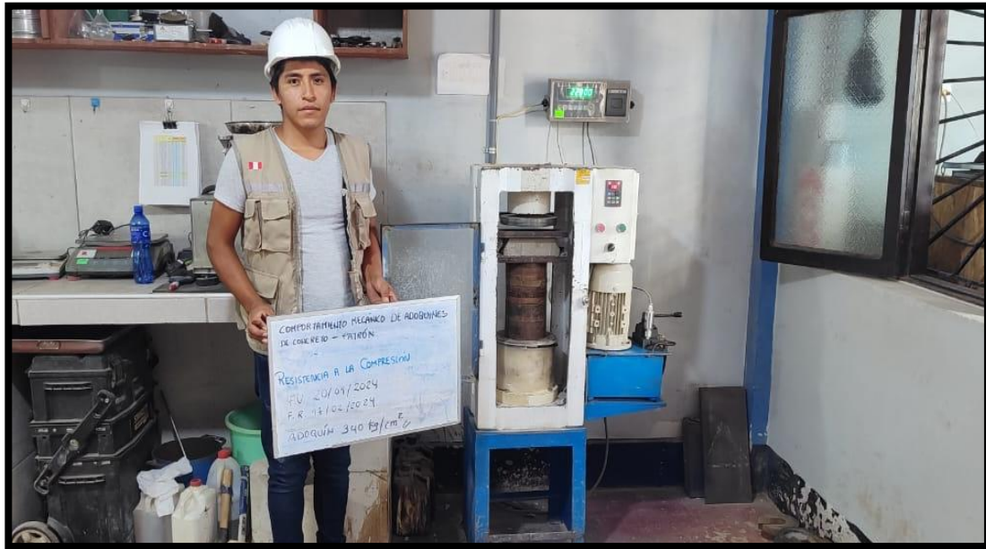
Foto N° 21: Se observa la rotura de los adoquines realizados y curados a los 28 días llegando a su máxima resistencia.
