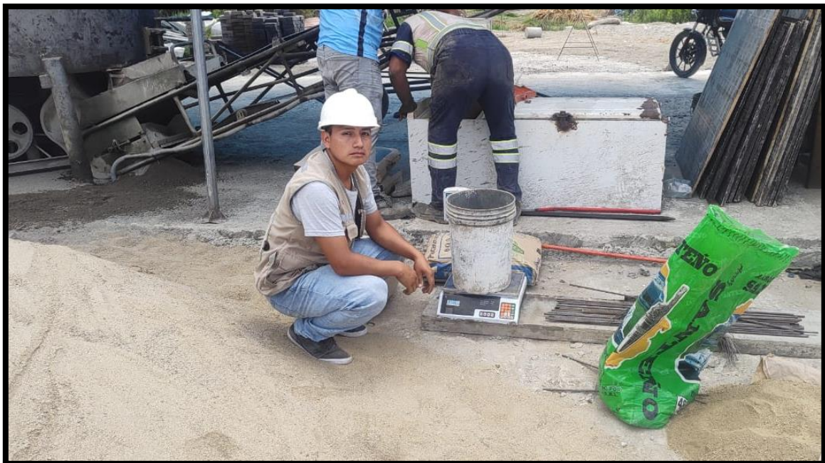
Foto N° 10: Para el proceso de medición de cada material se utilizó una balanza eléctrica de 30 kg y un balde de 20 litros.
