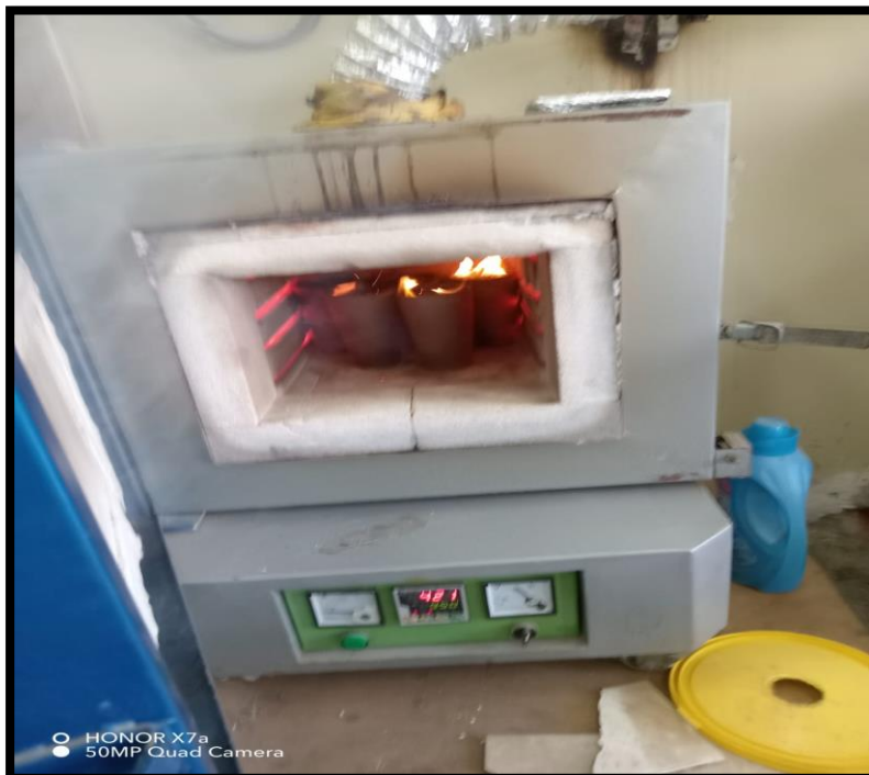
Foto N° 06: Calcinación de la Ceniza de Carbón y el Tagelus Dombeyi para poder agregar a nuestro diseño.
