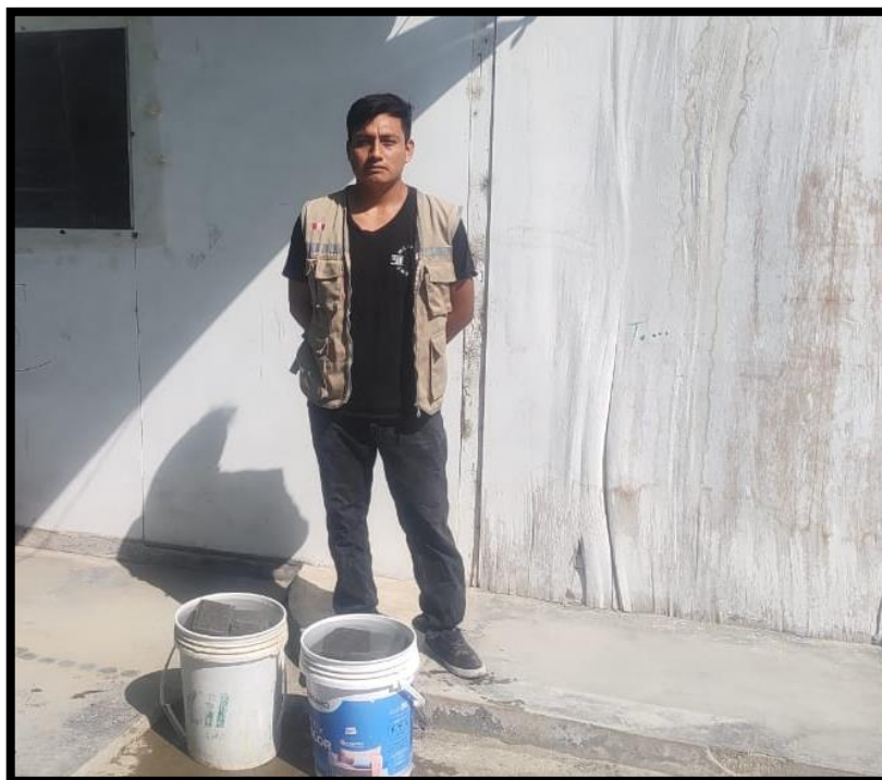
Foto N° 18: Como se puede visualizar se realizó el proceso de curado de las muestras elaboradas por 28 días.
