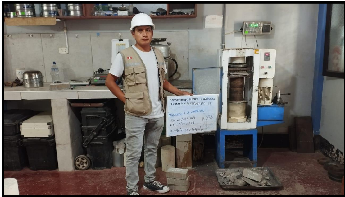
Foto N° 20: Se realizó el ensayo de Resistencia a la Compresión de la muestra experimental 01 a los 14 Días de curado.
