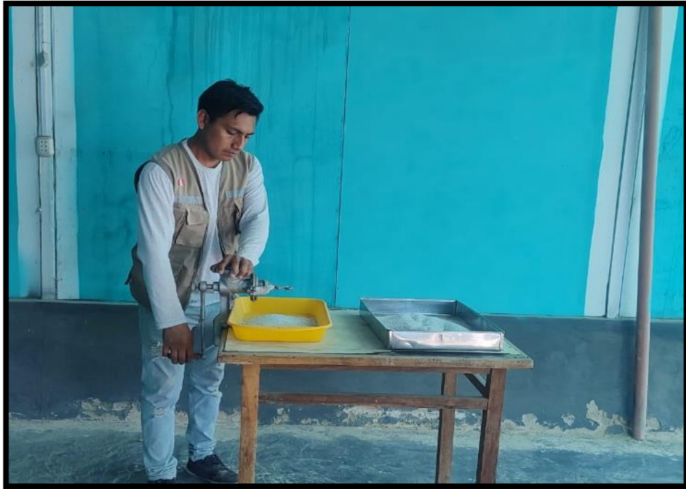
Foto N° 05: Se llegó a moler el Tagelus Dombeyi con un molino manual de casa la luego enviar al laboratorio.
