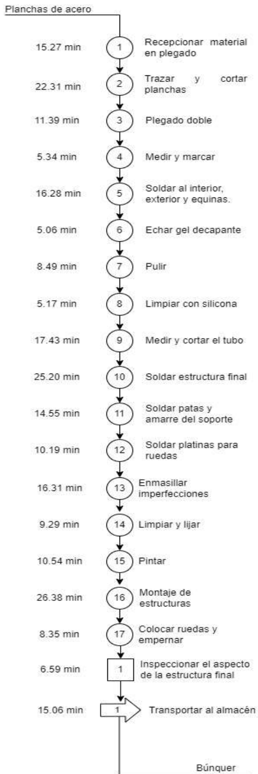
Figura 3. Diagrama de análisis del proceso - post test.
