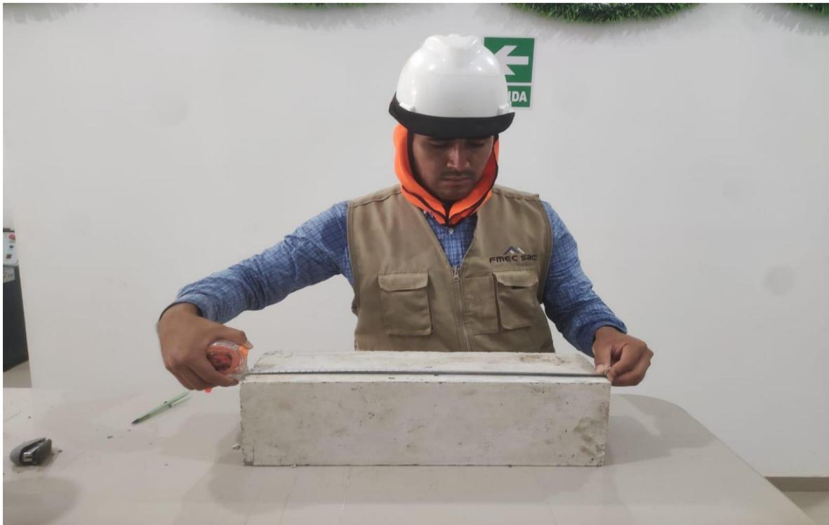
**Figura 26.** Ensayo a flexión del concreto estructural.
