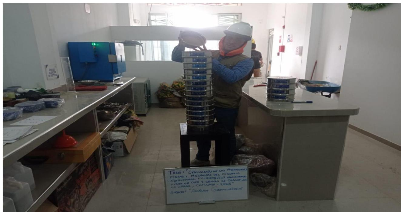
Figura 8. Ensayo granulométrico del agregado fino
