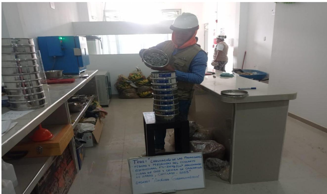
Figura 7. Ensayo granulométrico del agregado grueso.
