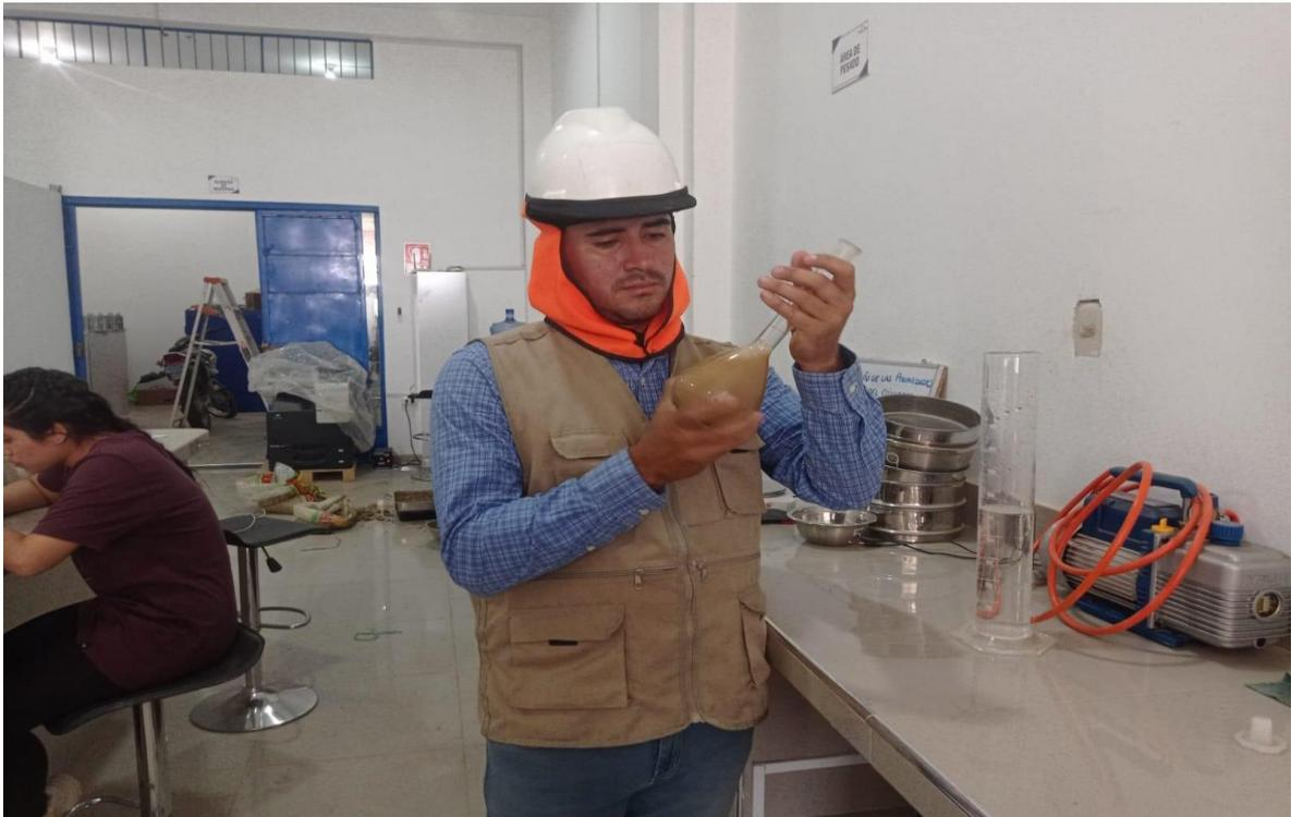
Figura 13. Ensayo de peso específico y absorción del agregado grueso.
