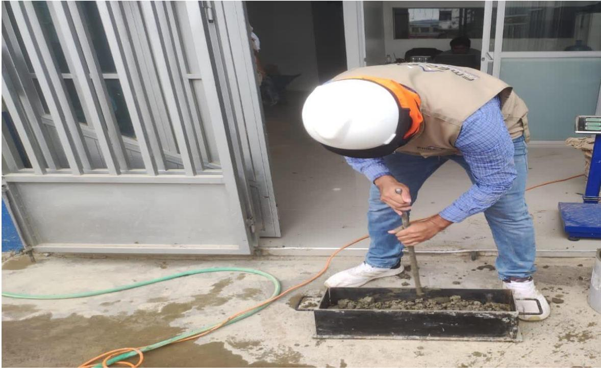
*Figura 21.* Elaboración de testigos de concreto para ensayos a compresión y flexión.
