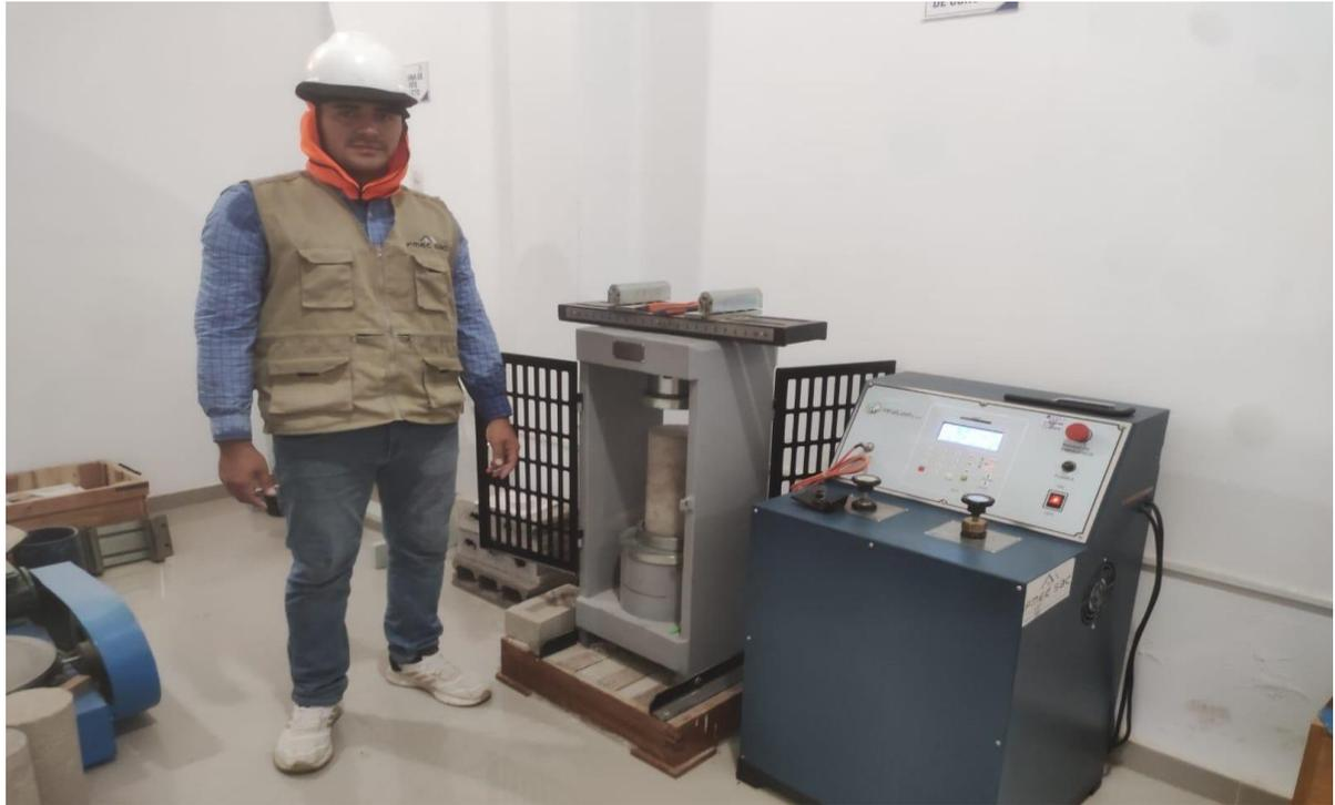
*Figura 23.* Ensayo a la compresión del concreto estructural.
