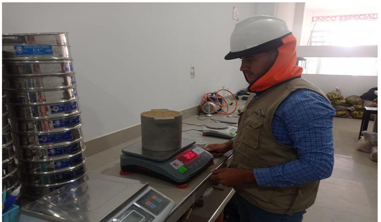
Figura 4. Ensayo de peso unitario suelto y compactado del agregado fino
