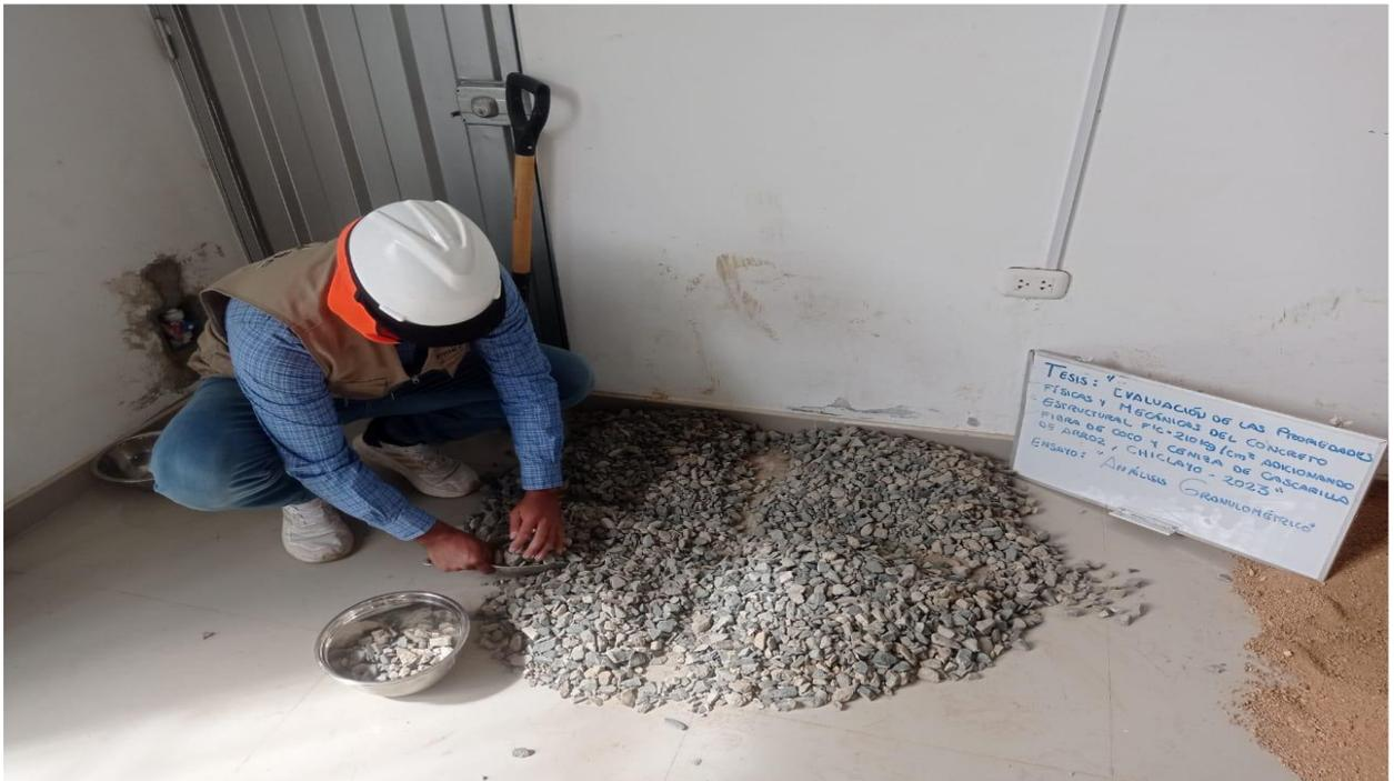
Figura 2. Cuarteo del agregado fino y grueso, para realizar los ensayos respectivos.
