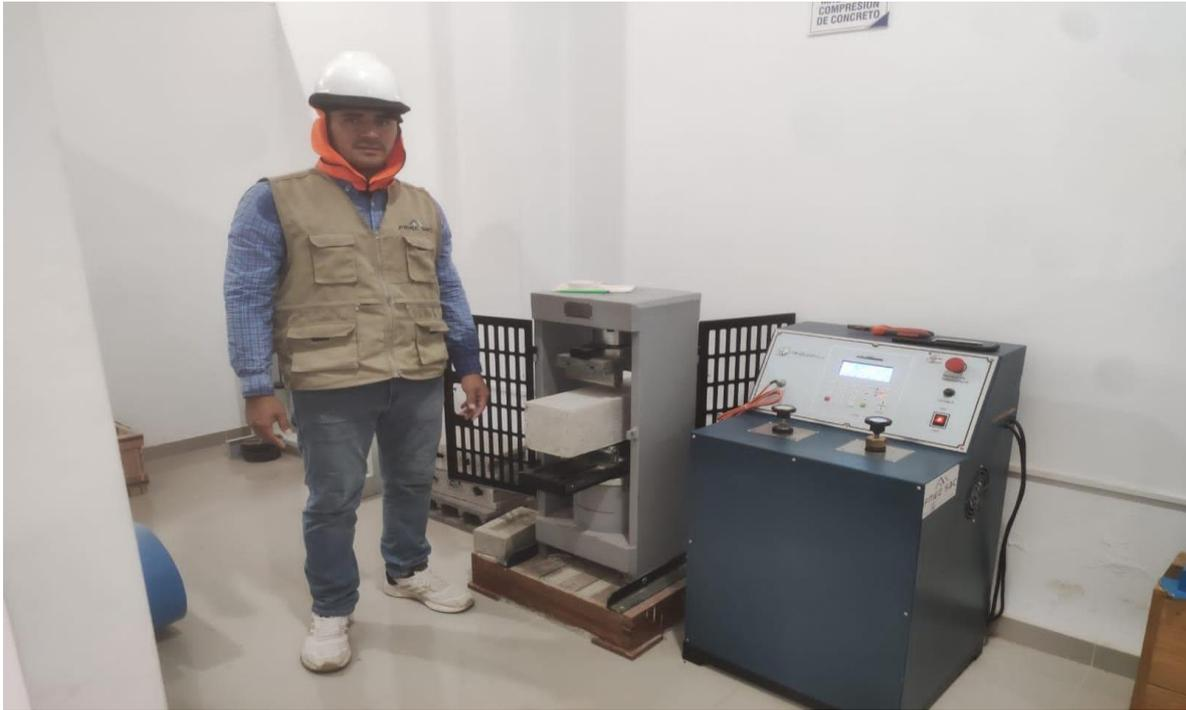
**Figura 25.** Ensayo a flexión del concreto estructural.
