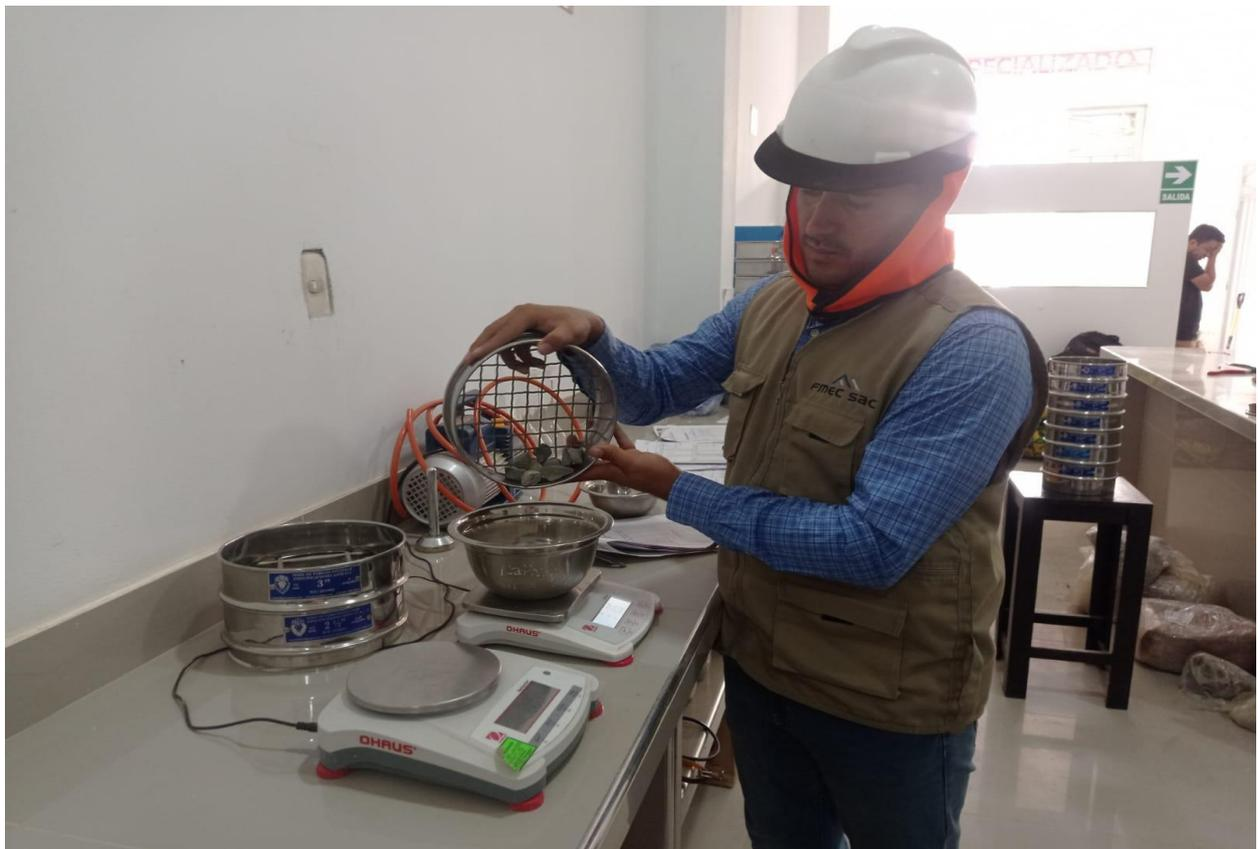
Figura 9. Ensayo granulométrico del agregado fino
