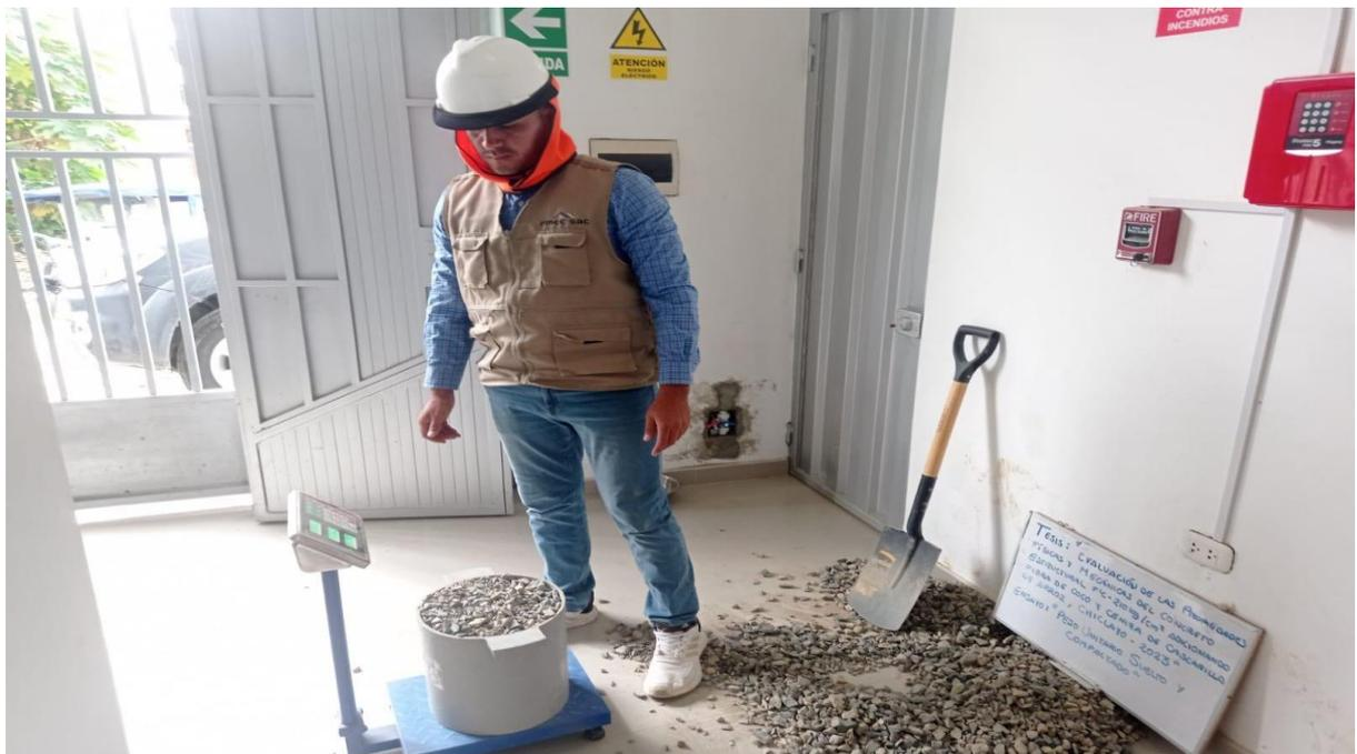
Figura 6. Ensayo de peso unitario suelto y compactado del agregado grueso
