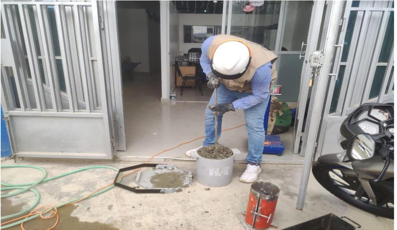
*Figura 19.* Ensayo de peso específico del concreto estructural
