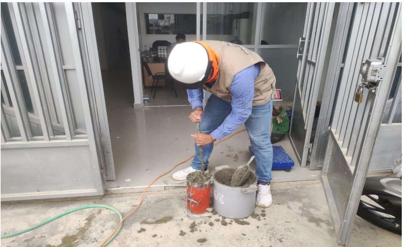
*Figura 20.* Elaboración de testigos de concreto para ensayos a compresión y flexión.
