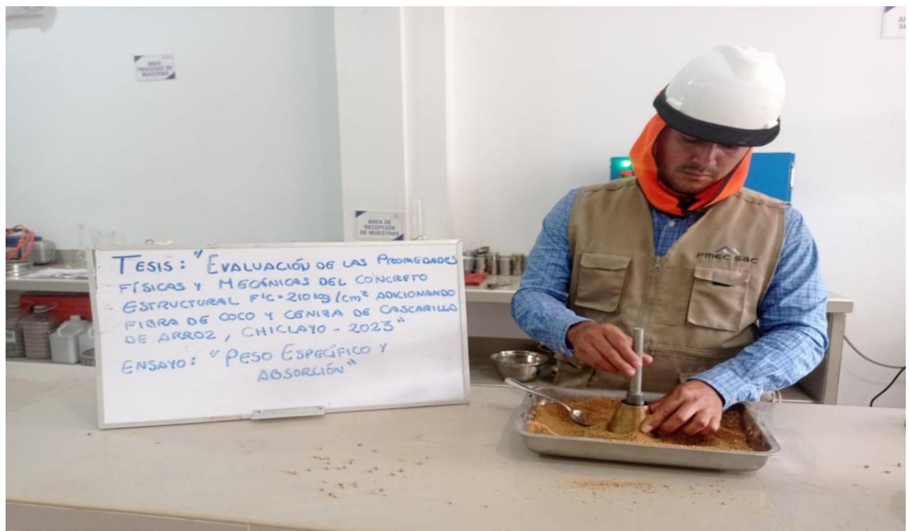
Figura 10. Ensayo de cono de abran, para obtener la absorción
