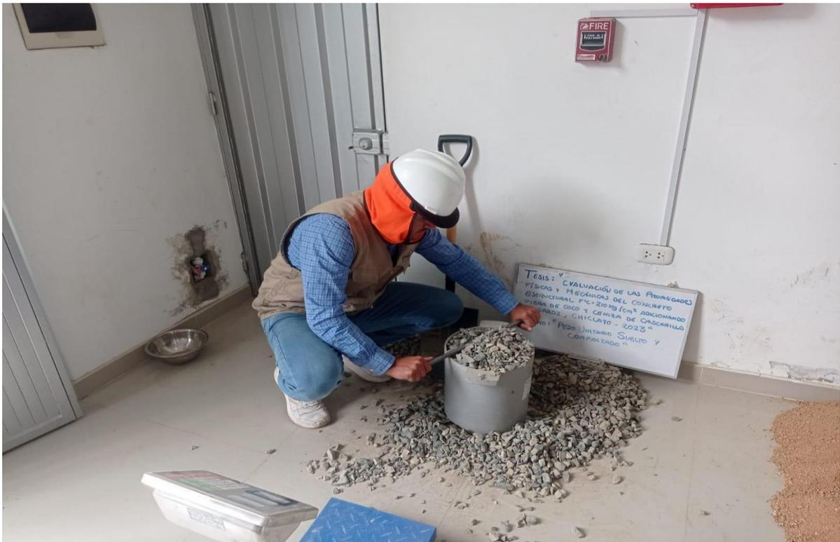
Figura 5. Ensayo de peso unitario suelto y compactado del agregado grueso
