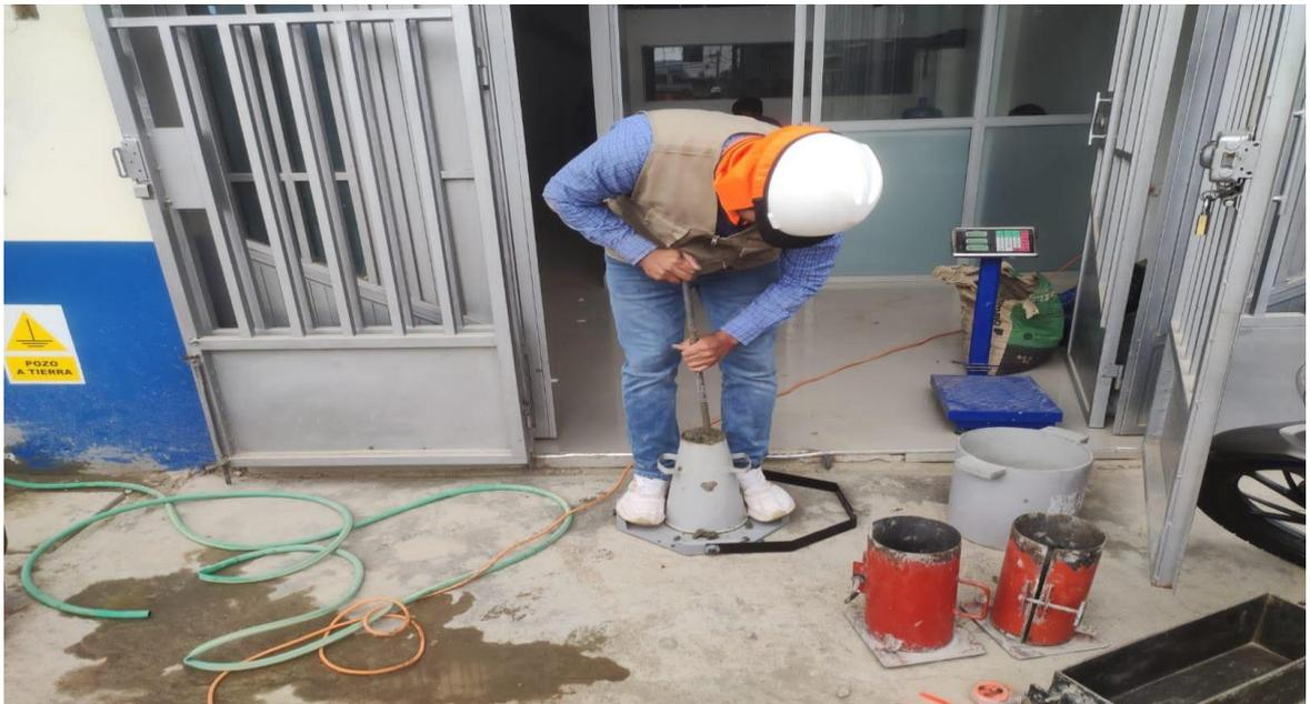
*Figura 16.* Ensayo de asentamiento del concreto (SLUMP)
