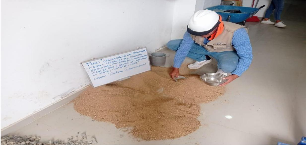
Figura 1. Cuarteo del agregado fino y grueso, para realizar los ensayos respectivos.
