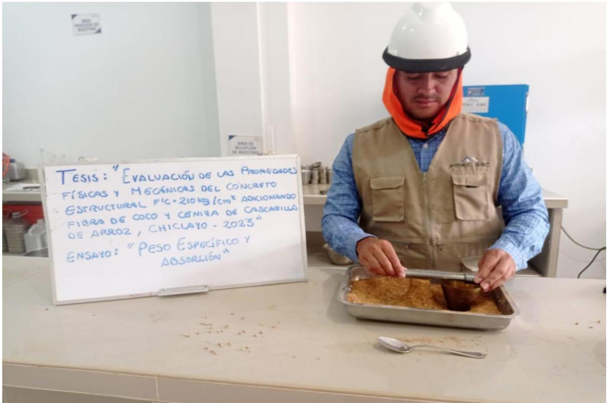
Figura 11. Ensayo de cono de abran, para obtener la absorción
