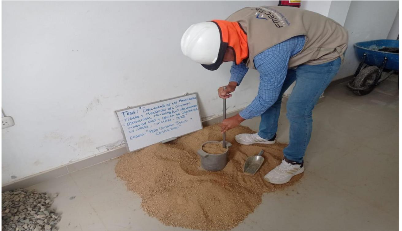
Figura 3. Ensayo de peso unitario suelto y compactado del agregado fino
