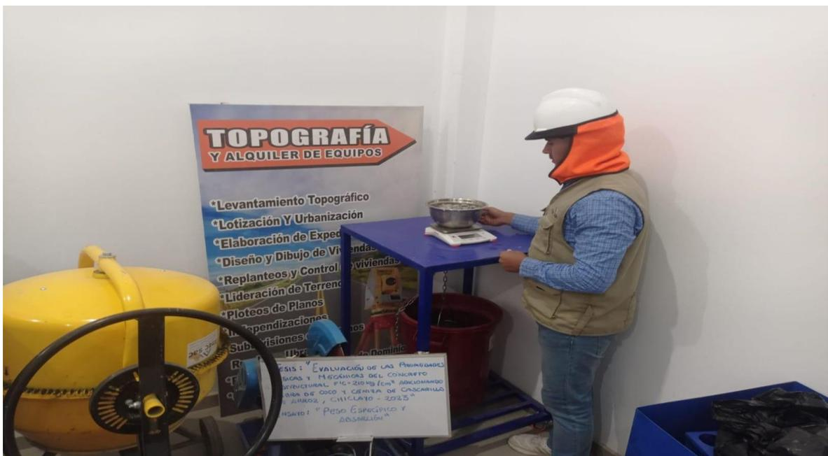
Figura 14. Ensayo de peso específico y absorción del agregado grueso.
