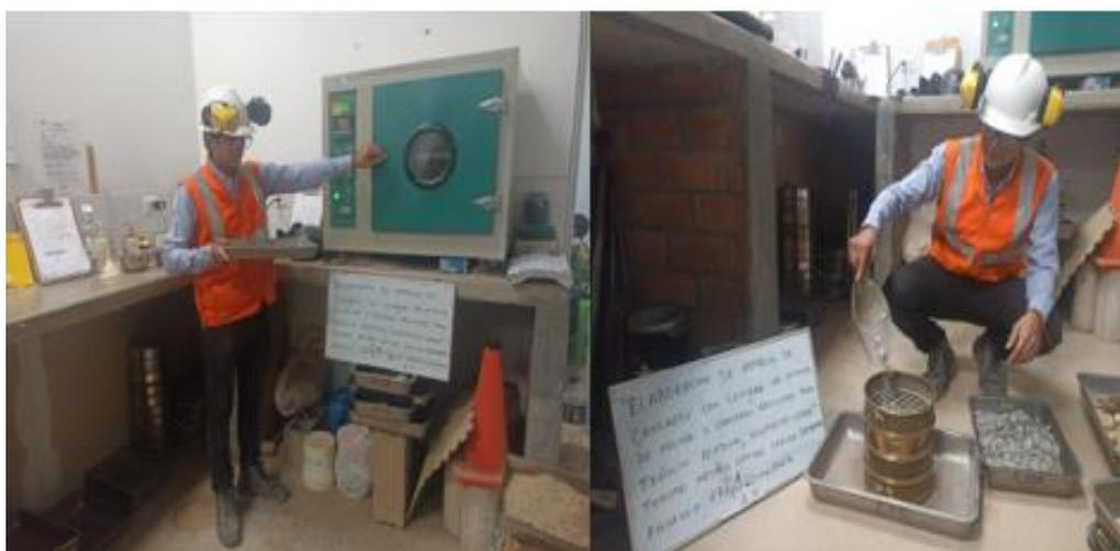
Figura 15: Secado de muestra para análisis granulométrico
