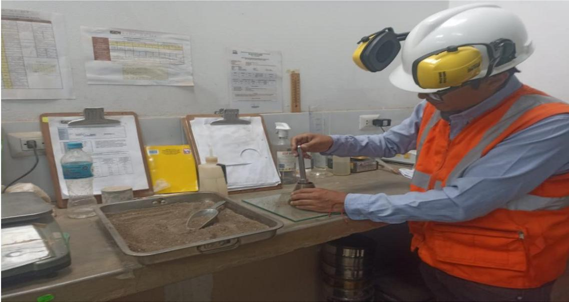
**ENSAYO PESO ESPECIFICO Y ABSORCIÓN DEL AGREGADO FINO**
