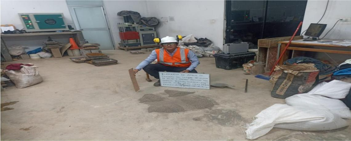
**ENSAYO ABSORCIÓN CON CONO AGREGADO FINO**
