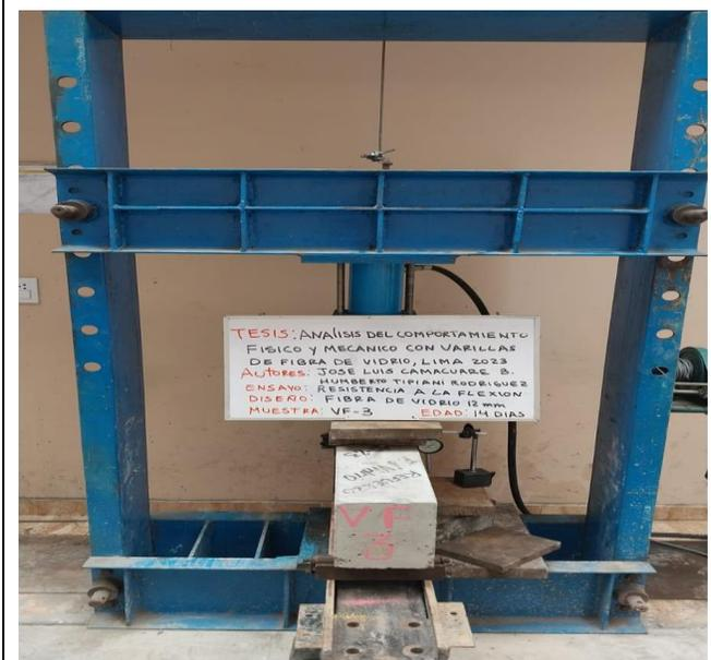
**Fotografía 19:** Viga de Acero Ensayo de Flexión a los 14 días (Viga VF-3)
