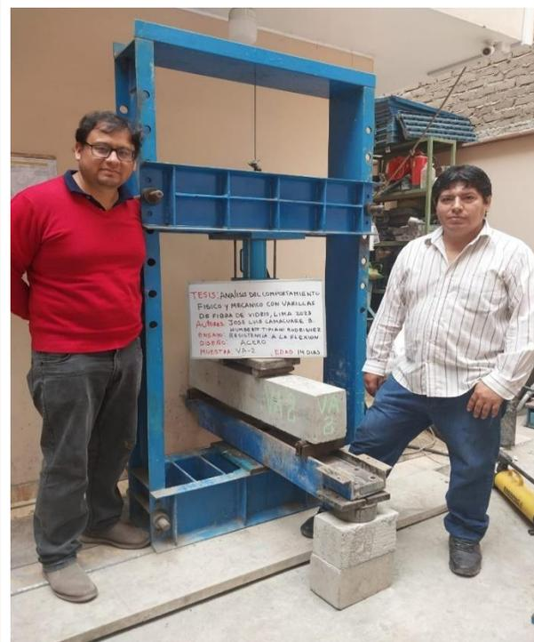
**Fotografía 18:** Viga de Acero Ensayo de Flexión a los 14 días (Viga VA-2)
