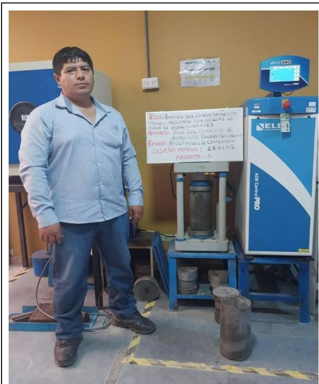
**Fotografía 13:** Ensayo Resistencia a la Compresión Edad 28 días (Patrón 5)
