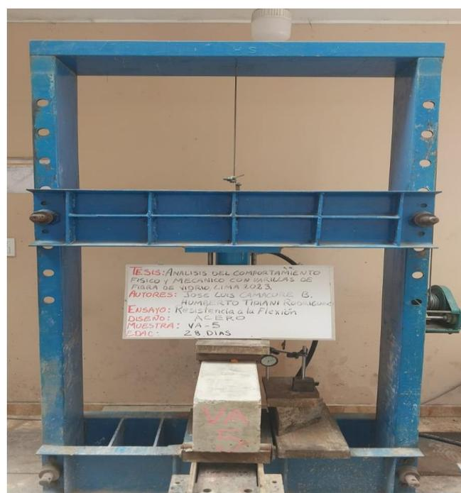
**Fotografía 24:** Viga de Acero Ensayo de Flexión a los 28 días (Viga VA-5)
