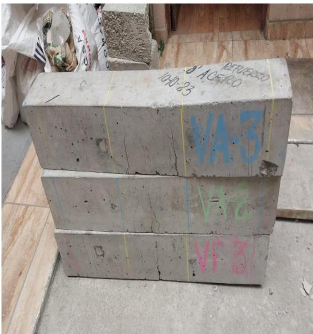
**Fotografía 27:** Vigas de Acero y Vigas de Varillas de Fibra de vidrio, Falla a Flexión
