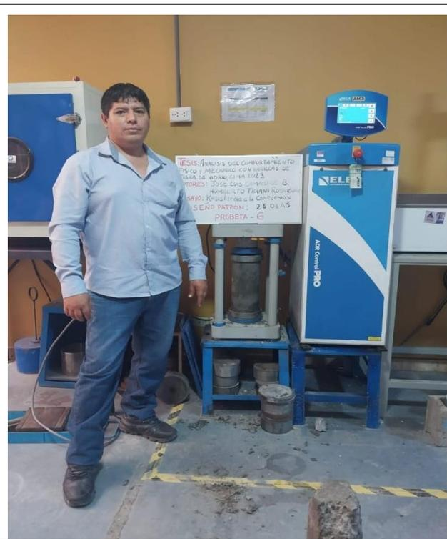
**Fotografía 14:** Ensayo Resistencia a la Compresión Edad 28 días (Patrón 6)
