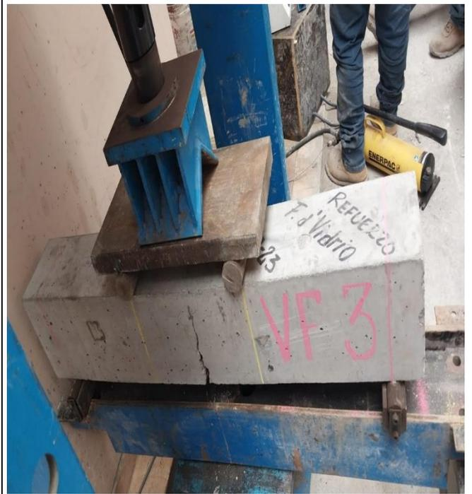
**Fotografía 26:** Viga Ensayada
