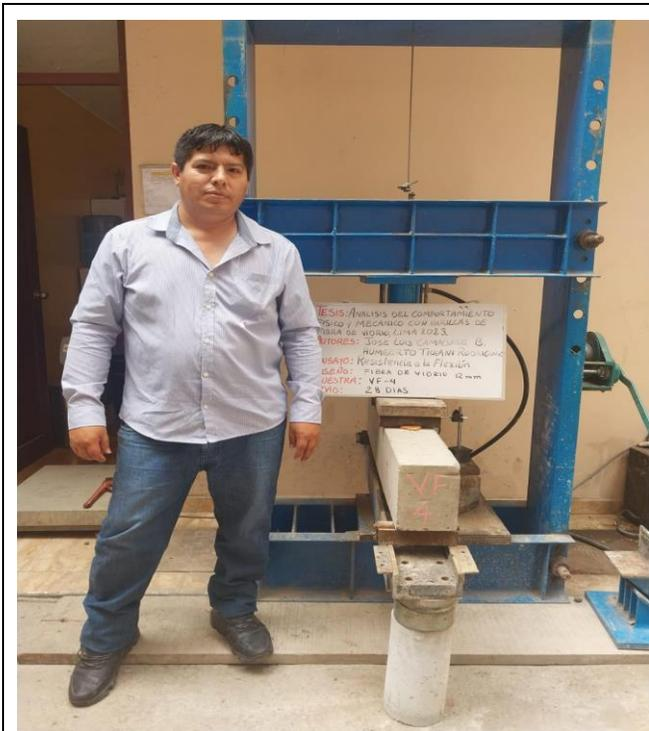
**Fotografía 21:** Viga de Acero Ensayo de Flexión a los 28 días (Viga VF-4)
