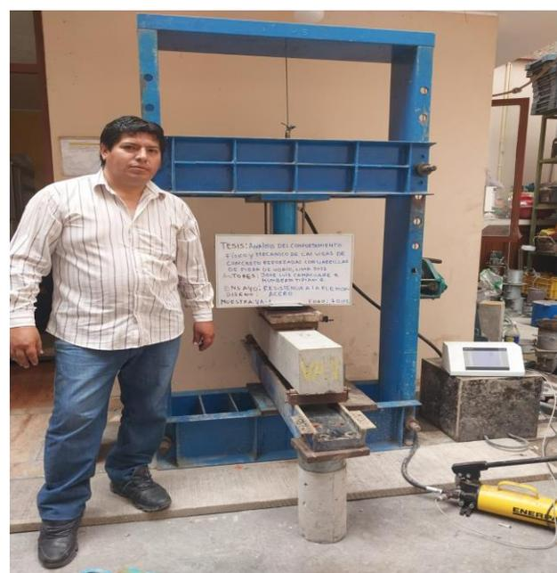
**Fotografía 16:** Viga de Acero Ensayo de Flexión a los 7 días (Viga VA-1)
