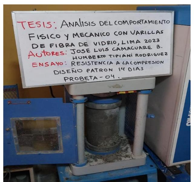
**Fotografía 12:** Ensayo Resistencia a la Compresión Edad 14 días (Patrón 4)
