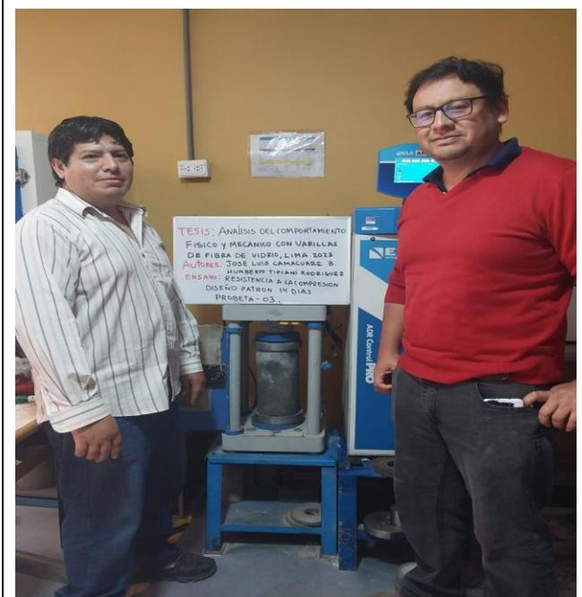
**Fotografía 11:** Ensayo Resistencia a la Compresión Edad 14 días (Patrón 3)
