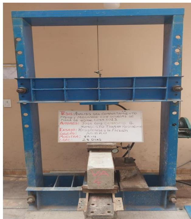
**Fotografía 22:** Viga de Acero Ensayo de Flexión a los 28 días (Viga VA-4)
