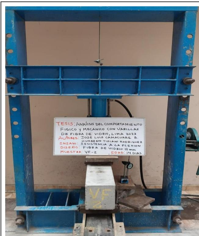
**Fotografía 17:** Viga de Acero Ensayo de Flexión a los 14 días (Viga VF-2)
