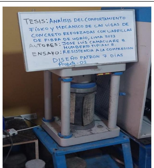
**Fotografía 10:** Ensayo Resistencia a la Compresión Edad 7 días (Patrón 2)
