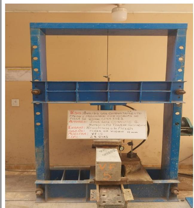
**Fotografía 23:** Viga de Acero Ensayo de Flexión a los 28 días (Viga VF-5)
