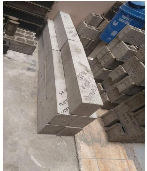
**Fotografía 08:** 5 Vigas de Acero y 5 Vigas de Fibra de Vidrio, después del desencofrado.
