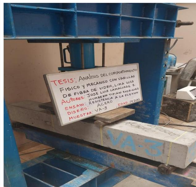
**Fotografía 20:** Viga de Acero Ensayo de Flexión a los 14 días (Viga VA-3)
