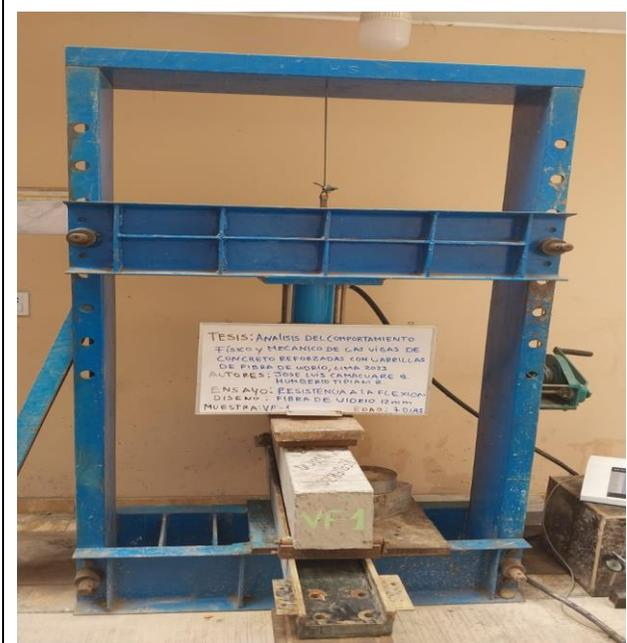
**Fotografía 15:** Viga de Acero Ensayo de Flexión a los 7 días (Viga VF-1)
