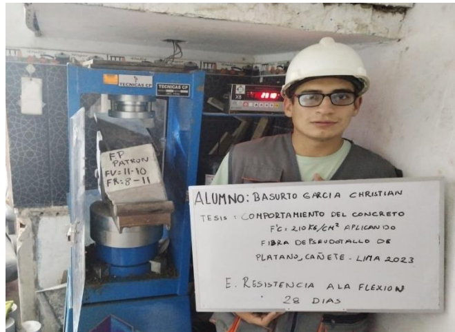
Figura 36: Rotura de vigas a 28 días
