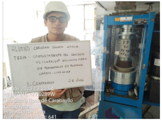
Ensayo de compresión 28 días
