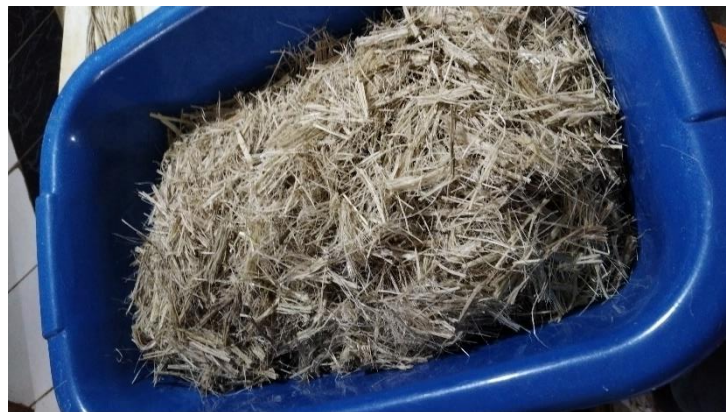
Figura 9: Fibra de pseudotallo de plátano cortadas de 2 a 5 cm de tamaño
