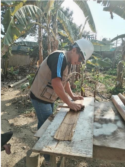
Figura 7: Obtención de la fibra con cepillo de hierro
