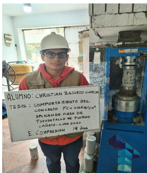
Figura 27: Rotura a los 14 días.
