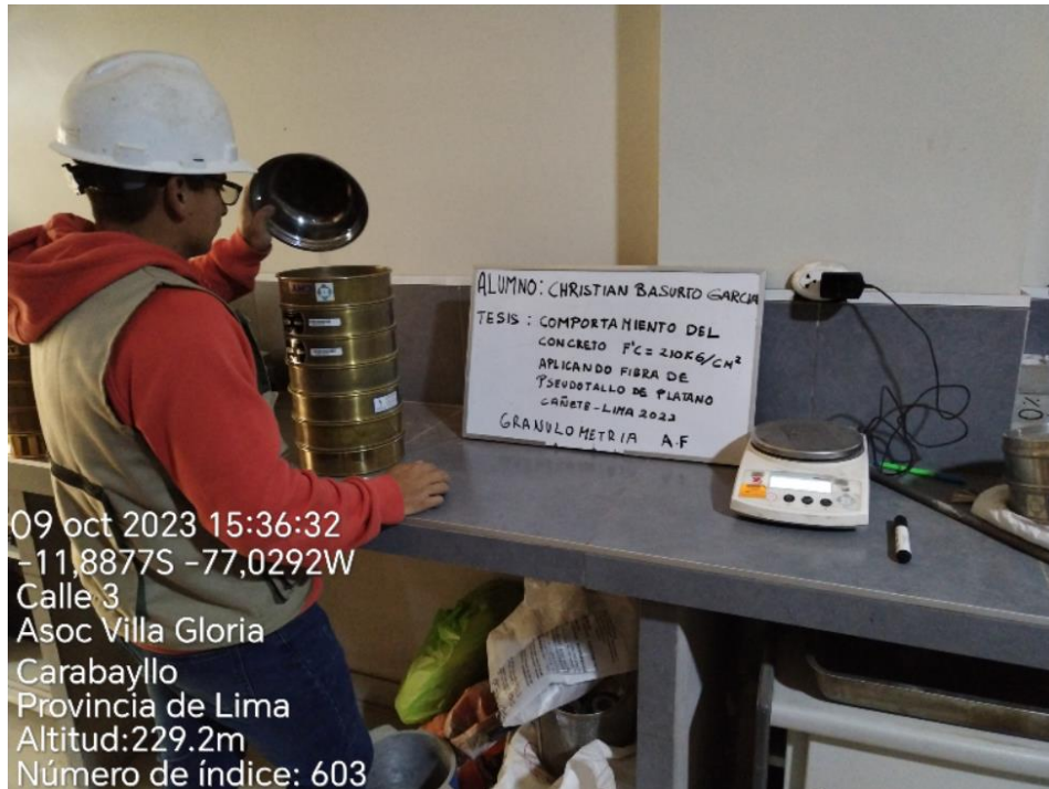
Figura 10: Ensayo de granulometría del agregado fino Fuente: Autoría propia.
