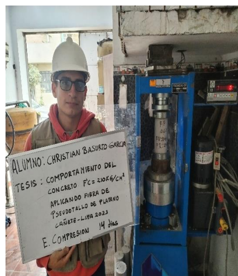
Figura 28: Rotura a los 14 días.
