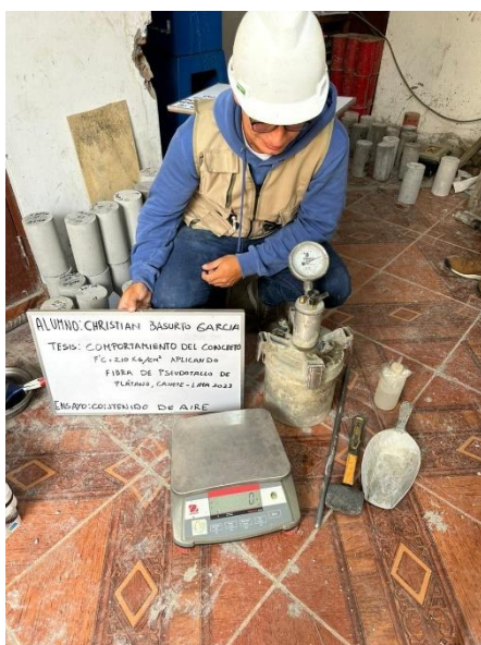
Figura 34: Ensayo con la olla de Washington Fuente: Autoría propia.
