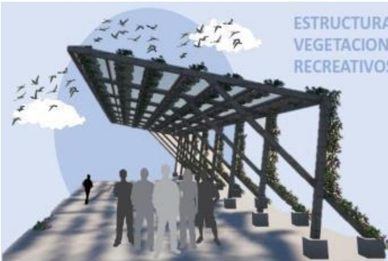
Anteriormente las estructuras no estaban trabajadas correctamente, en la propuesta estamos aumentando (1.5m, en total 5m) el tamaño de la estructura y implementando vegetación para lograr un confort térmico y evitar la sensación de bochorno
