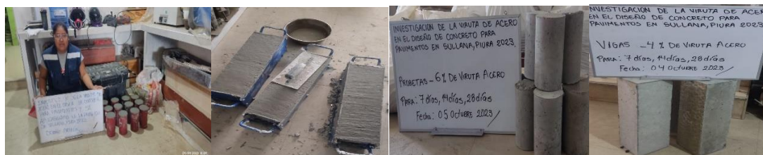
Figura N°18. “Fraguado y desmolde a probetas y vigas de compresión y flexión”.
