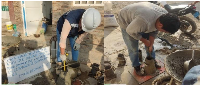
Figura N°16. “Ensayo de Slump”
