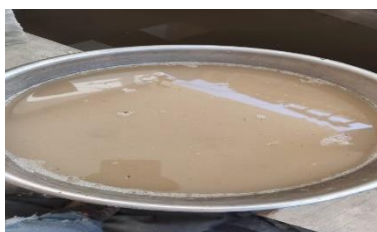
Figura N°15. “Ensayo de P.E de Ag. F (saturación del Ag. F)”.
