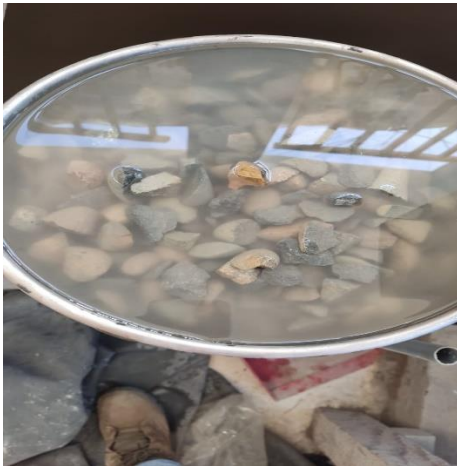
Figura N°9. “Ensayo de P.E de Agregado Grueso (saturación del Ag. G)”.
