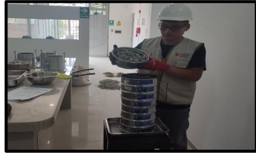
Imagen N° 05: Anotación del peso de cada malla previamente tamizada incluyendo el fondo, para la realizar los cálculos correspondientes.
