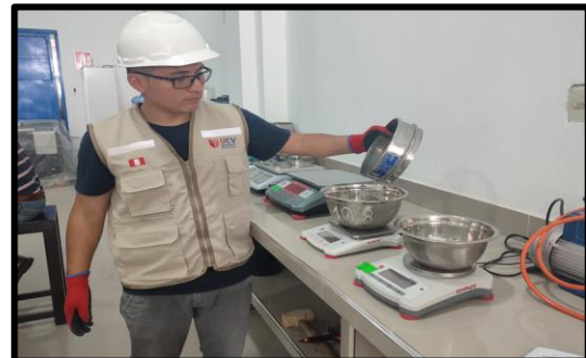
Imagen N° 05: Anotación del peso de cada malla previamente tamizada incluyendo el fondo, para la realizar los cálculos correspondientes.
