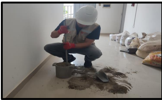
Imagen N° 14: En la tercera capa enrasar la superficie del molde con la varilla.
