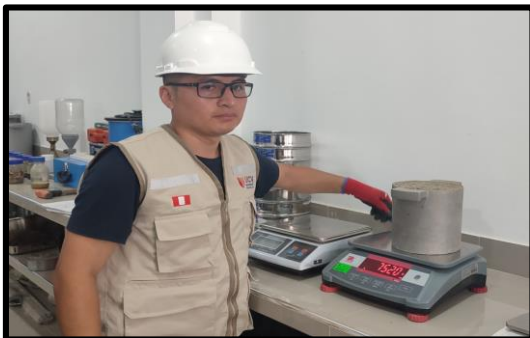
Imagen N° 15: Pesar el molde con el agregado para obtener el peso unitario compactado.
