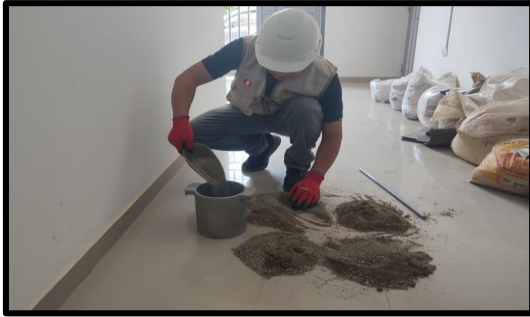
Imagen N° 09: Enrasado de la superficie del molde con la varilla, para ambas muestras.
