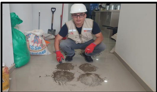
Imagen N° 07: Se realiza el cuarteo de muestras.
