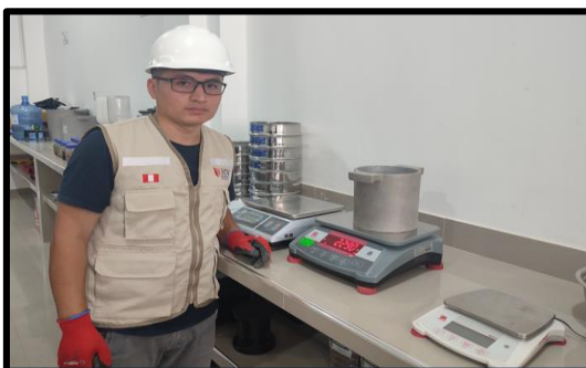
Imagen N° 11: Peso y volumen del molde.
