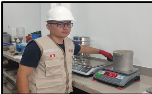
Imagen N° 10: Pesar el molde con el agregado fino y del agregado grueso para obtener el peso unitario suelto.
