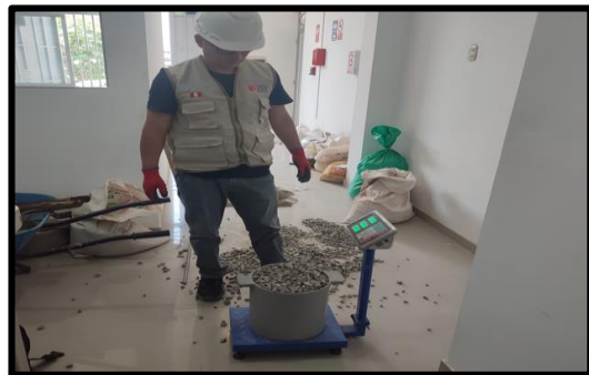
Imagen N° 15: Pesar el molde con el agregado para obtener el peso unitario compactado.
