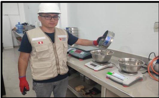
Imagen N° 05: Anotación del peso de cada malla previamente tamizada incluyendo el fondo, para la realizar los cálculos correspondientes.
