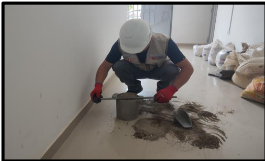
Imagen N° 10: Pesar el molde con el agregado fino y del agregado grueso para obtener el peso unitario suelto.
