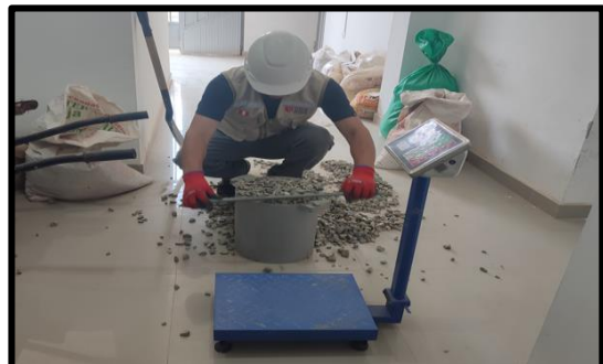
Imagen N° 15: Pesar el molde con el agregado para obtener el peso unitario compactado.
