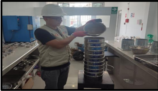
Imagen N° 05: Anotación del peso de cada malla previamente tamizada incluyendo el fondo, para la realizar los cálculos correspondientes.
