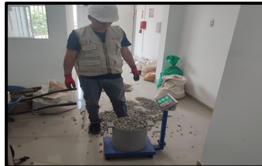
Imagen N° 10: Pesar el molde con el agregado fino y del agregado grueso para obtener el peso unitario suelto.
