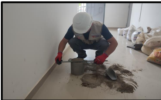
Imagen N° 15: Pesar el molde con el agregado para obtener el peso unitario compactado.
