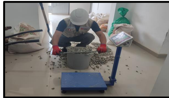
Imagen N° 10: Pesar el molde con el agregado fino y del agregado grueso para obtener el peso unitario suelto.
