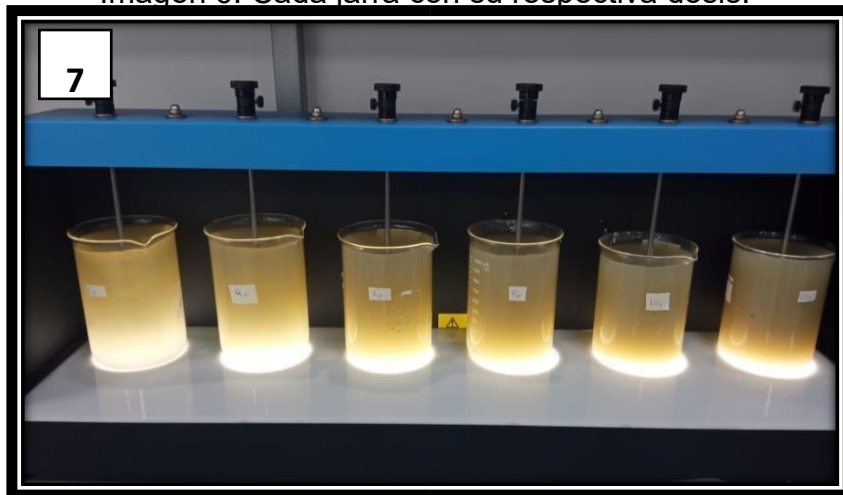
Imagen 7: Empezando la Prueba de jarras.
