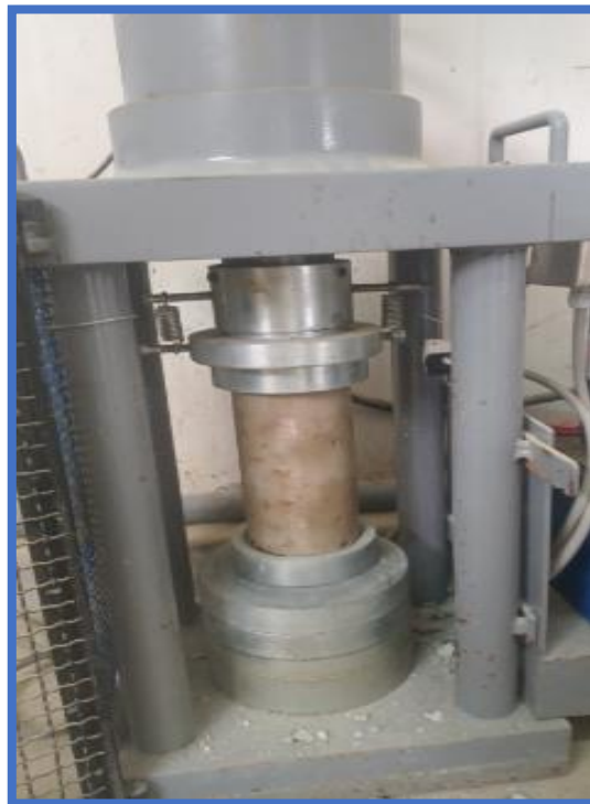
Fotografía 10 Ensayo de compresión de los especímenes
