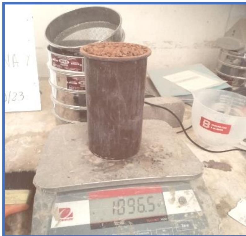
Fotografía 6 Pesaje del ladrillo reciclado triturado
