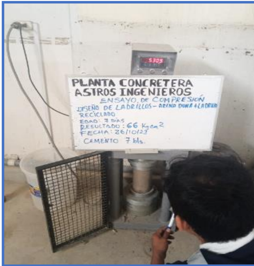
Fotografía 9 Ensayo de compresión
