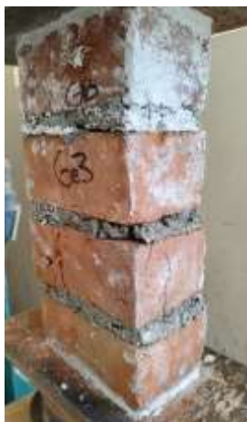
Fotografía 1. Rotura de pila grupo experimental 3
