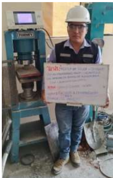
Fotografía 1. Ensayo de compresión de cubos de mortero 7 días
