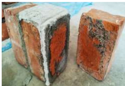
Fotografía 2. Resultado del ensayo de adherencia
