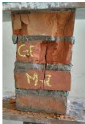
Fotografía 2. Rotura de pila GE-02 (28 días)
