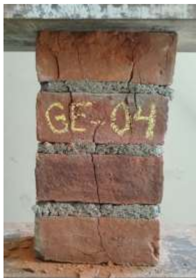
Fotografía 5. Rotura de pila GE-04 (28 días)
