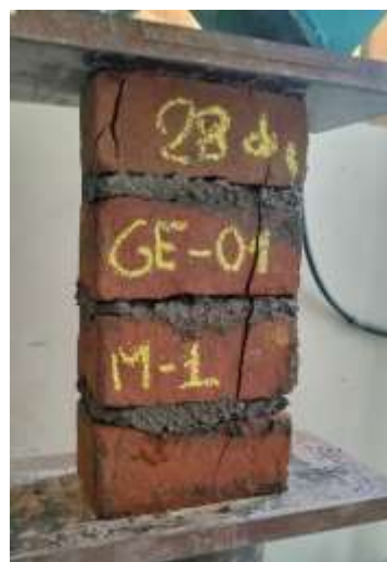
Fotografía 6. Rotura de pila GE-01 (28 días)
