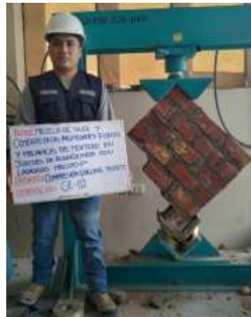
Fotografía 4. Ensayo de compresión diagonal de muretes
