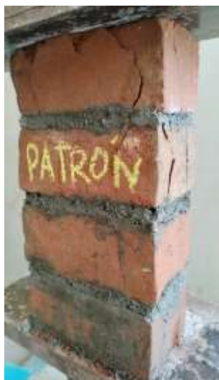
Fotografía 5. Rotura de pila Patrón (28 días)
