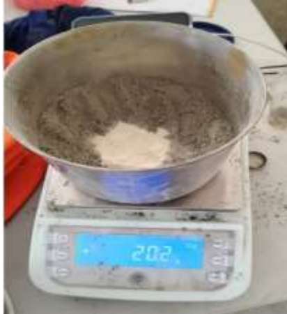
Fotografía 1. Mezcla de sílice y cemento
