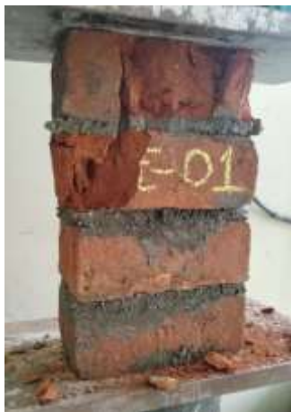
Fotografía 1. Rotura de pila GE-01 (28 días)
