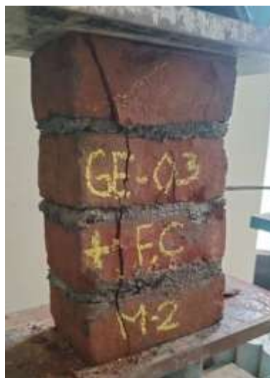
Fotografía 6. Rotura de pila GE-02+Fibra de Caucho (28 días)
