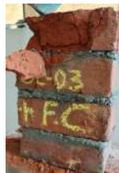
Fotografía 2. Muestra de pila donde se nota el efecto de la fi caucho.
