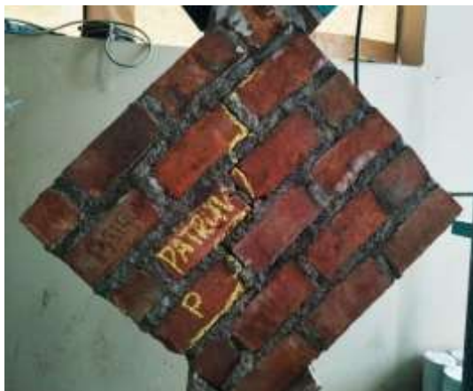
Fotografía 3. Ensayo de compresión diagonal de muretes
