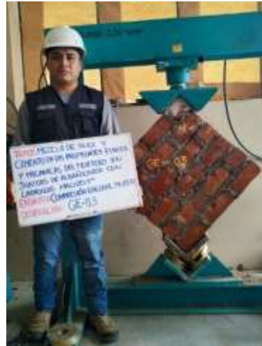
Fotografía 2. Ensayo de compresión diagonal de muretes
