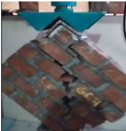
Fotografía 5. Ensayo de compresión diagonal de muretes
