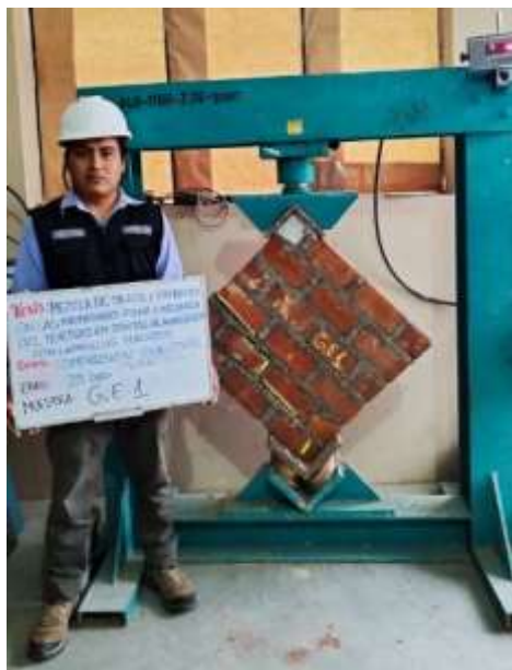
Fotografía 1. Ensayo de compresión diagonal de muretes
