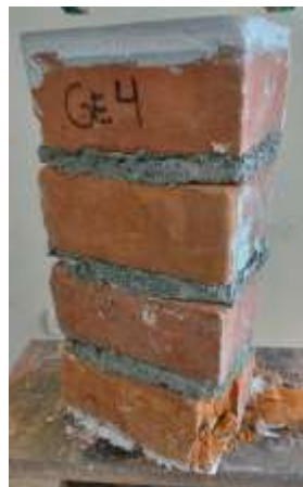
Fotografía 2. Rotura de pila grupo experimental 4
