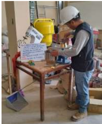
Fotografía 2. Compactado de la muestra en 2 partes
