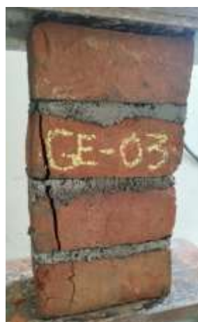
Fotografía 4. Rotura de pila GE-03 (28 días)
