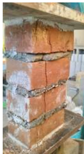
Fotografía 4. Rotura de pila grupo experimental 4
