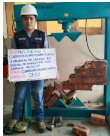
Fotografía 6. Ensayo de compresión diagonal de muretes
