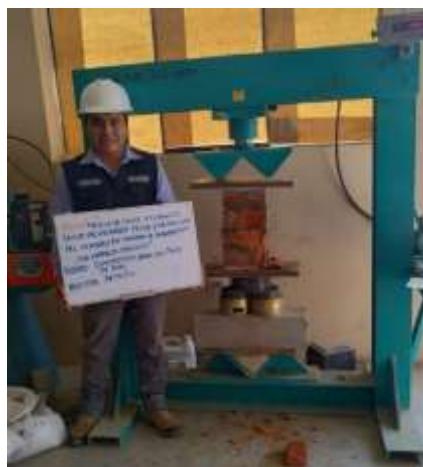
Fotografía 2. Rotura de pilas 14 días (patrón)
