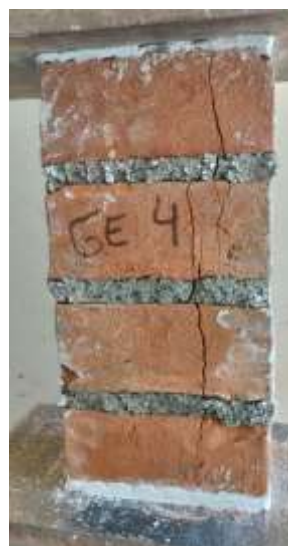
Fotografía 6. Rotura de pila grupo experimental 4
