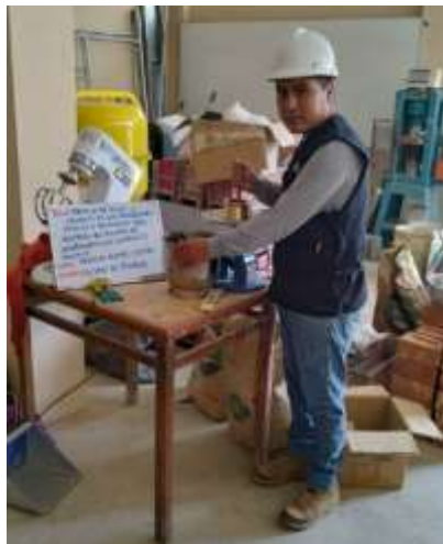
Fotografía 1. Compactado de la muestra en 2 partes
