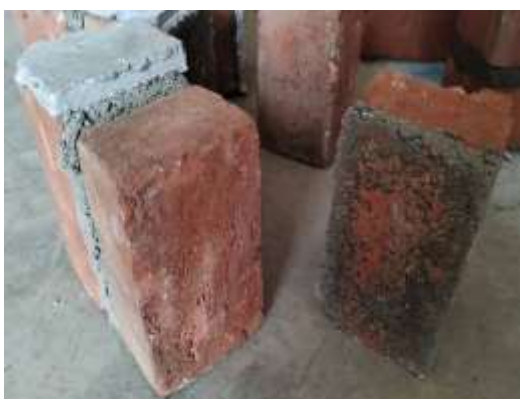
Fotografía 3. Resultado del ensayo de adherencia
