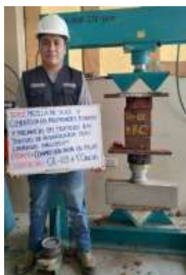
Fotografía 3. Ensayo de pila con adición de sílice y fibra de caucho
