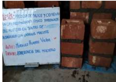
Fotografía 2. Pilas para ensayo de adherencia
