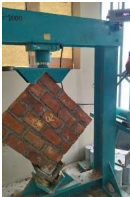
Fotografía 2. Ensayo de compresión diagonal de muretes
