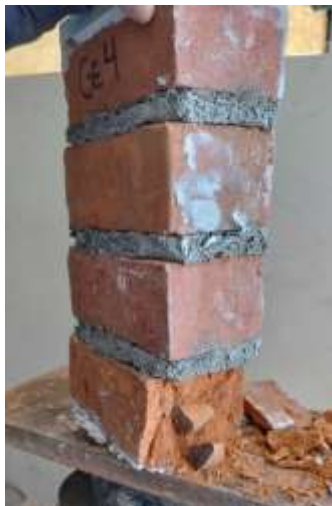
Fotografía 3. Rotura de pila grupo experimental 4
