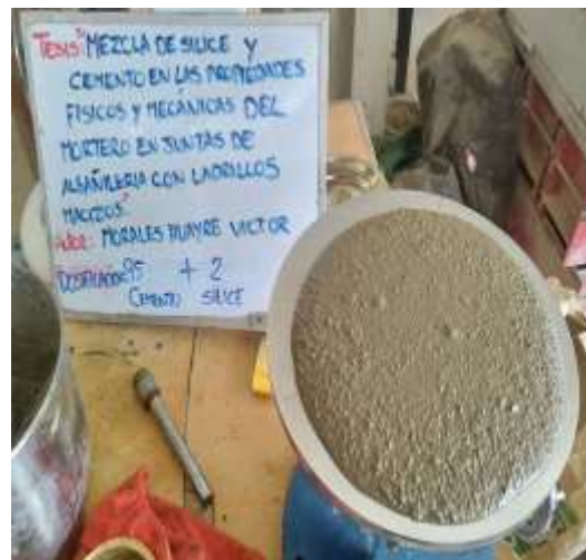
Fotografía 6. Fluidez del mortero
