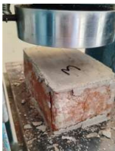
Fotografía 5. Ensayo de compresión de la unidad de albañilería
