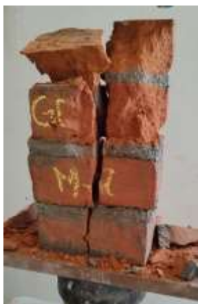
Fotografía 3. Rotura de pila GE-02 (28 días)
