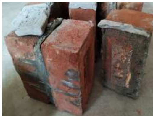
Fotografía 4. Resultado del ensayo de adherencia
