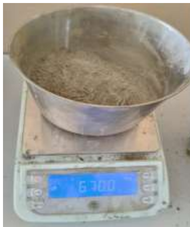
Fotografía 4. Peso del cemento
