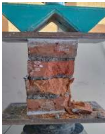
Fotografía 4. Rotura de pila grupo experimental 1
