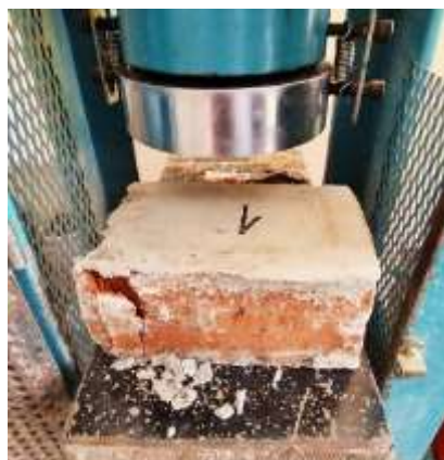
Fotografía 4. Ensayo de compresión de la unidad de albañilería
