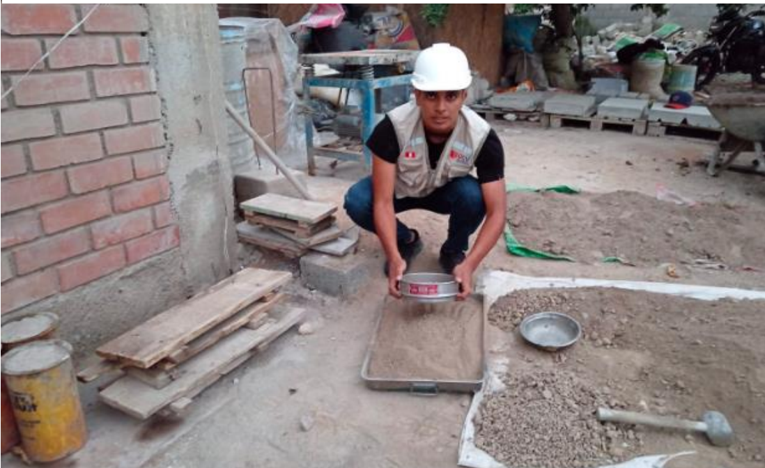
Figura 7: Av. Villa Hermosa Chiclayo, Lambayeque, ensayo de Proctor modificado, tamizado por la malla N°4, 2023
