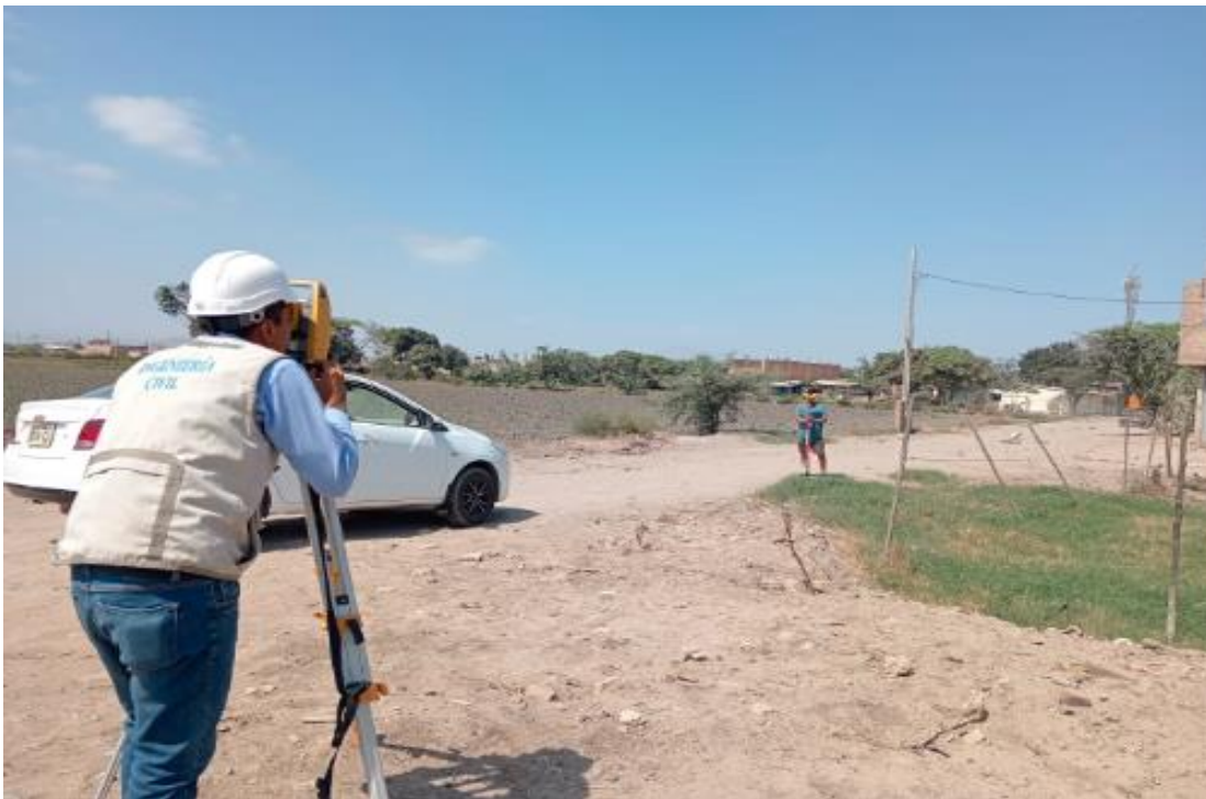
Figura 15: Av. Villa Hermosa, Chiclayo, Levantamiento topográfico con estación total y un prismo de apoyo, 2023
