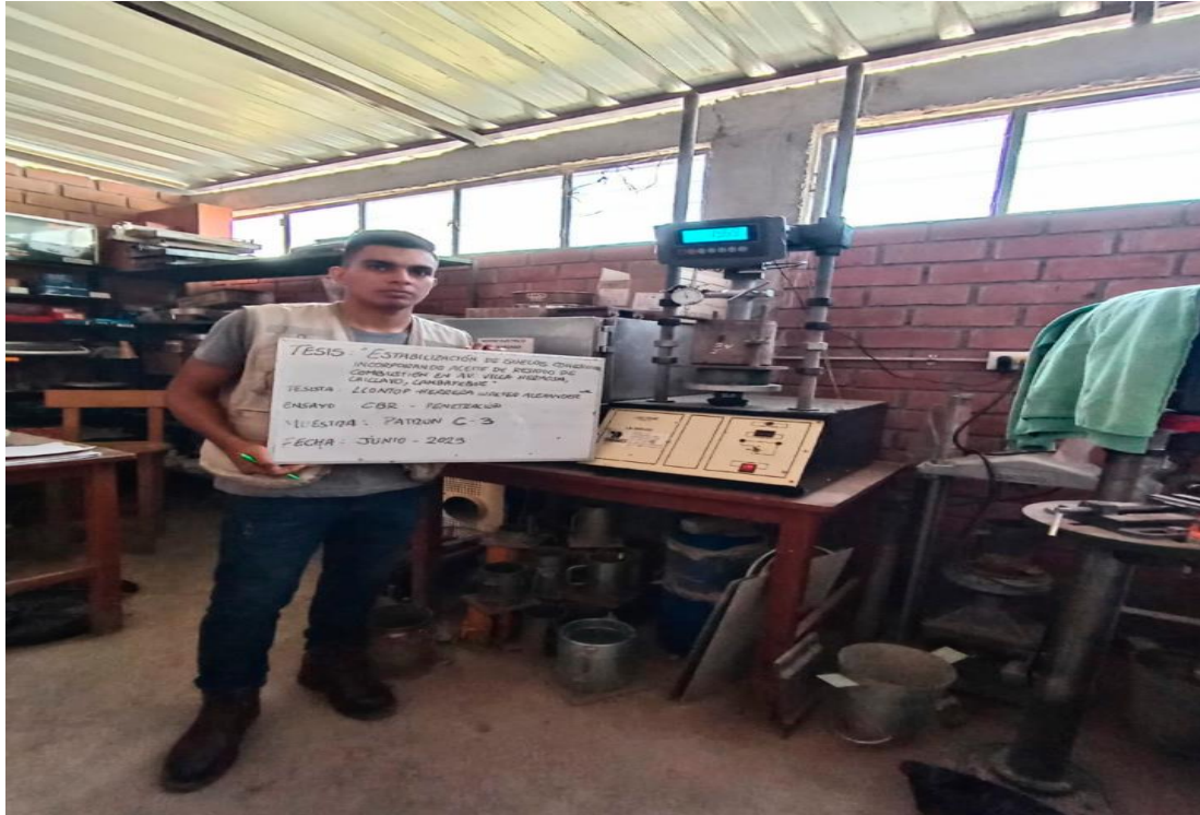
Figura 4: Laboratorio LEMS W&C EIRL, ensayo de CBR - Penetración a 1" de la muestra patrón C3 de la Av. Villa Hermosa, Chiclayo, Lambayeque, 2023
