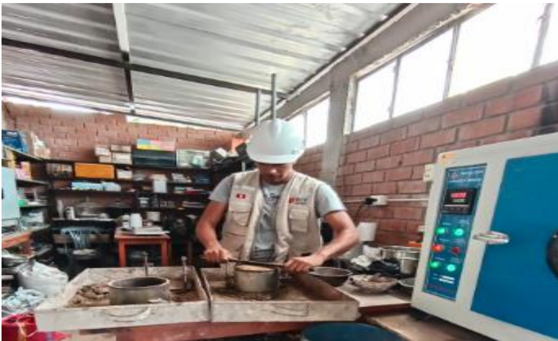
Figura 11: Laboratorio LEMS W&C EIRL, ensayo de Proctor modificado de la muestra patrón de la C3 enrasado del molde de la Av. Villa Hermosa, Chiclayo, Lambayeque, 2023
