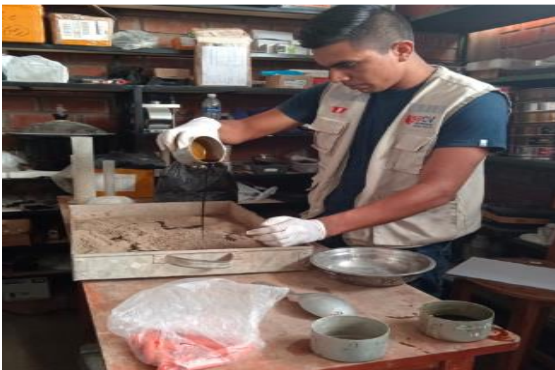
Figura 3: Laboratorio LEMS W&C EIRL, Mezcla del ARC con la muestra en estado natural C3 de la Av. Villa Hermosa, Chiclayo, Lambayeque, 2023
