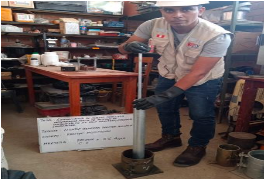
Figura 10: Laboratorio LEMS W&C EIRL, ensayo de Proctor modificado de la muestra en estado natural de la C3 de la Av. Villa Hermosa, Chiclayo, Lambayeque, 2023
