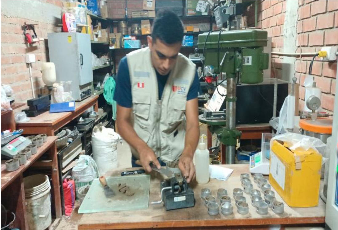
Figura 8: Laboratorio LEMS W&C EIRL, ensayo de Límite Plástico, de muestra en estado natural de la C3 de la Av. Villa Hermosa, Chiclayo, Lambayeque, 2023
