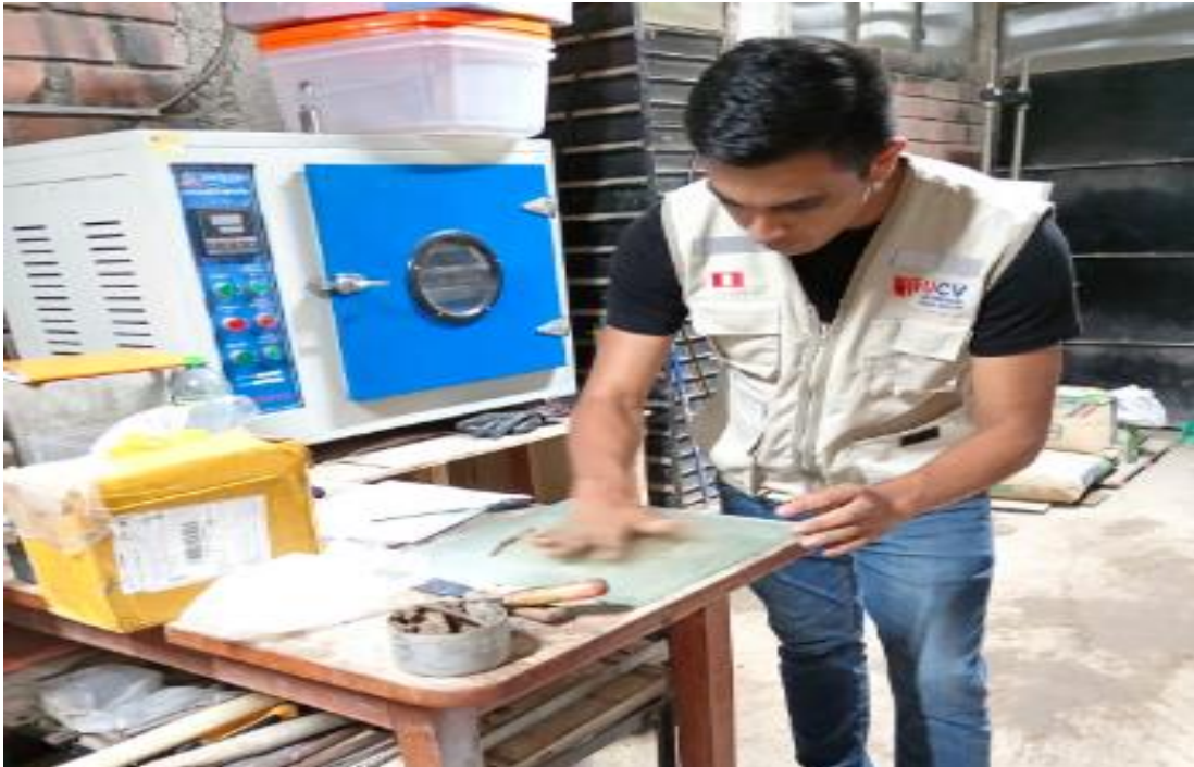
Figura 9: Laboratorio LEMS W&C EIRL, ensayo de Límite Líquido de la muestra en estado natural de la C3 de la Av. Villa Hermosa, Chiclayo, Lambayeque, 2023
