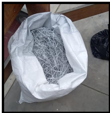
Figura N°5. Fibra de polipropileno fibrilada 18mm – 45mm
