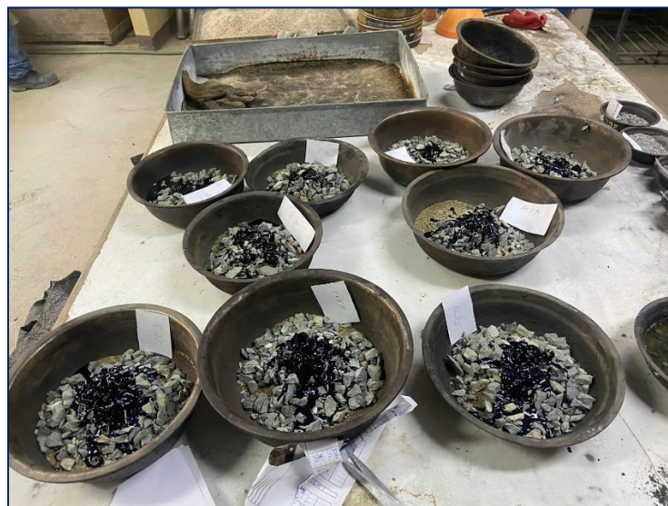
Imagen n.º 3: Pesado de materiales con diferente porcentaje de cemento asfáltico para el diseño de la mezcla patrón.
