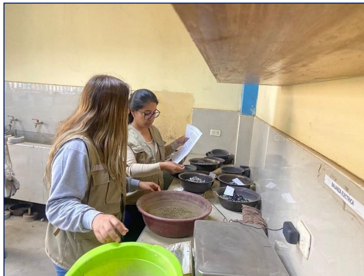
Imagen n.º 3: Pesado de materiales con diferente porcentaje de cemento asfáltico para el diseño de la mezcla patrón.
