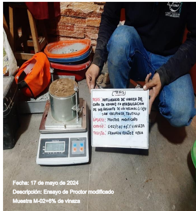
Figura 11: Ensayo Proctor Modificado C-02 con 6%
