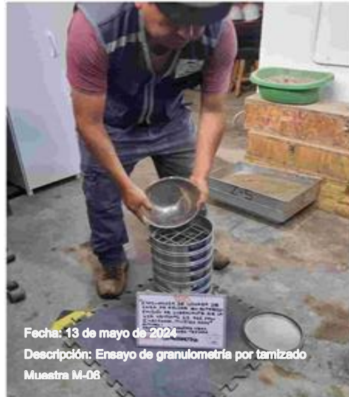
Figura 10: Granulometría por tamizado M-06
