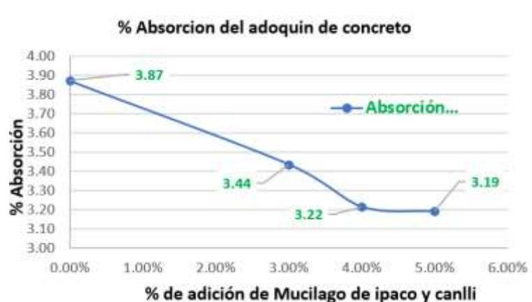
Figura 42. % de absorción del adoquín de ipaco y canlli
