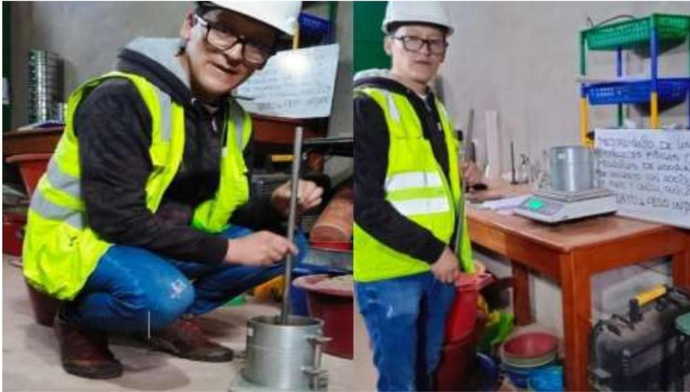
*Figura 23.* Ensayo de peso unitario y vacíos de los agregados
