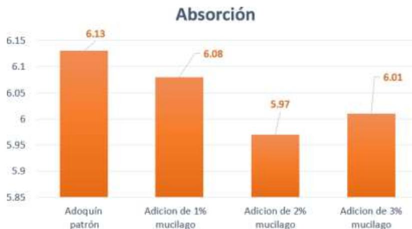
*Figura 41. % de absorción del adoquín
