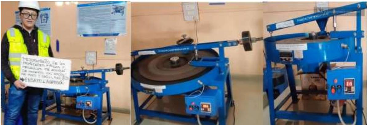
*Figura 39. Adoquín sometido a resistencia a la abrasión
