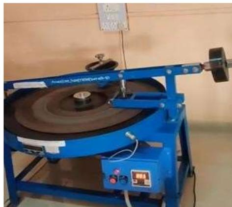
Vista 32: Adoquín sometido a resistencia a la abrasión
