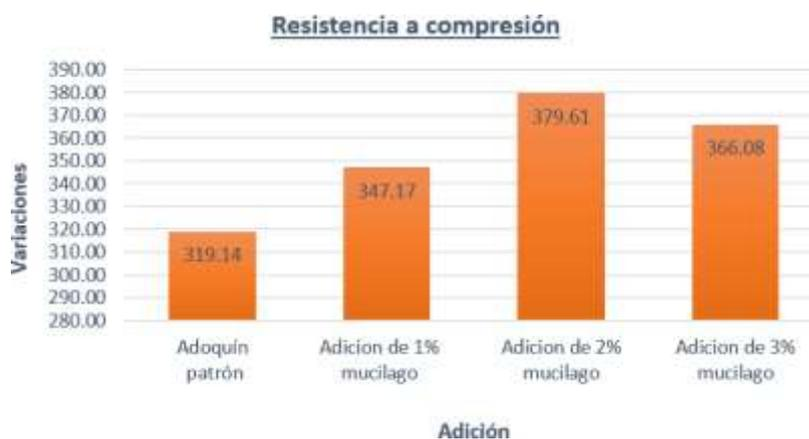
Figura 47. Esfuerzo a compresión del adoquín
