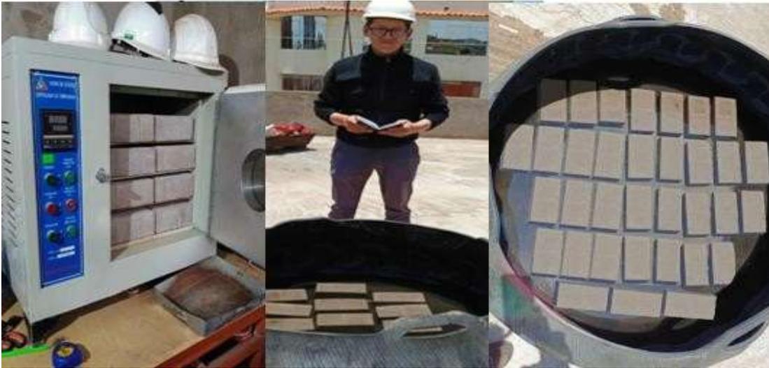
*Figura 24.* Ensayos en laboratorio para determinar el % absorción
