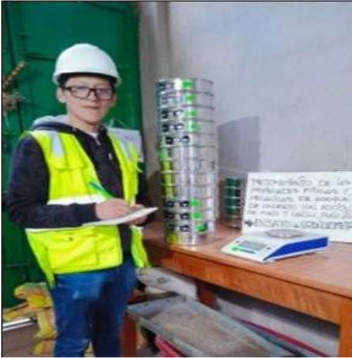
Vista 15: Se observa la realización del ensayo de granulometría
