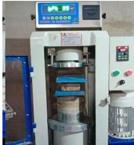
Vista 30: Adoquín sometido a resistencia a la flexión
