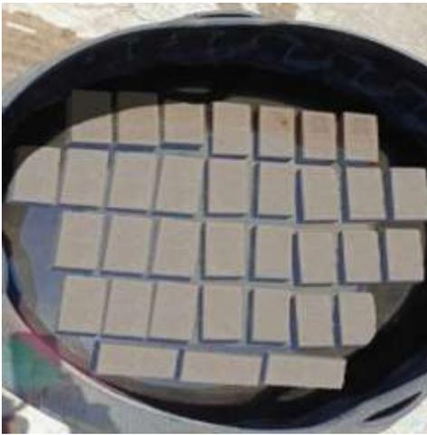
Vista 23: Ensayos en laboratorio para determinar el % absorción
