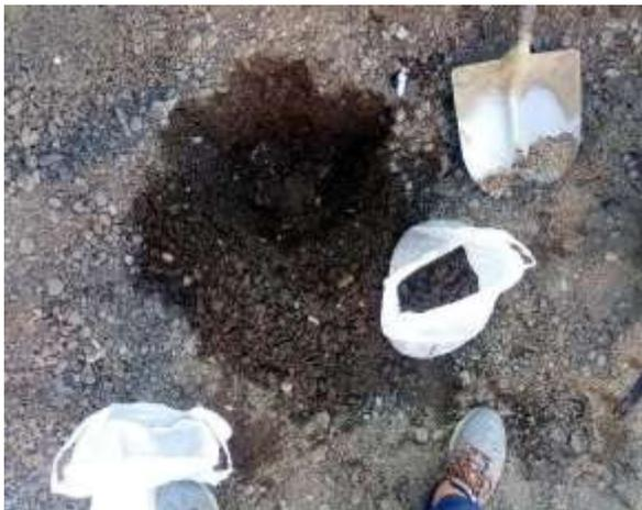
Vista 11: Se observa la extracción de la muestra húmeda
