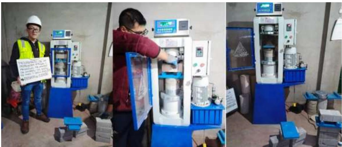
*Figura 37. Adoquín sometido a resistencia a la flexión
