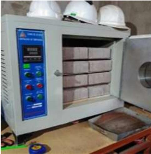
Vista 21: Ensayos en laboratorio para determinar el % absorción
