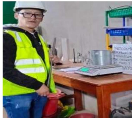
Vista 20: Figura 23. Ensayo de peso unitario y vacíos de los agregados
