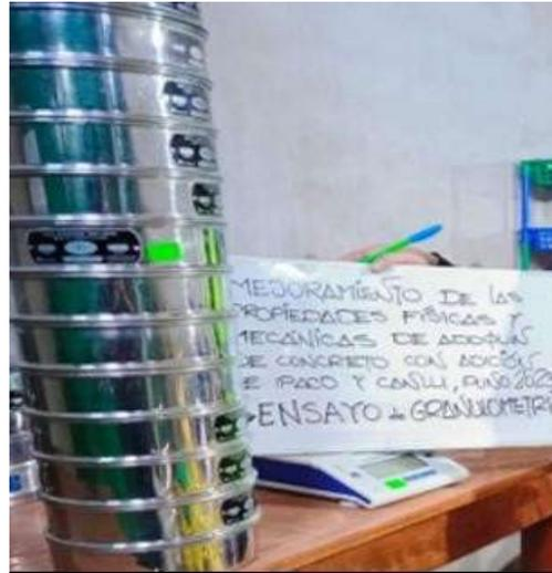
Vista 16: Se observa la realización del ensayo de granulometría
