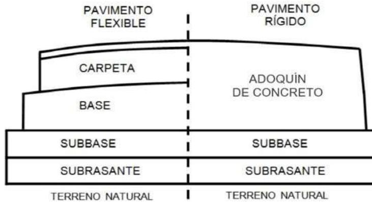
*Figura 5. Estructura de pavimento
