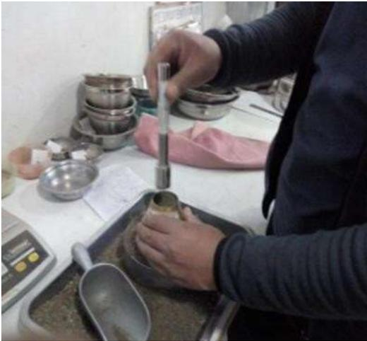
Vista 17: Figura 22. Ensayo de gravedad específica y absorción
