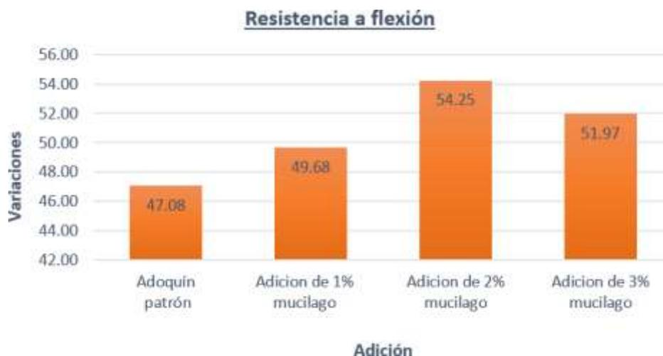
Figura 49. Resistencia a flexión del adoquín
