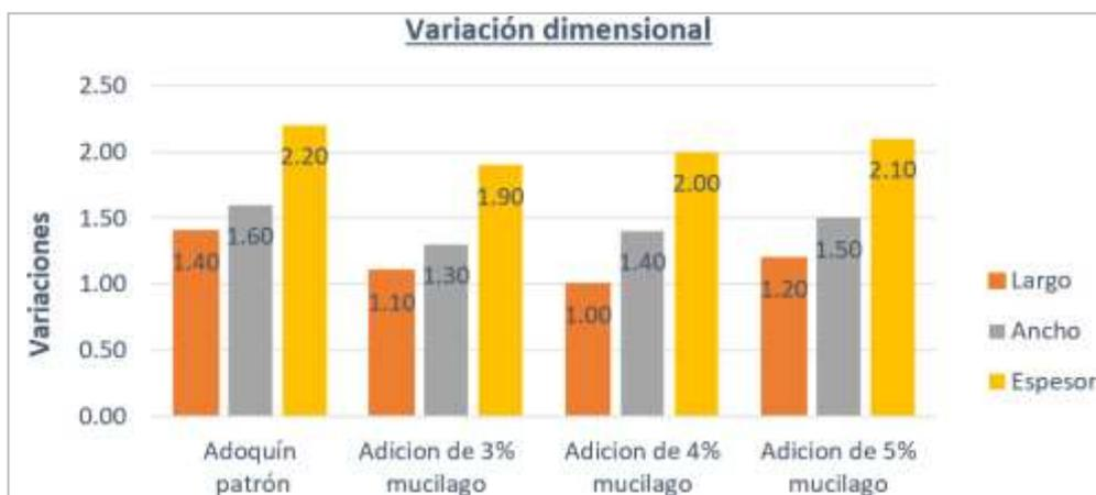
Figura 44. Variación dimensional del adoquín de ipaco y canlli
