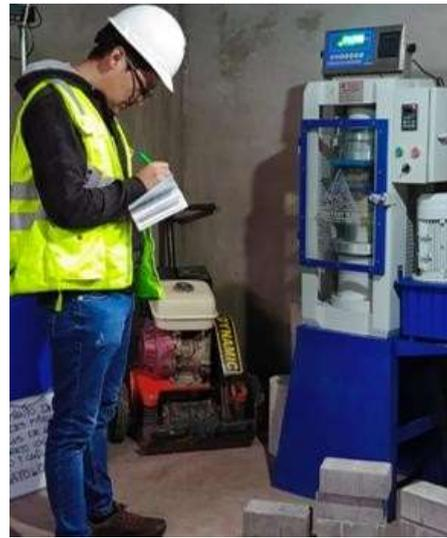
Vista 28: Se observa el ensayo de la resistencia a compresión
