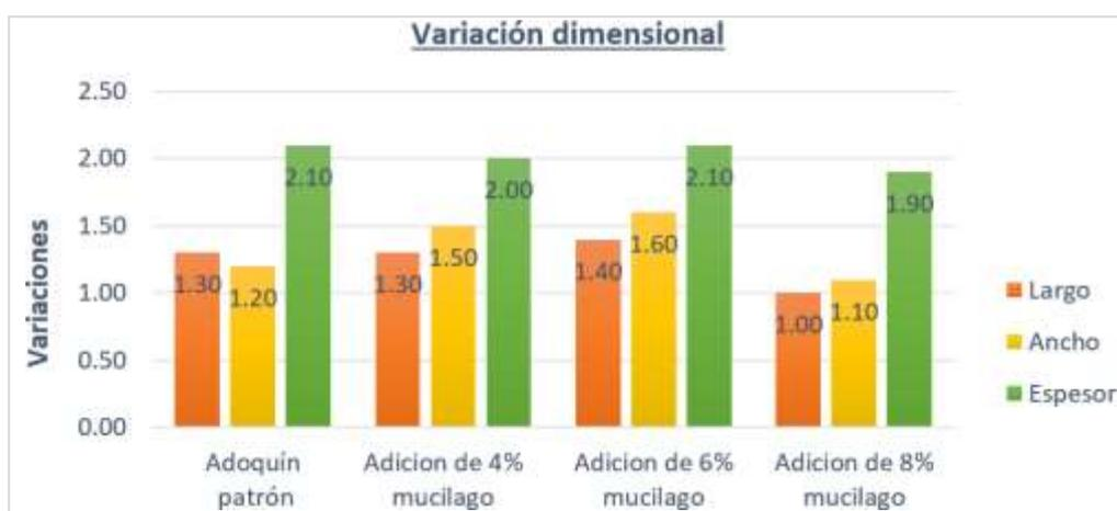
Figura 43. Variación dimensional del adoquín
