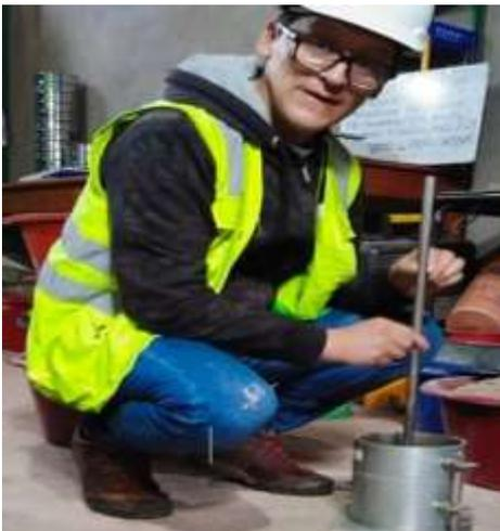
Vista 19: Figura 23. Ensayo de peso unitario y vacíos de los agregados
