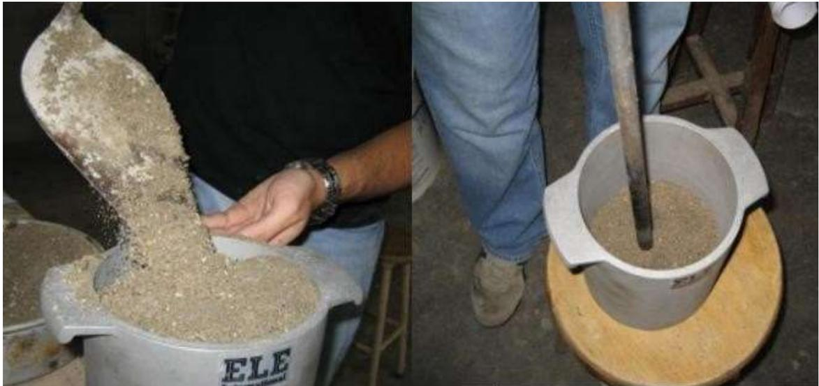
Figura 9. colocación de los agregados en sus respectivos moldes y varillado
