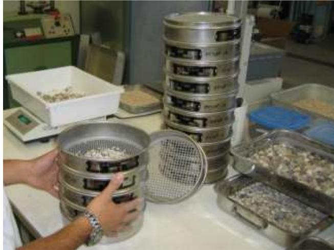
*Figura 7. Proceso de ensayo de granulometría
