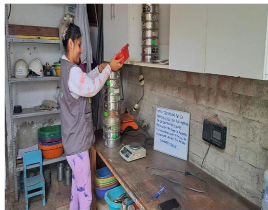
Análisis granulométrico de las muestras extraídas
