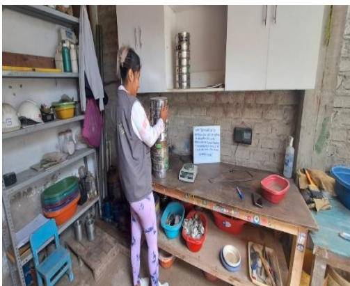
Análisis granulométrico de las muestras extraídas
