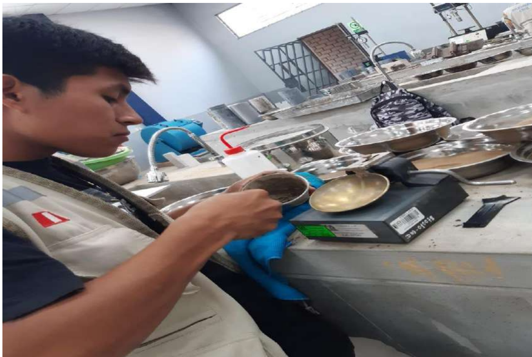
Figura 8. Laboratorio UCV, Chiclayo: Ensayo de límite de plasticidad, 2023
