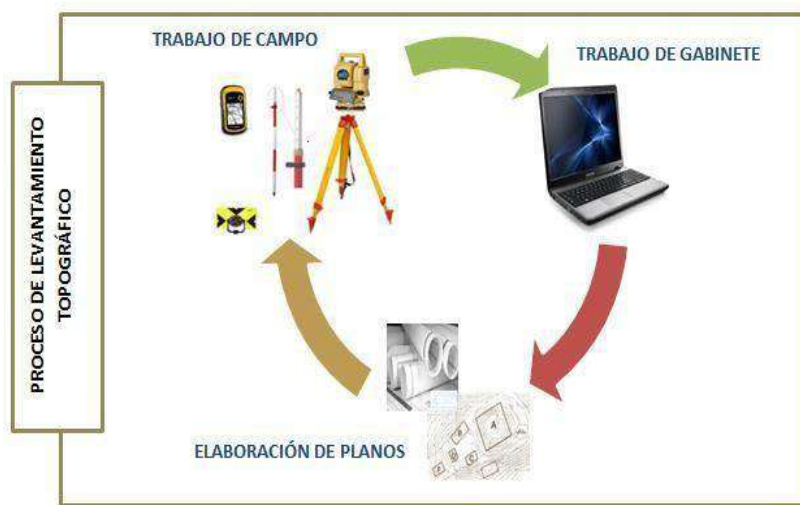
Figura 3: Procesos del levantamiento Topográfico, Jayanca 2023
