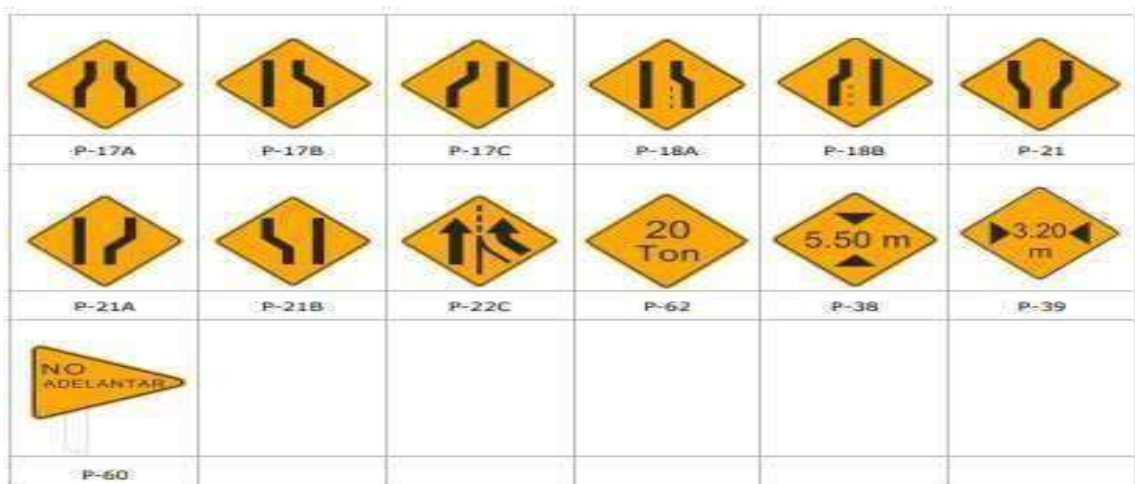
Figura 16. Señales preventivas por restricciones físicas de la vía
