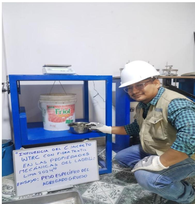
**Figura 2:** Ensayo del peso específico del agregado grueso.
