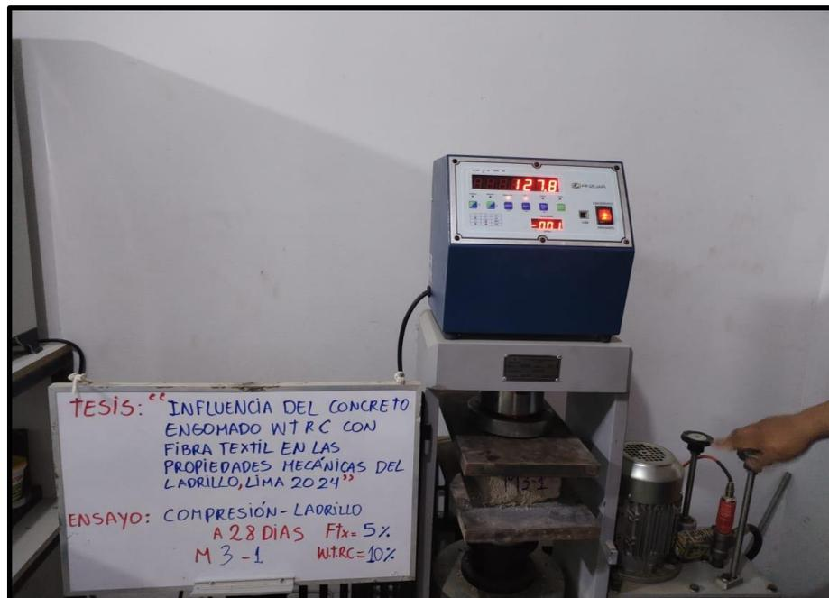
Figura 18. Carga aplicada sobre la unidad de albañilería.
