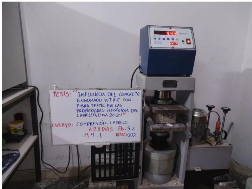
**Figura 18:** Ensayo de resistencia a la compresión de unidades de ladrillo
