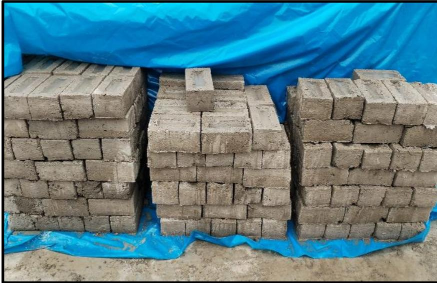
*Figura 16.* Proceso de curado de las muestras
