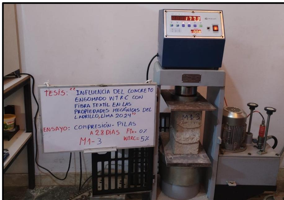
Figura 19. Carga aplicada sobre la pila de albañilería
