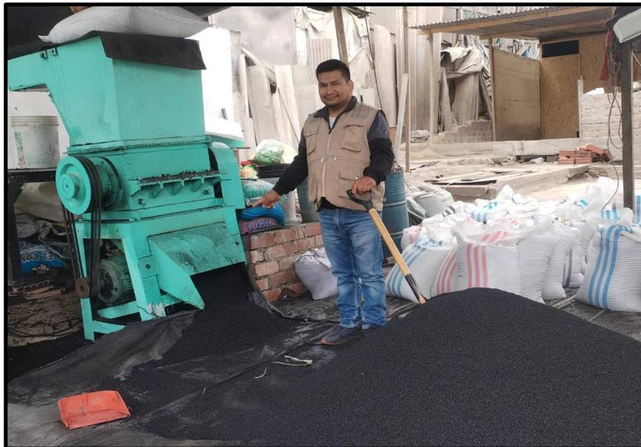
*Figura 4.* Proceso de trituración de neumáticos.
