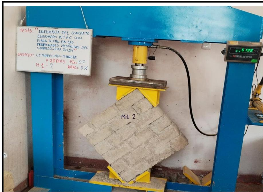
Figura 20. Carga diagonal aplicada sobre los muretes.
