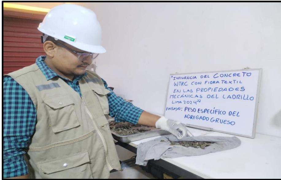
Figura 10. Secado del material luego de estar sumergido 24 horas. Luego de seguir los procedimientos indicados en la norma se obtuvo los resultados del laboratorio que es reflejado en la tabla 14.
