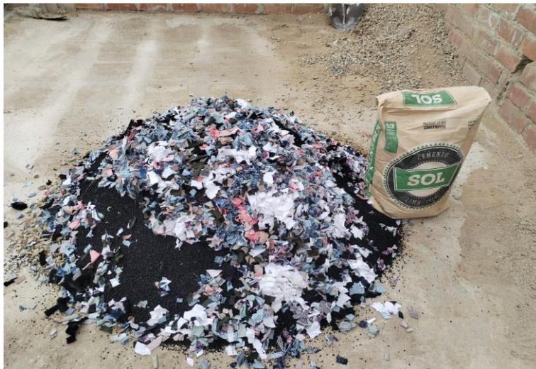
**Figura 6:** Dosificación por peso y volumen para la muestra de 5% de FTX + 10% WTCR
