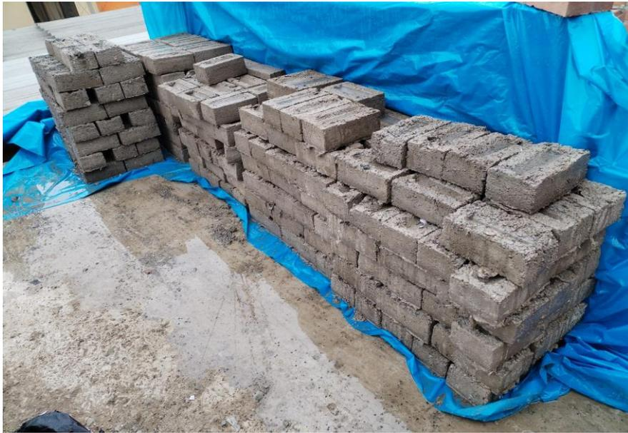
**Figura 12:** Proceso de curado de los ladrillos durante 28 días con bolsa plástica para mantener la humedad.
