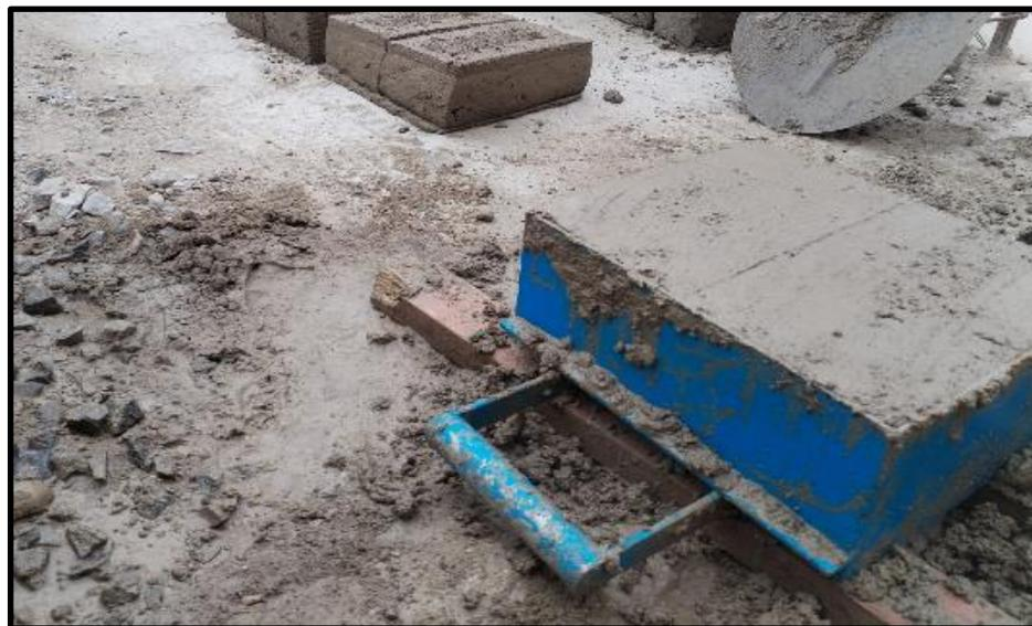
*Figura 12.* Proceso de fabricación del ladrillo M1
