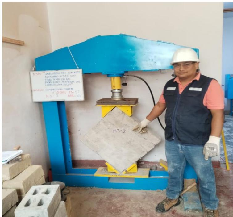
**Figura 20:** Ensayo de compresión diagonal de muretes de ladrillo.
