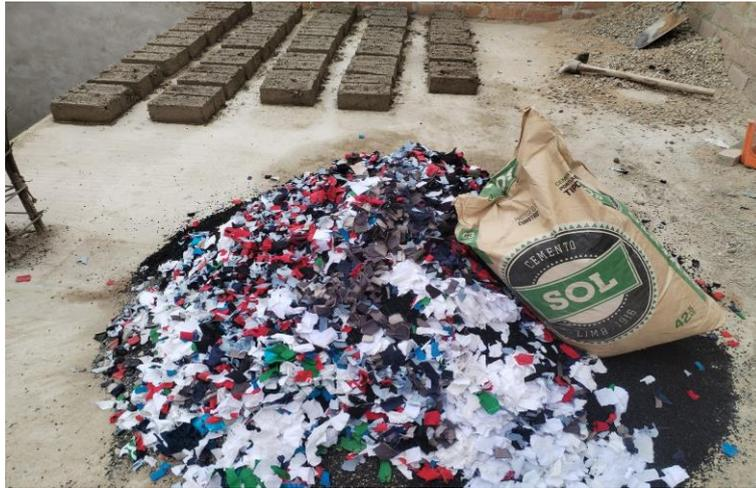
**Figura 7:** Dosificación por peso y volumen para la muestra de 5% de FTX + 20% WTCR.
