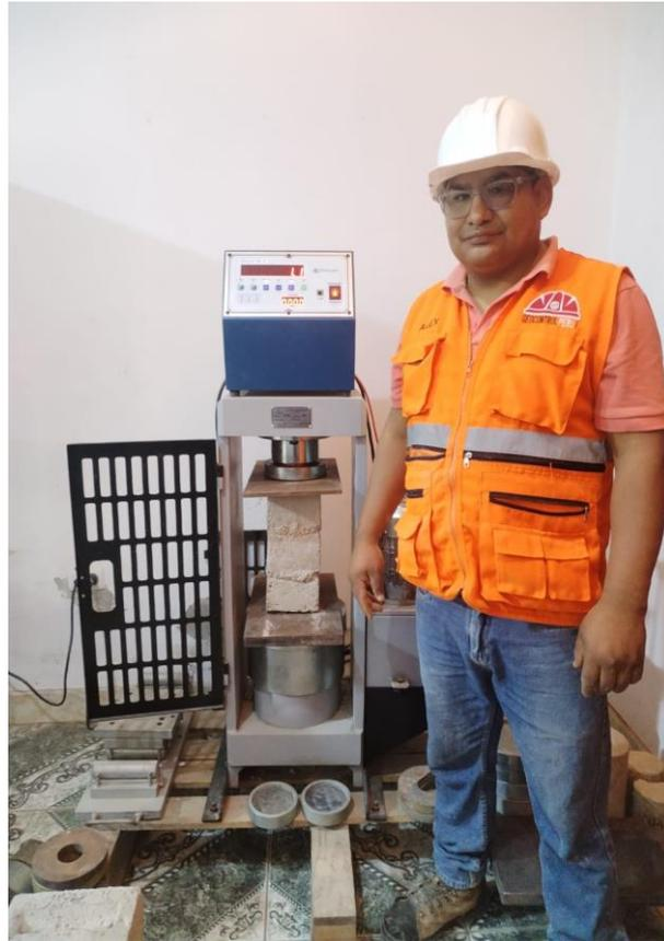
**Figura 19:** Ensayo de resistencia a la compresión de pilas de ladrillo
