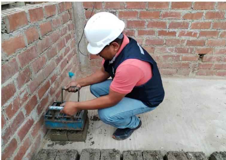
**Figura 10:** Proceso de desmoldamiento de los ladrillos.
