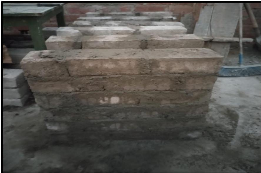
*Figura 17.* Fabricación de muretes de ladrillos.
