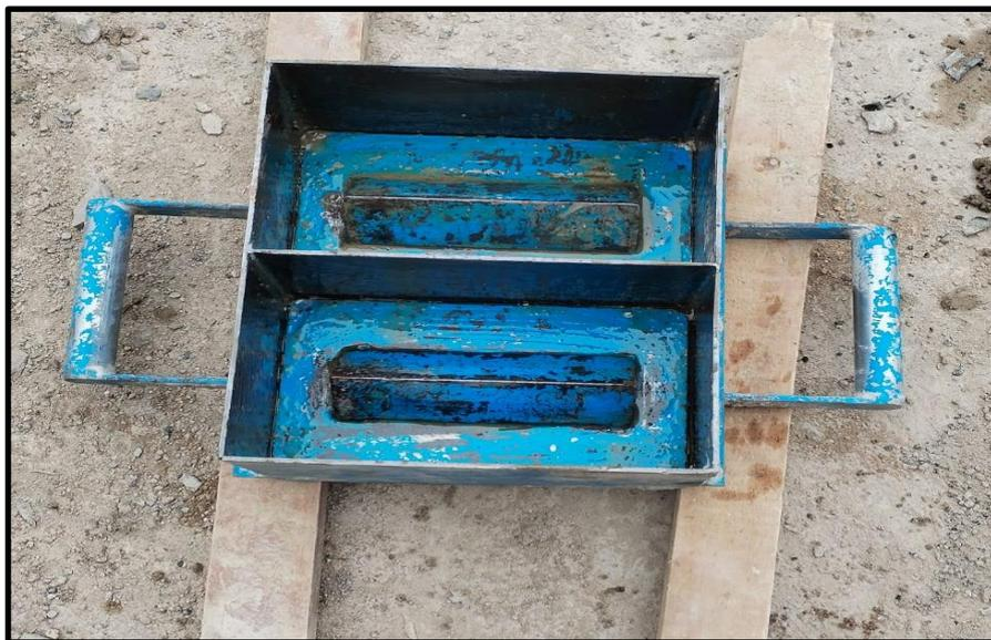
*Figura 11.* Molde para la fabricación del ladrillo de concreto.
