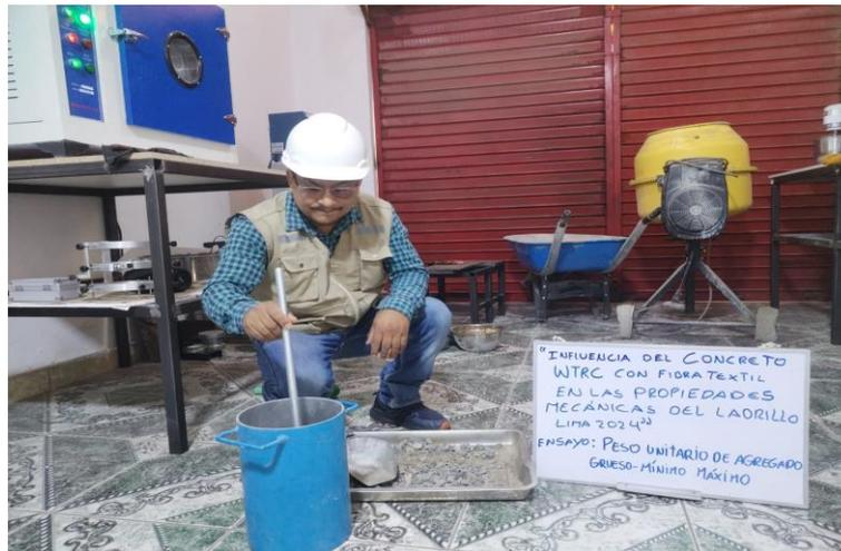
**Figura 1:** Ensayo del peso unitario del agregado grueso.
