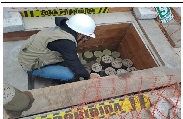
FECHA DE LA FOTOGRAFÍA 15 DE SET DEL 2023 Evidencia Fotográfica N° 23 Curado de probetas
