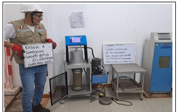
FECHA DE LA FOTOGRAFÍA 21 DE SET DEL 2023 Evidencia Fotográfica N° 24 Rotura de probeta - Resistencia a la compresión
