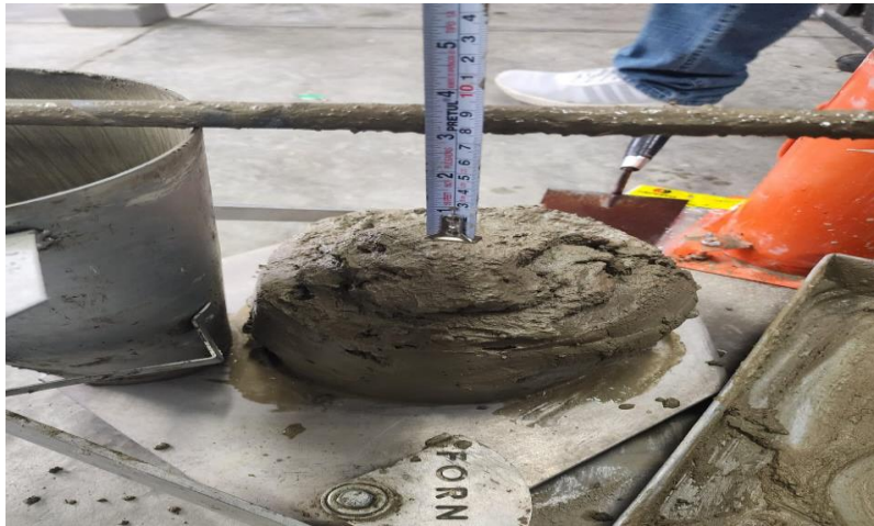
Figura 23. Asentamiento del concreto
