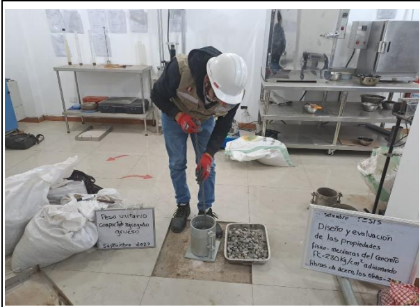
FECHA DE LA FOTOGRAFÍA 11 DE SET DEL 2023 Evidencia Fotográfica N° 07 Peso unitario compactado – agregado grueso
