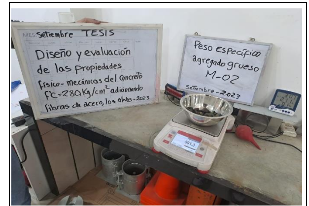
FECHA DE LA FOTOGRAFÍA 13 DE FEBR DEL 2023 Evidencia Fotográfica N° 10 Peso específico del agregado grueso.
