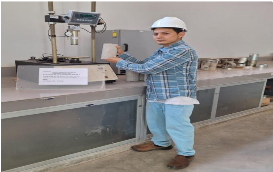
Figura 22. Ensayo de resistencia a compresión a los 7 días de la muestra, P+3% cerámica y vidrio reciclado Fuente: 2023, laboratorio de ingeniería civil, universidad cesar vallejo, distrito de Pimentel, provincia Chiclayo, departamento de Lambayeque
