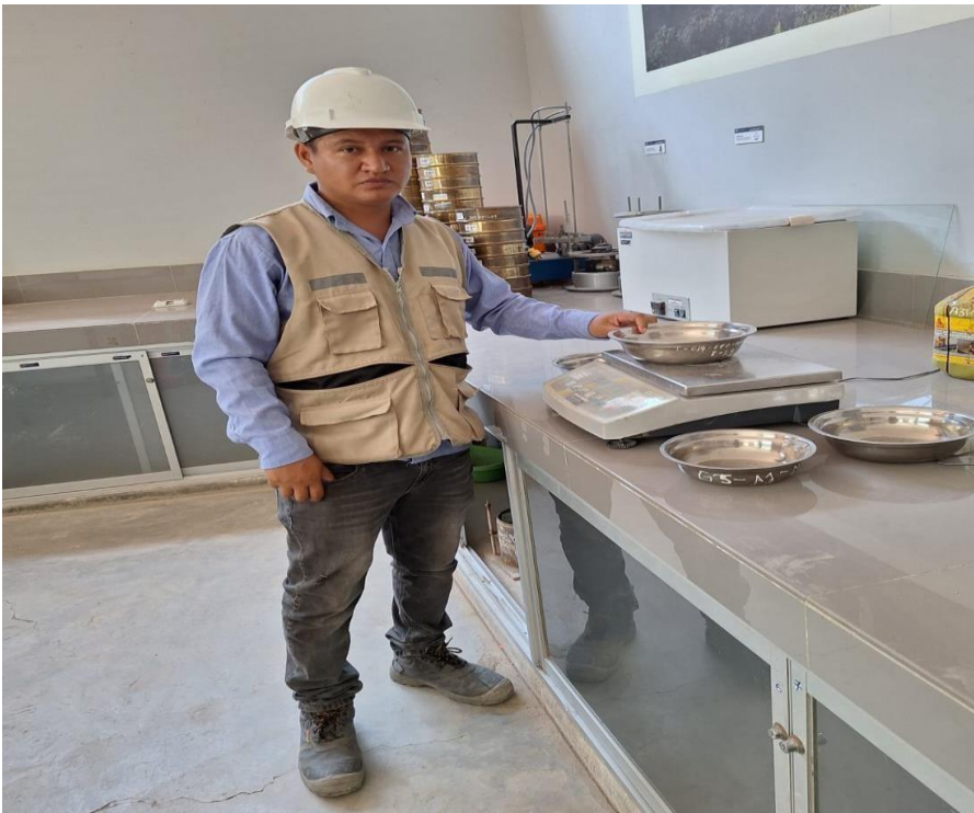
Figura 8. Peso específico del agregado grueso Fuente: Elaboración Propia, laboratorio de ingeniería civil, universidad cesar vallejo, distrito de Pimentel, provincia Chiclayo, departamento de Lambayeque
