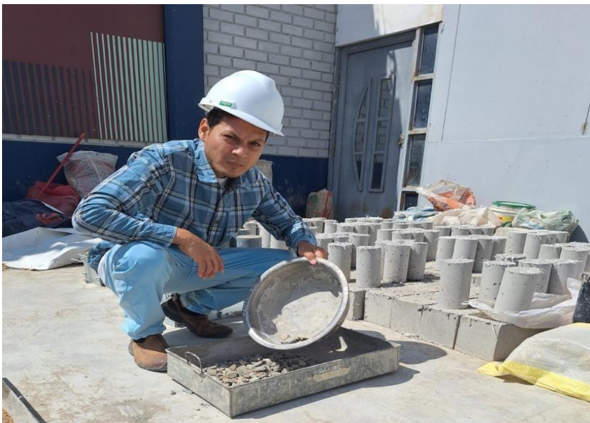
Figura 2. Cuarteo de material a ensayar del agregado grueso Fuente: 2023, laboratorio de ingeniería civil, universidad cesar vallejo, distrito de Pimentel, provincia Chiclayo, departamento de Lambayeque
