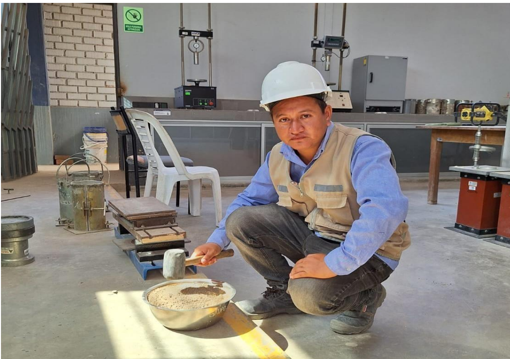
Figura 14. Trituración y selección del material para ensayos de laboratorio.
