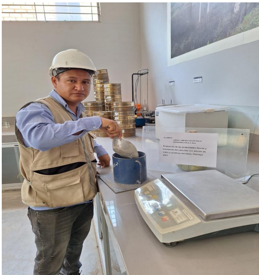
Figura 5. Ensayo de peso unitario del agregado fino Fuente:2023, laboratorio de ingeniería civil, universidad cesar vallejo, distrito de Pimentel, provincia Chiclayo, departamento de Lambayeque
