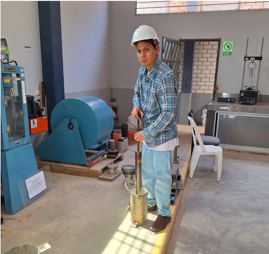
Figura 15. Trituración de vidrio con equipo Proctor modificado Fuente: 2023, laboratorio de ingeniería civil, universidad cesar vallejo, distrito de Pimentel, provincia Chiclayo, departamento de Lambayeque
