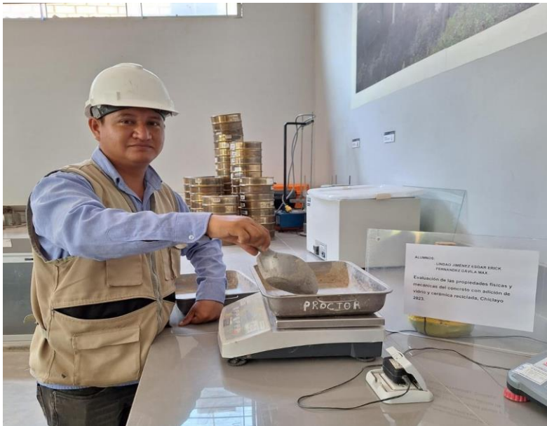
Figura18. Pesado del agregado grueso Fuente: 2023, laboratorio de ingeniería civil, universidad cesar vallejo, distrito de Pimentel, provincia Chiclayo, departamento de Lambayeque
