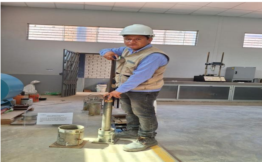
Figura 16. Trituración de cerámica con equipo Proctor modificado Fuente: 2023, laboratorio de ingeniería civil, universidad cesar vallejo, distrito de Pimentel, provincia Chiclayo, departamento de Lambayeque
