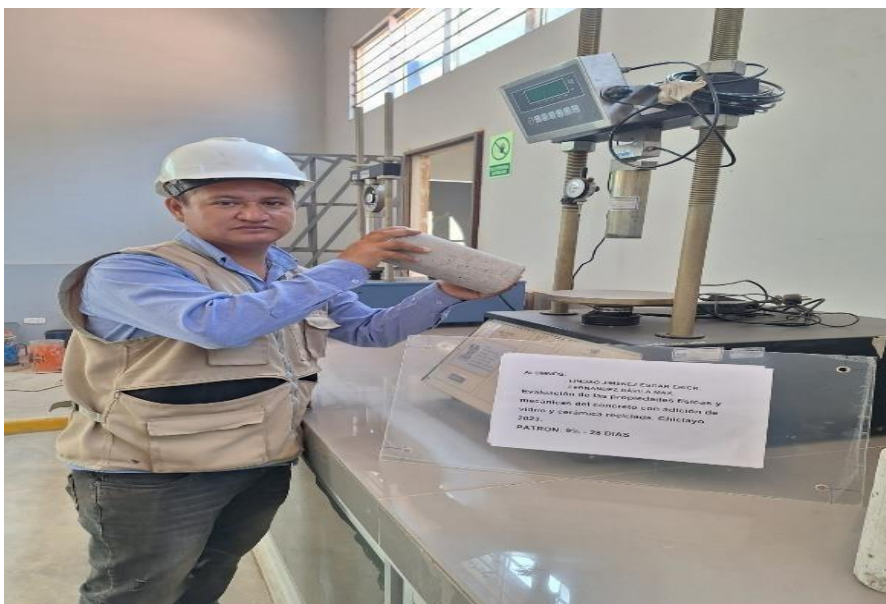
Figura 24. Ensayo de resistencia a la compresión a los 28 días de la muestra P+9% cerámica y vidrio reciclado
