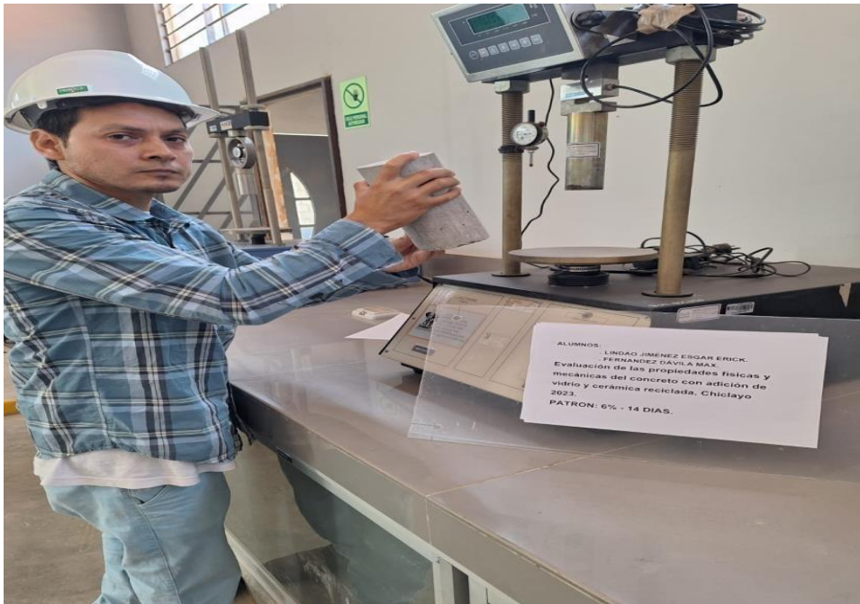
Figura 23. Ensayo de resistencia a la compresión a los 14 días de la muestra P+6% cerámica y vidrio reciclado
