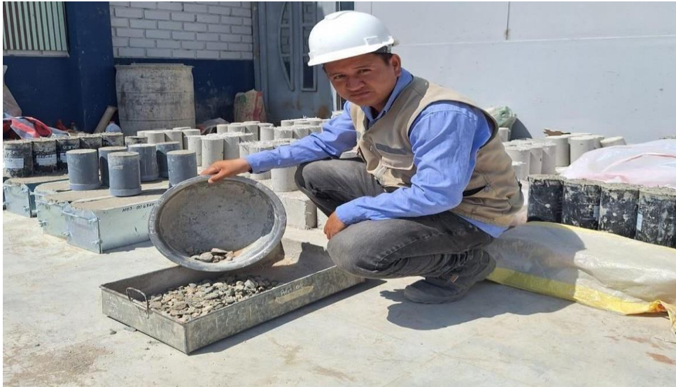
Figura 3. Material del agregado para ensayo granulométrico Fuente: 2023, laboratorio de ingeniería civil, universidad cesar vallejo, distrito de Pimentel, provincia Chiclayo, departamento de Lambayeque
