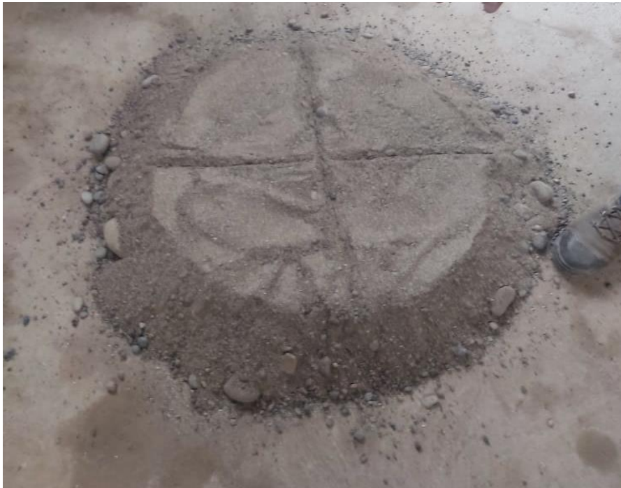
Figura 1. Cuarte de material a ensayar del agregado fino Fuente: 2023, laboratorio de ingeniería civil, universidad cesar vallejo, distrito de Pimentel, provincia Chiclayo, departamento de Lambayeque
