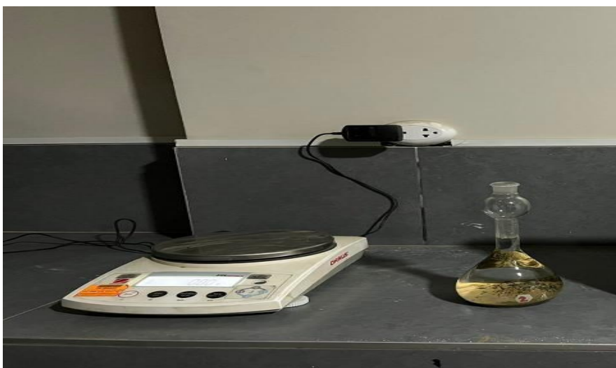
Figura 6. Ensayo del peso específico y absorción del agregado fino Fuente: 2023, laboratorio de ingeniería civil, universidad cesar vallejo, distrito de Pimentel, provincia Chiclayo, departamento de Lambayeque
