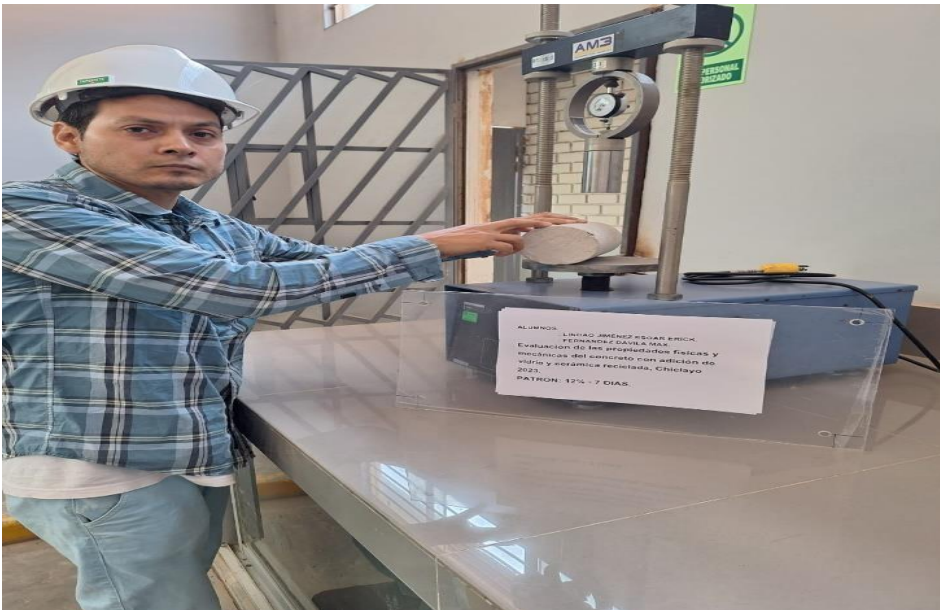
Figura 26. Ensayo de resistencia a la tracción a los 7 días de la muestra P+12% cerámica y vidrio reciclado Fuente: 2023, laboratorio de ingeniería civil, universidad cesar vallejo, distrito de Pimentel, provincia Chiclayo, departamento de Lambayeque
