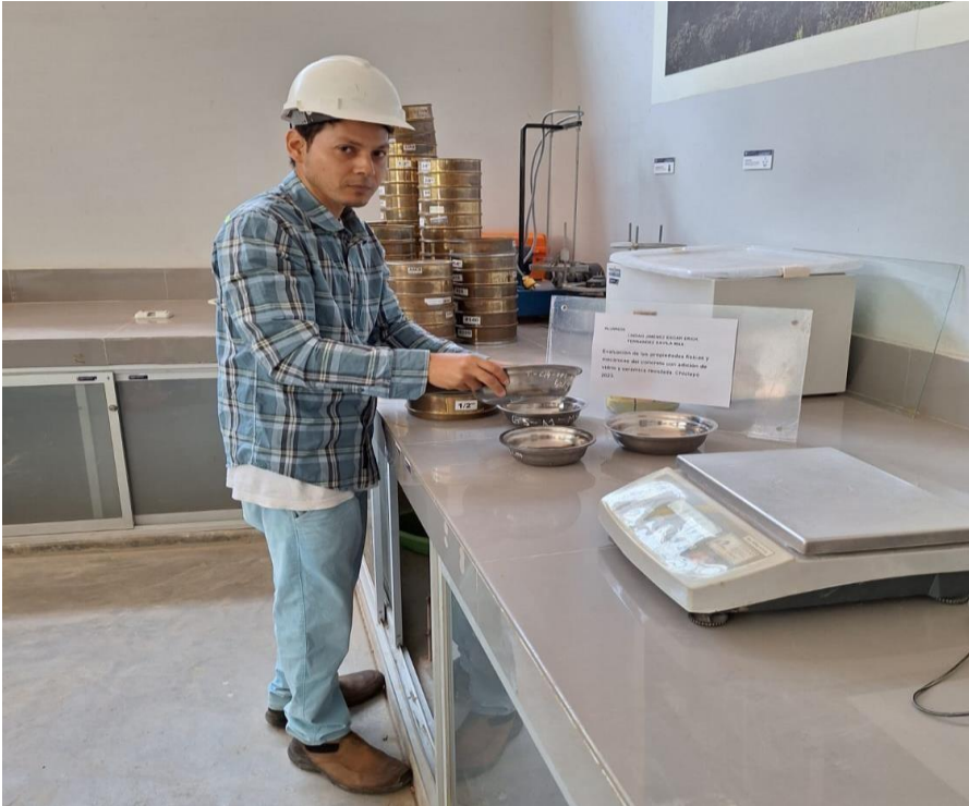
Figura 7. Material para peso específico del agregado grueso Fuente: 2023, laboratorio de ingeniería civil, universidad cesar vallejo, distrito de Pimentel, provincia Chiclayo, departamento de Lambayeque
