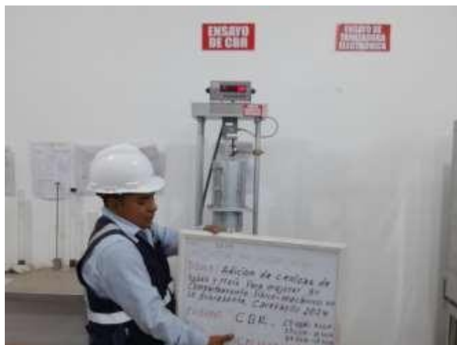
Figura 20. Ensayo de CBR
