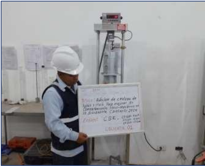
Figura 18. Ensayo de CBR para identificar del grado de soporte de las muestras más la incorporación de aditivos.
