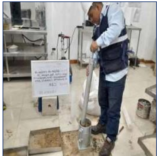
Figura 17. Ensayo Proctor modificado para evaluar el grado de compactación.
