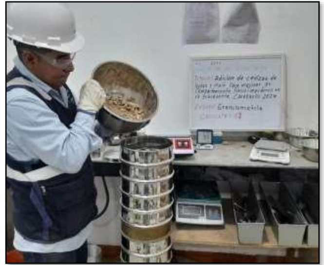
Figura 14. Análisis granulométrico a las muestras para cada calicata.
