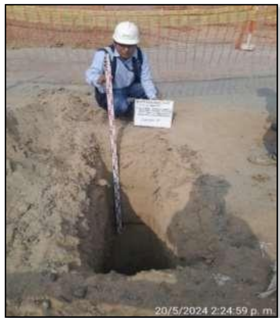
Figura 12. Excavación para la calicata 2.
