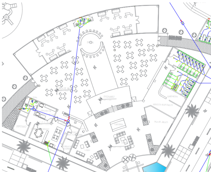
Figura N° 66: Plano de instalaciones desagüe restaurante - Elaboración propia
