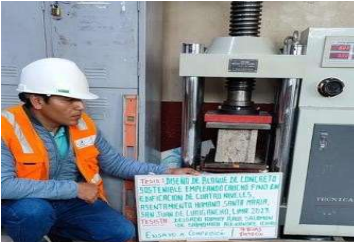
Fotografía: Patrón ensayo a compresión.
