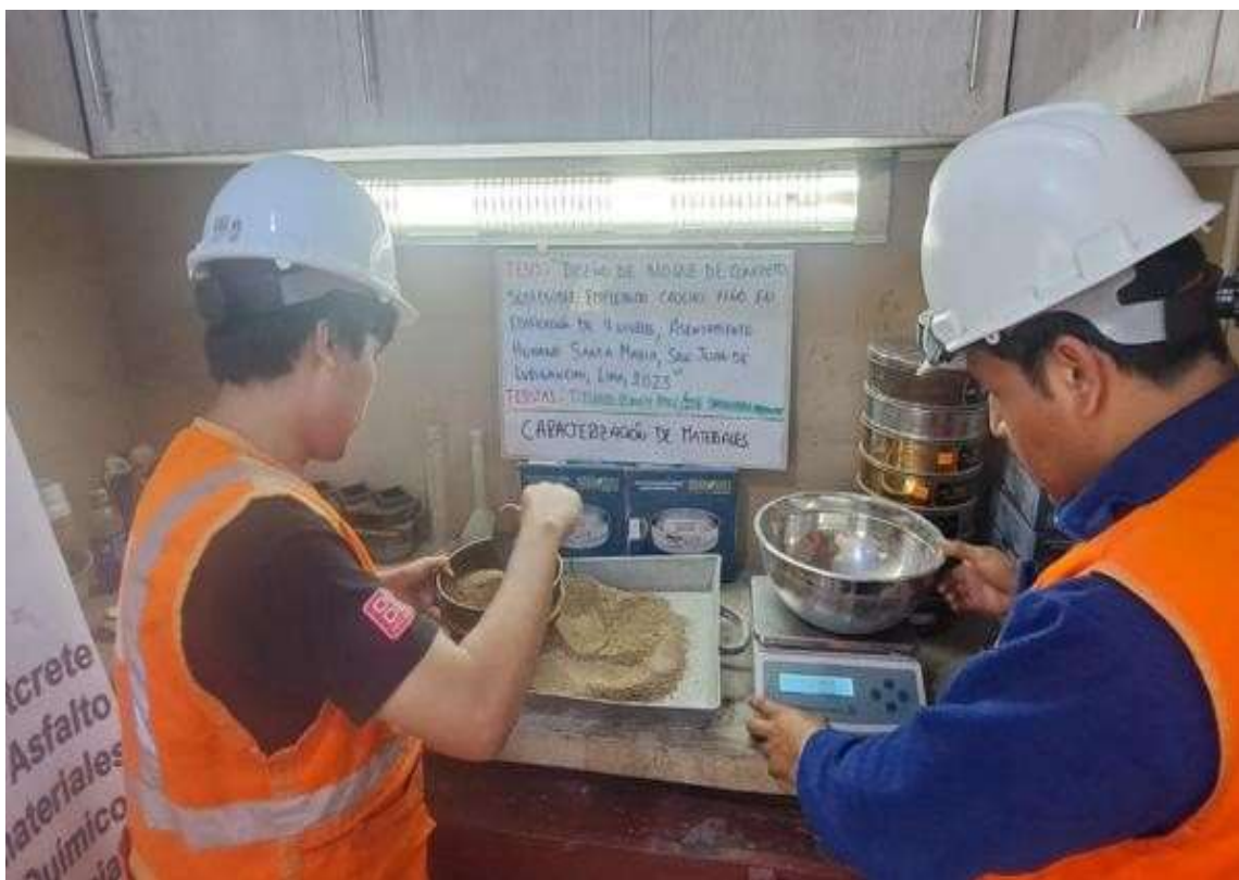
Fotografía: Ensayo, balanza, agregado fino para insumo de mezcla en la elaboración de bloque de concreto.
