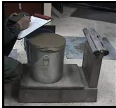
Figura 9. Prueba de peso unitario
