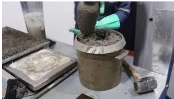
Figura 17. Prueba de peso unitario del concreto.
