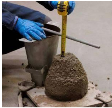
Figura 16. Prueba de consistencia del concreto.
