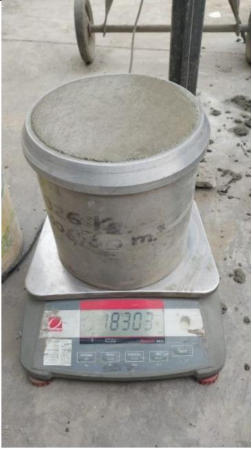
Ensayo de densidad del concreto
