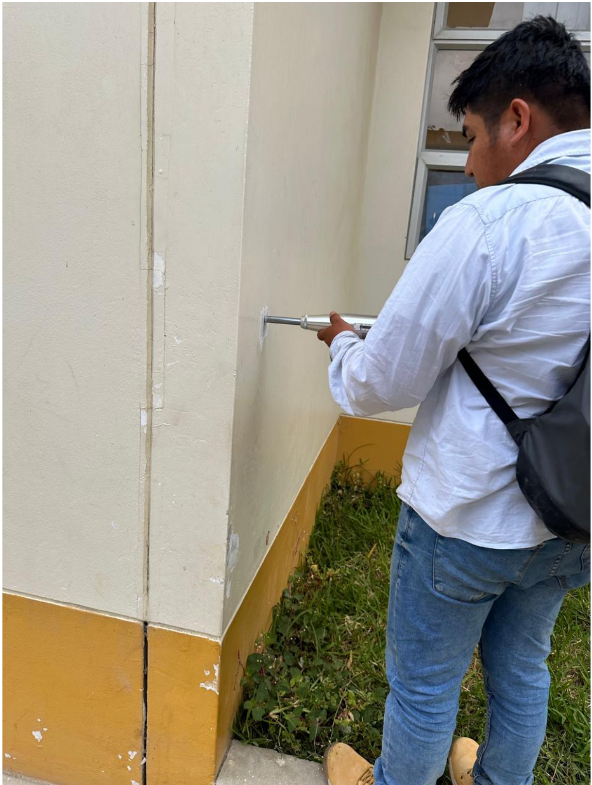
Figura 84: Ensayo de esclerómetro en placa
