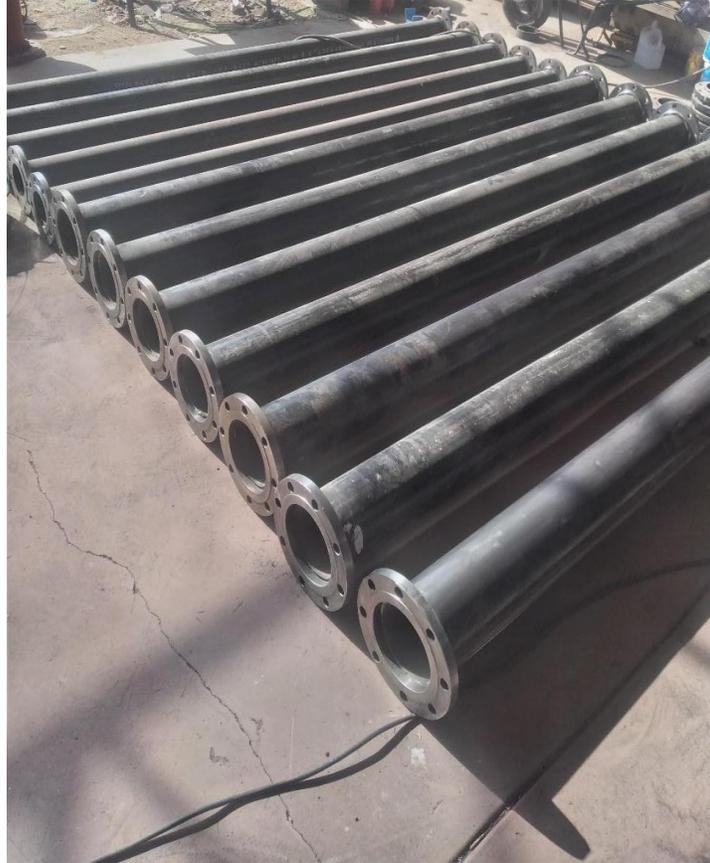
*Figura 6.* Armado y soldado de tuberías
