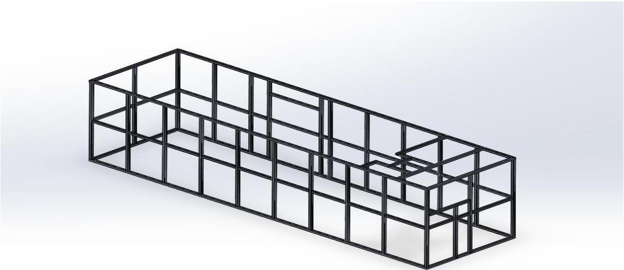
*Figura 16.* Estructura de acero ASTM A36
