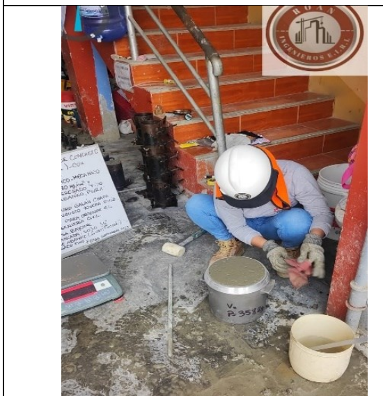
Llenado de muestras, contenido de aire y slump.
