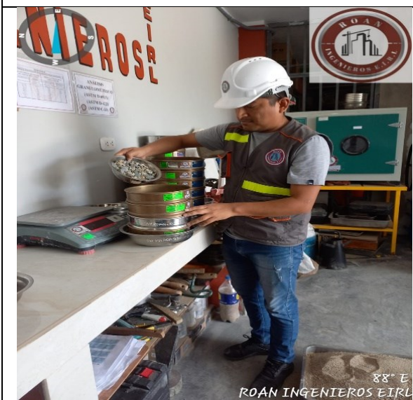
Selección de agregados y realización de ensayos correspondientes según norma.
