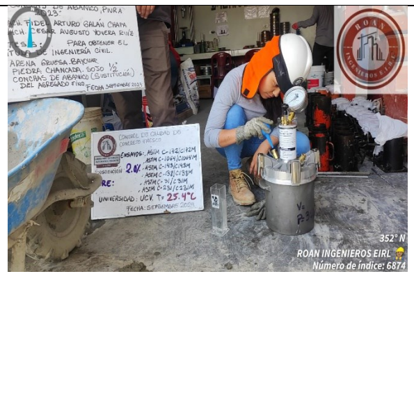
Llenado de muestras, contenido de aire y slump.
