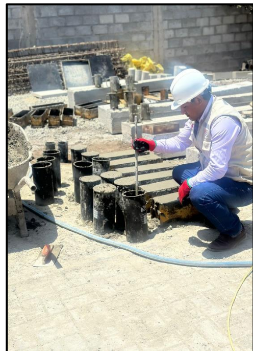
Colocación del concreto en 3 capas, dando 25 golpes por cana.
