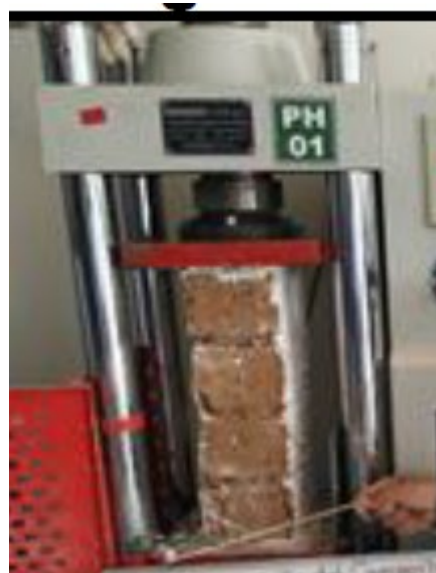
Figura 28. Ensayo de pila a compresión Fuente: (TTITO, y otros, 2021 pág. 42)
