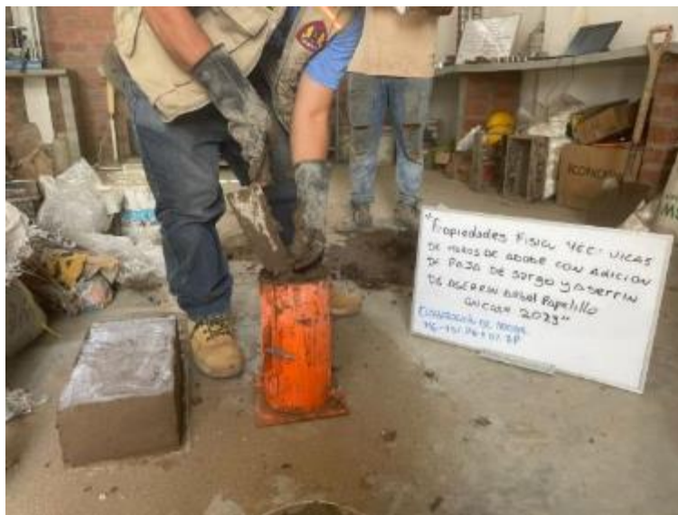
Figura 38. Relleno de moldes con material de suelo y adicionados.
