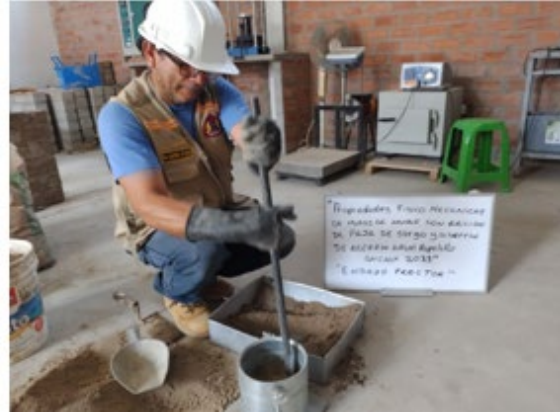
Compactación del molde para proctor modificado ASTM D1557
