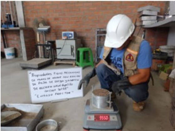
Pesado de muestra enrasada, vaciado y preparación de otra muestra con diferente porcentaje de humedad, el proceso fue realizado para 4 muestras.
