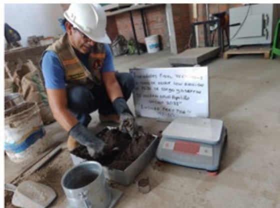
Pesado de muestra enrasada, vaciado y preparación de otra muestra con diferente porcentaje de humedad, el proceso fue realizado para 4 muestras.
