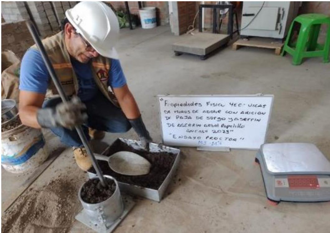
Figura 52. Proctor modificado-chuceado 25 golpes.
