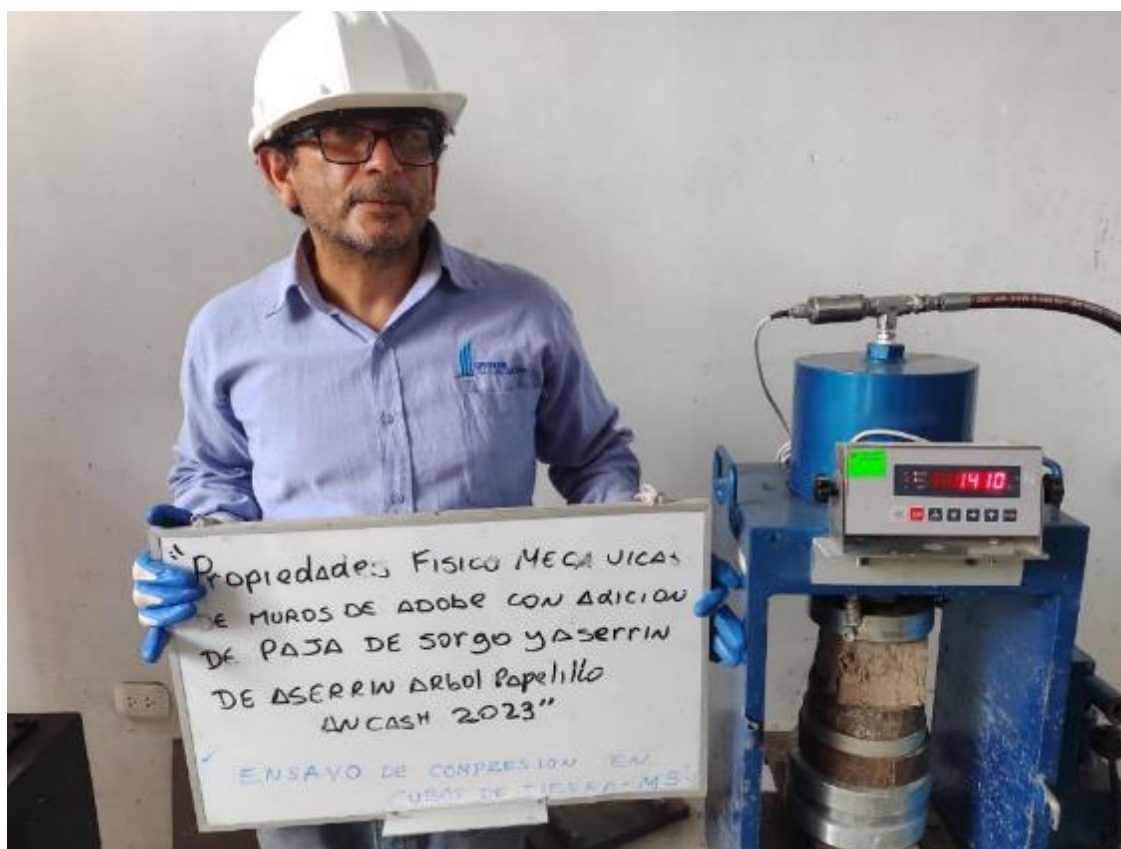
Figura 67. Compresión de cubos de adobe de 0.10x0.10x0.10m
