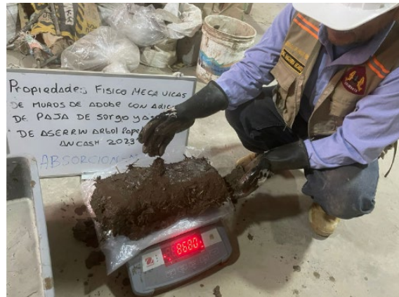
Medición del peso del adobe retirado de la bandeja después de absorber agua.
