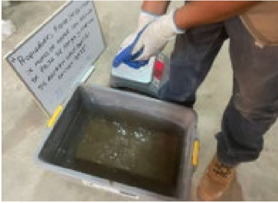
Burbujeo en la bandeja por absorción de agua.
