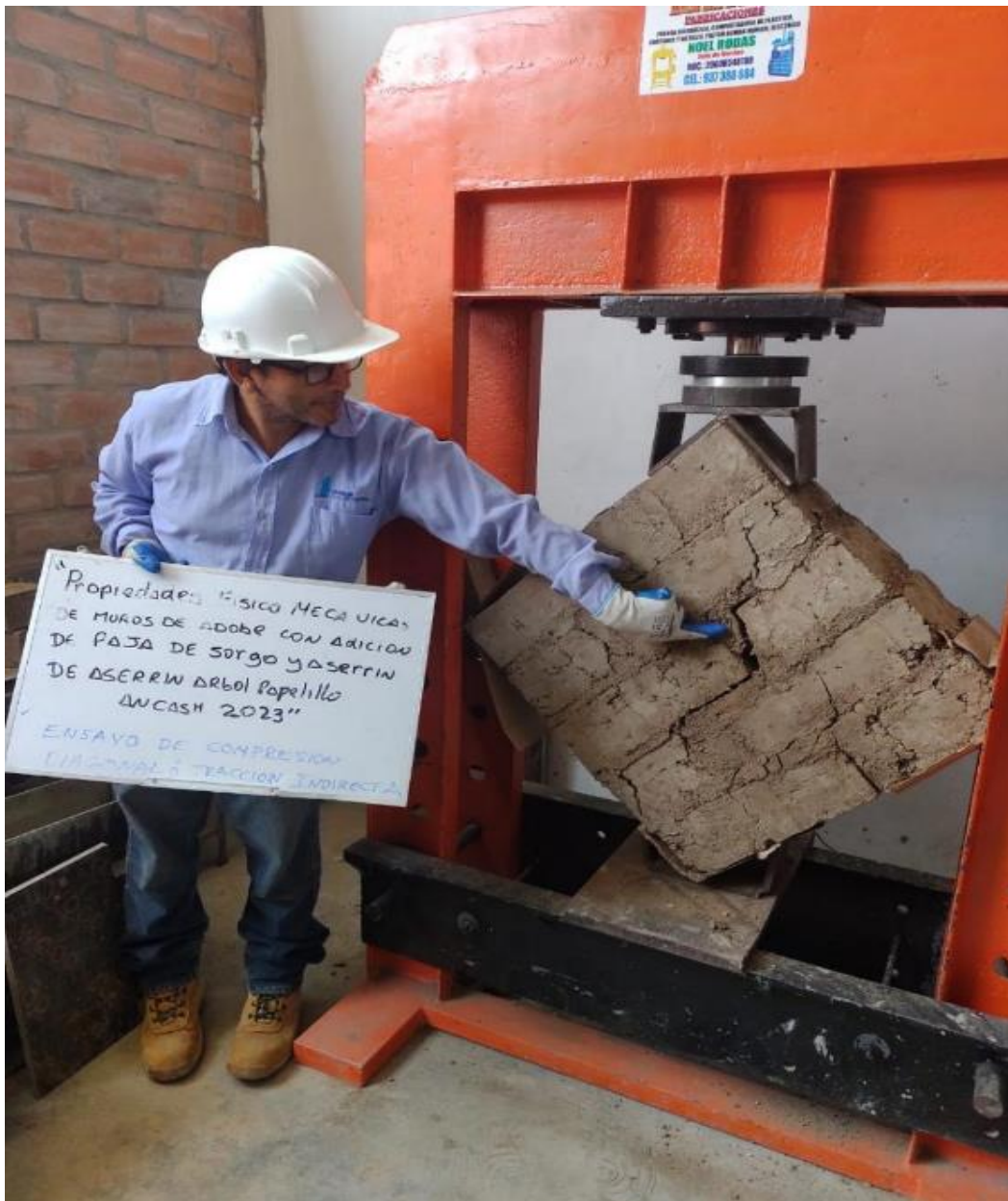
Figura 72: Ensayo a tracción indirecta por compresión diagonal o diametral realizado sobre muro de adobes.
