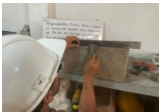
Figura 58. Inserción de la cuña entre la regla y el adobe para medir alabeo en cada cara opuesta, arriba forma convexa, abajo forma cóncava.
