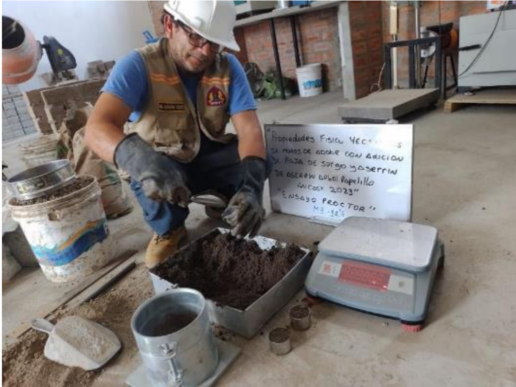
Figura 51. Proctor modificado-relleno de taras con suelo humedecido.
