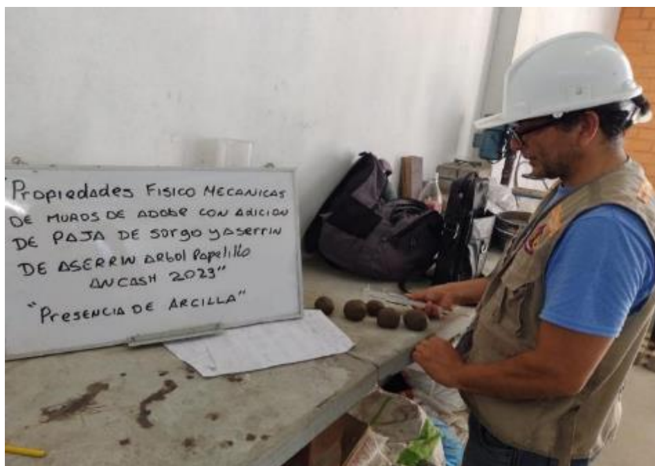
Figura 46. Medición de bolitas de tierra.
