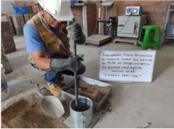
Compactación del molde para proctor modificado ASTM D1557
