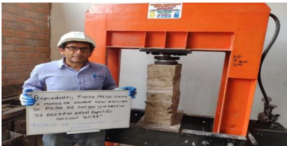
Figura 74. Resistencia de pilas a compresión axial para determinar Rmuc.
