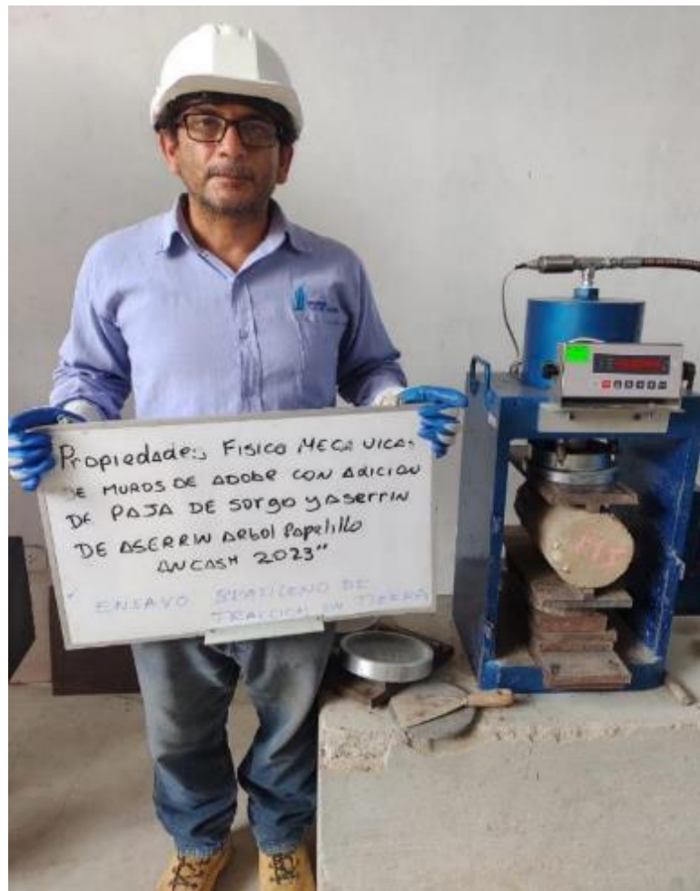
Figura 69. Probeta cilíndrica de adobe sometida a tracción diagonal por compresión lateral de un plano conformada por varillas metálicas.
