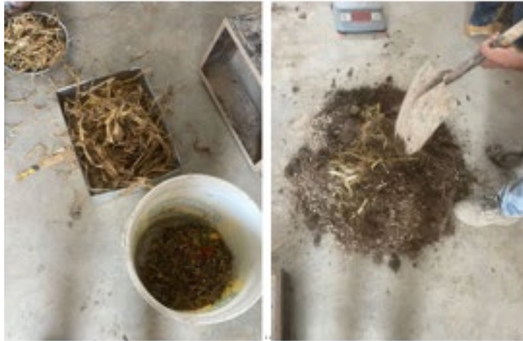
Figura 37. Dosificación y mezclado con suelo
