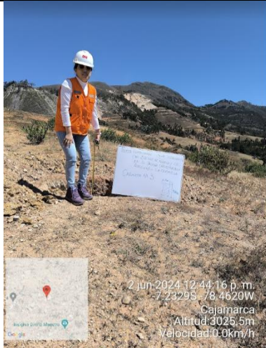
Imagen 9. Verificando la profundidad de 1.50 m de la Calicata N ° 3 en la prog 3+00 Km.
