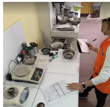
Imagen 56. Saca las muestras de horno, luego se hace pesada hasta 3 pesadas hasta que sea lo mismo, esto para su contenido de humedad (optimo contenido de humedad y máxima densidad) y se anota en la ficha de trabajo.
