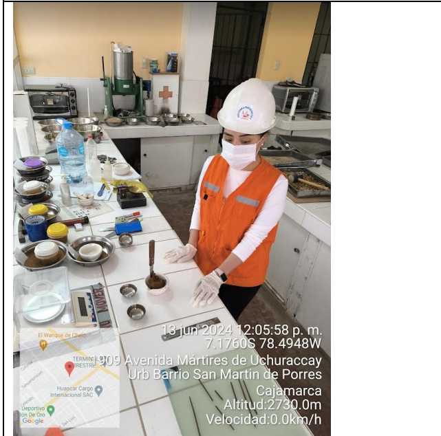
Imagen 46. Realizando límite plástico– Límites de Atterberg
