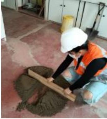
Imagen 28. La muestra se vuelve homogenizar y se cuartea y selecciona una parte de esa muestra y lo demás se desecha.
