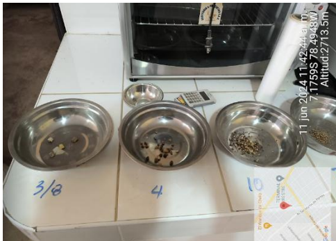
Imagen 32. Para hallar la Masa inicial húmeda <math><N^{\circ}4</math>, se selecciona una porción menor de 200g de la muestra cernida, Masa inicial húmeda >
