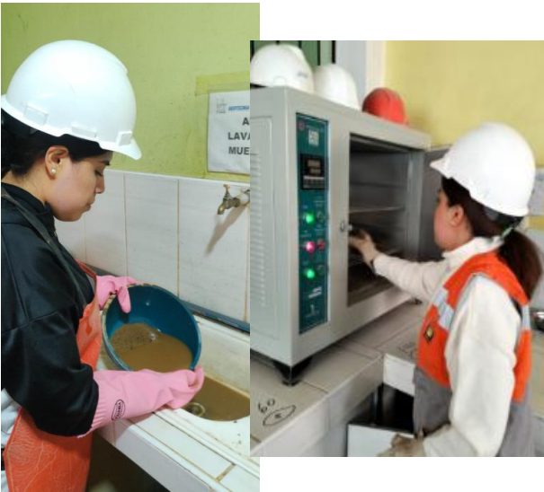
Imagen 32. Para hallar la Masa inicial húmeda <math><N^{\circ}4</math>, se selecciona una porción menor de 200g de la muestra cernida, Masa inicial húmeda >
