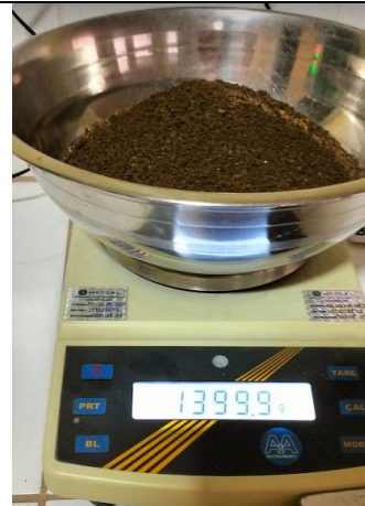
Imagen 29. La muestra seleccionada se lleva a la bandeja. Pero, antes se pesa la muestra, y luego se registra en la hoja de trabajo en: Masa inicial húmeda <math>< 3/4''</math>, se empieza a cernir con la malla N.º 4
