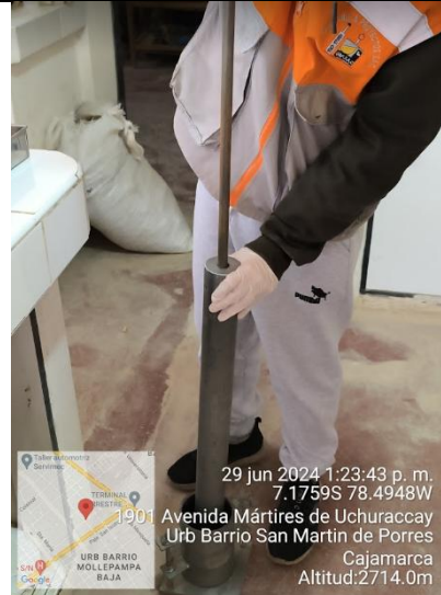
Imagen 54. Se llena 1/3 del Proctor y luego con la varilla se golpea 25 golpes .
