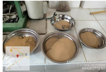
Imagen 31. Resultado de pasar por los tamices, N ° 4 y 3/8", N ° 10.
