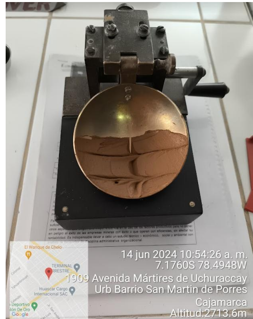
Imagen 43. Se mezcla con agua para lograr la consistencia adecuada y cerrar la ranura del suelo con 25-35 golpes, luego se coloca y nivela en la cazuela, evitando burbujas de aire y devolviendo el excedente al recipiente para mantener
