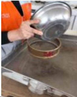
Imagen 30. Luego se cernir en la malla N ° 4, se pesa, sin tara, y se coloca en la ficha de trabajo de Masa inicial húmeda > N°4. Después se empieza a cernir con la malla 3/8" , N°4 y N°10 por ultimo.
