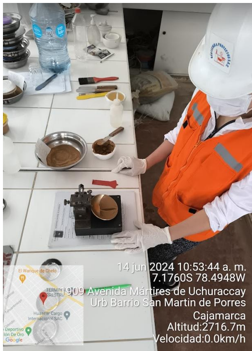
Imagen 42. Realizando límite líquido – Límites de Atterberg
