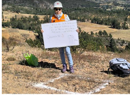
Imagen 7. Señalización de la Calicata N ° 3 que es de 1m x1m x1.50 m.
