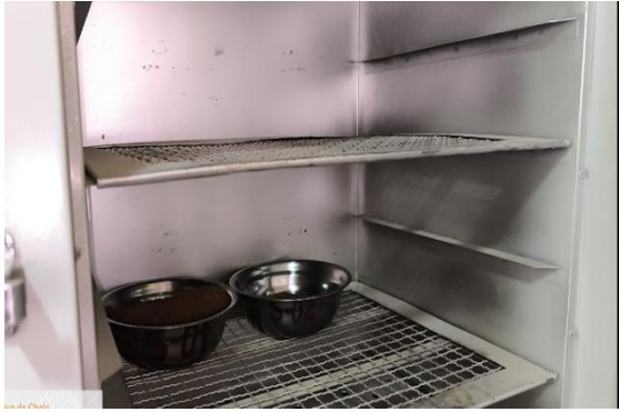
Imagen 40. Muestra de contenido de humedad de calicata N °: 1 ,2,3,4 y 5.
