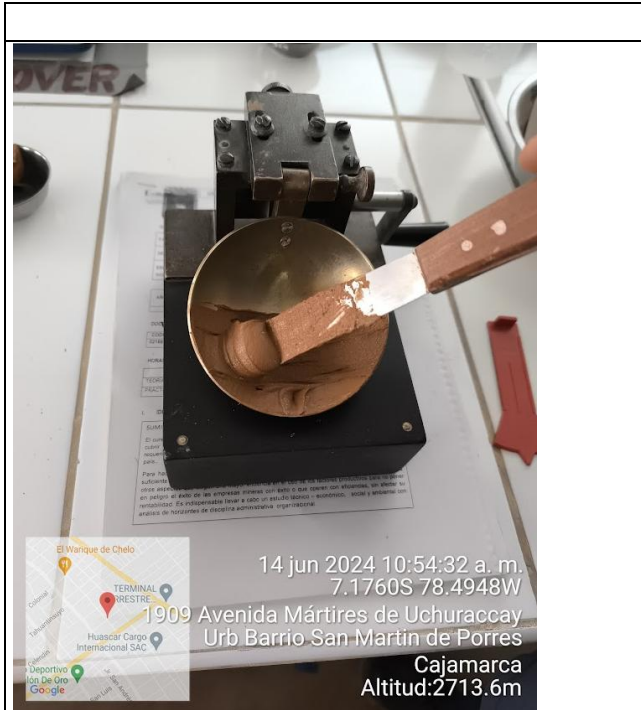
Imagen 44. Se procede a sacar una pequeña muestra donde se acerrado, luego lo pesas y llevas al horno 12 horas como mínimo y máximo 24 horas para luego sacar su contenido de humedad.
