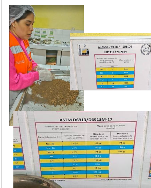
Imagen 22. Procedemos a testear el suelo y lo trituramos entre nuestros dedos y seleccionamos de acuerdo con norma ASTM-2216-2019 a
