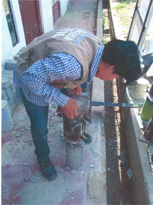
MOLDEO DE PROBETAS PARA LOS ENSAYOS DE FLEXIÓN
