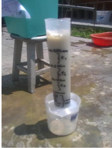
Fuente: elaboración propia Imagen 10: Prueba de permeabilidad (inicio)
