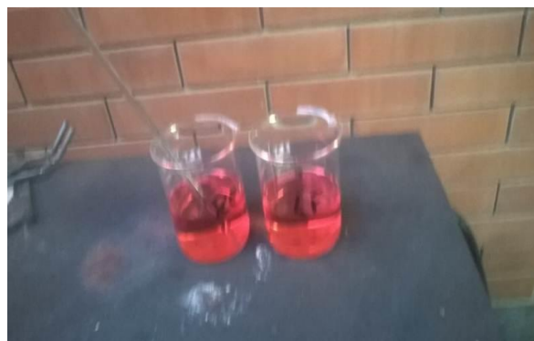
Fuente: elaboración propia Imagen 19: adición de ácido clorhídrico a la muestra
