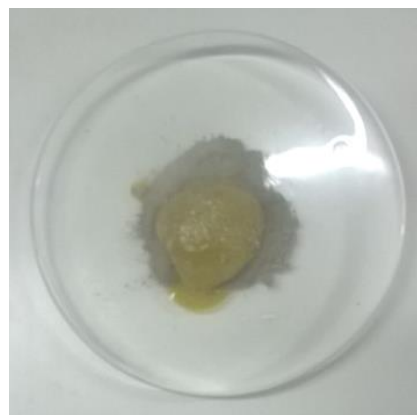
fuelle: elaboración propia Imagen 26: muestra de Adoquín con la adición de HCl
