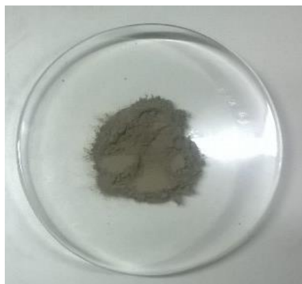
fuelle: elaboración propia Imagen 25: muestra de Adoquín sin la adición de HCl
