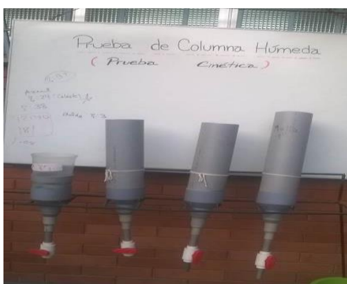
Fuente: elaboración Propia Imagen 27: columnas de lixiviación
