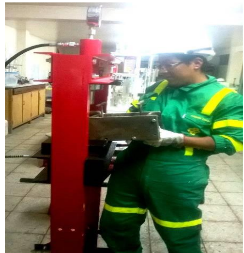
Fuente: elaboración propia Imagen 24: mezcla sometido en la prensa
