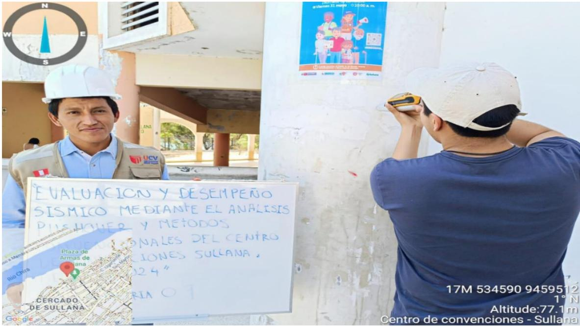
Ensayo de esclerometría (columna c-9)
