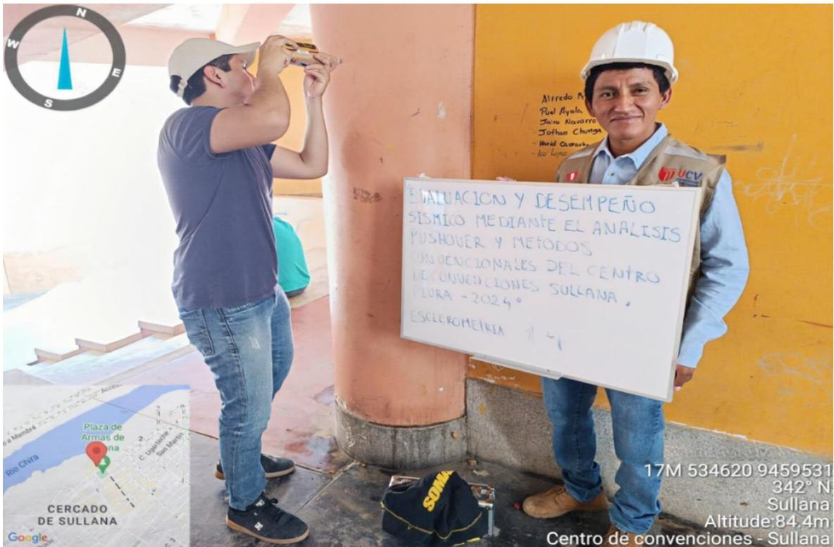
Ensayo de esclerometría (columna c-14)
