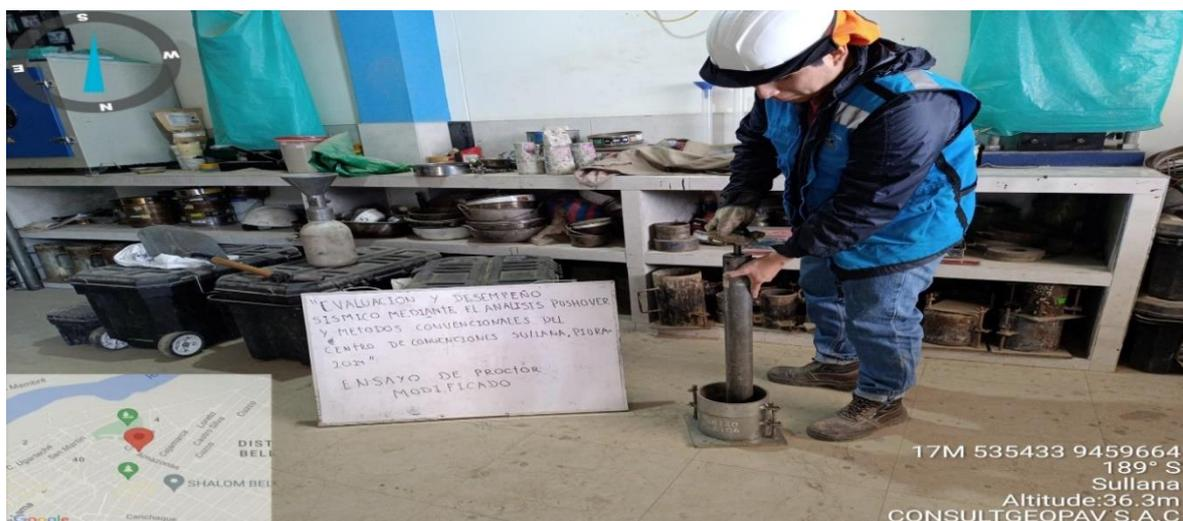
La imagen responde a la fase de ensayo de Proctor modificado en laboratorio, realizada como parte de la investigación. El trabajo fue ejecutado por Consultgeopav S.A.C.
