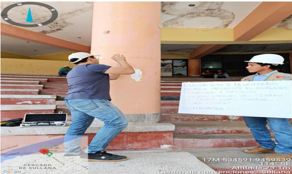
Ensayo de esclerometría (columna c-4)
