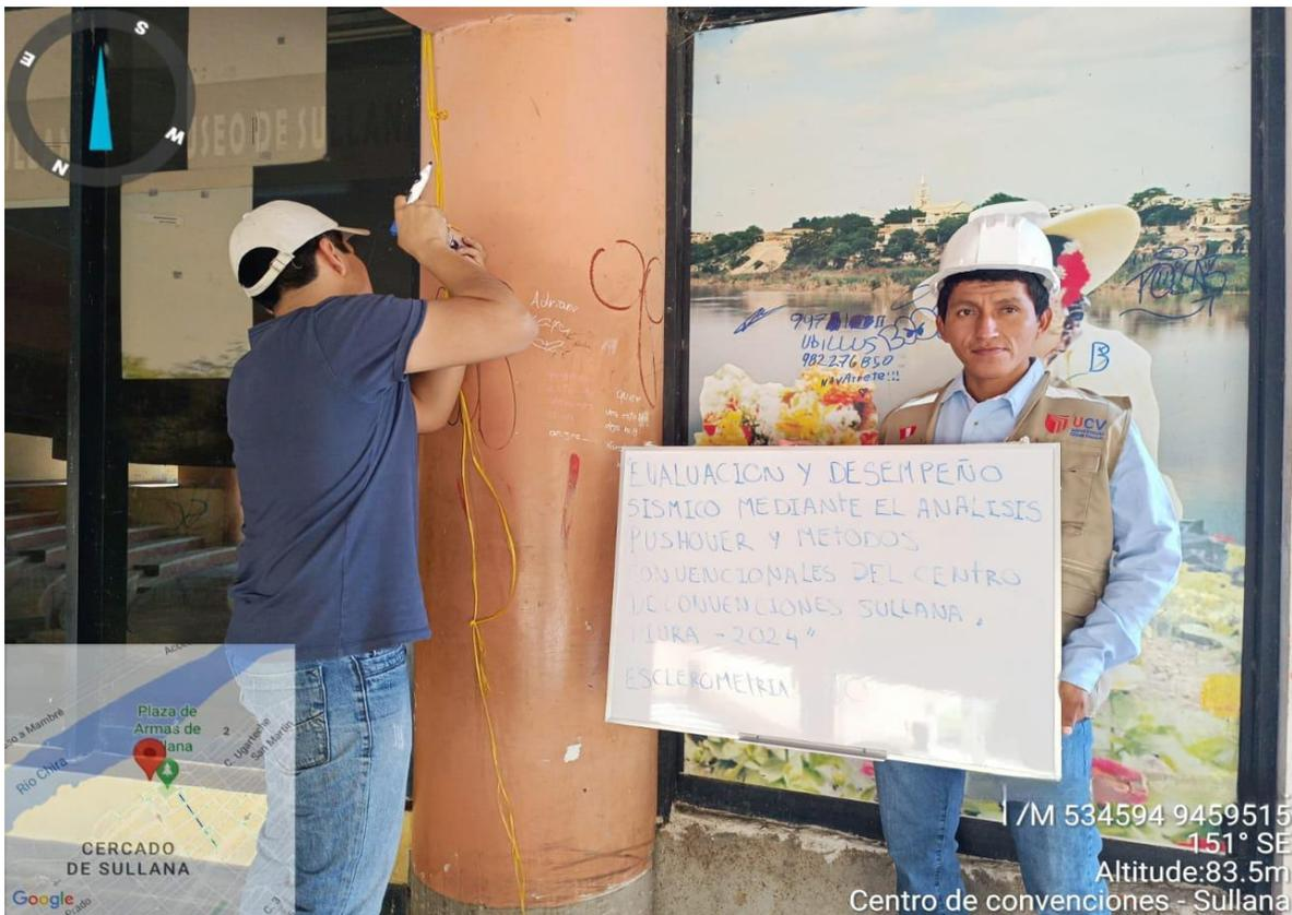
Ensayo de esclerometría (columna c-10)
