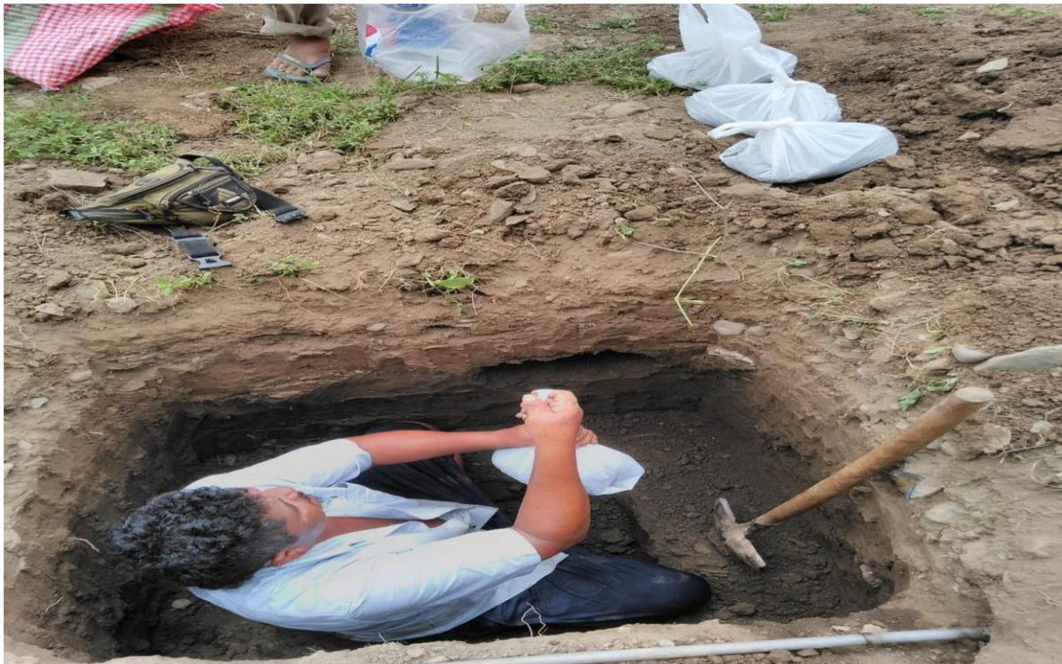
En esta imagen se observa la primera calicata, identificada como C-1, se ubicó a las coordenadas 17M 534605 9459512, con una orientación de 246° SW y una altitud de 3.6 metros. Durante este proceso, se procedió a excavar a con la barreta
