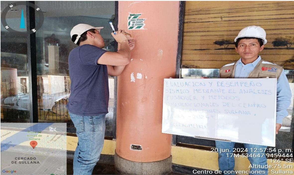
Ensayo de esclerometría (columna c-11)
