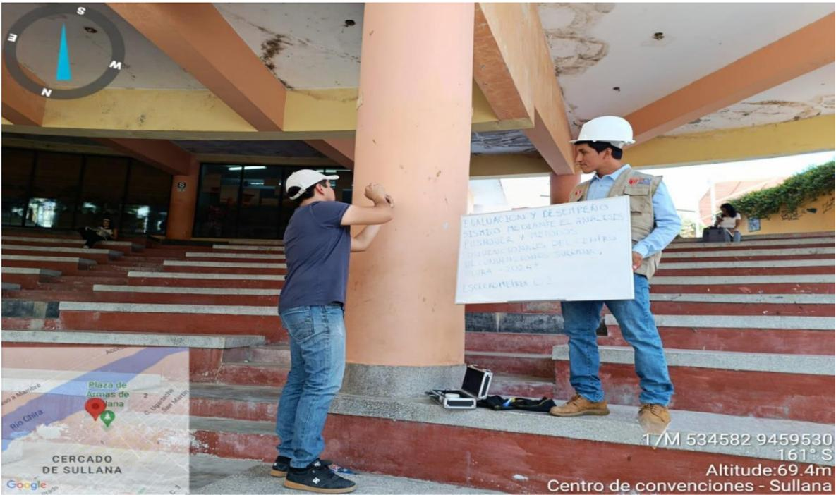
Ensayo de esclerometría (columna c-2)
