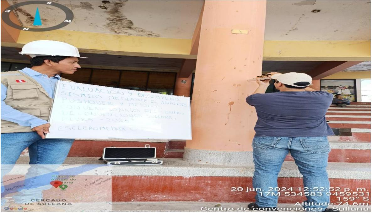
Ensayo de esclerometría (columna c-6)
