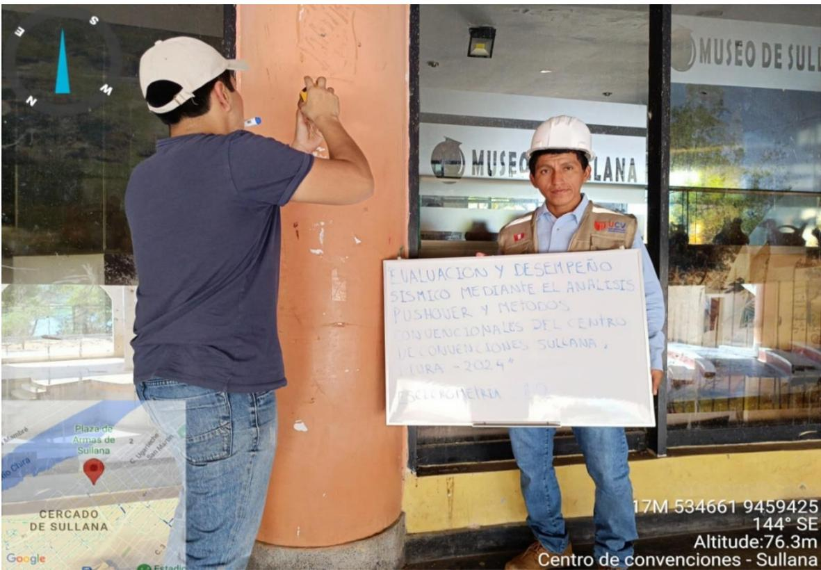
Ensayo de esclerometría (columna c-12)
