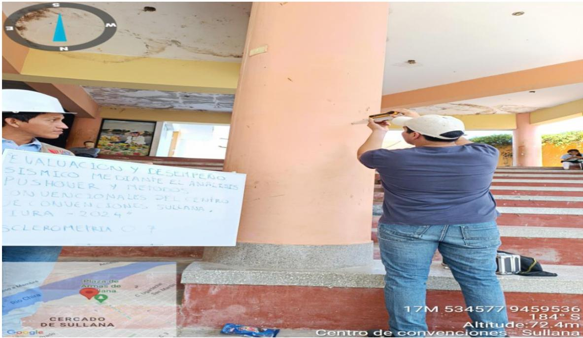
Ensayo de esclerometría (columna c-7)
