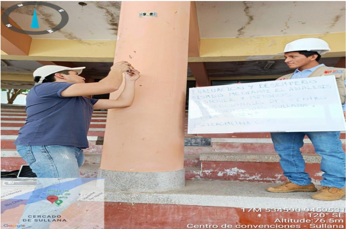
Ensayo de esclerometría (columna c-5)
