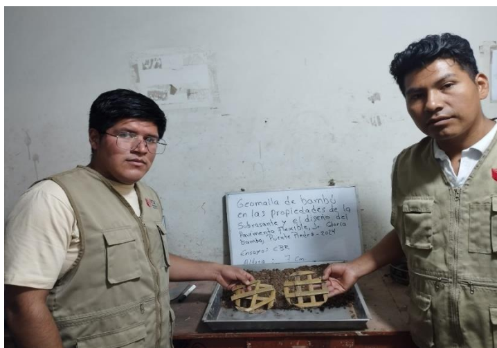
Figura 24. CBR mezcla de suelo y geomalla
