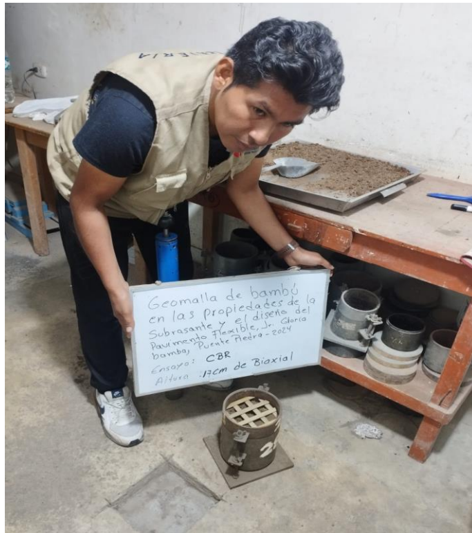
Figura 26. Geomalla biaxial a 12cm
