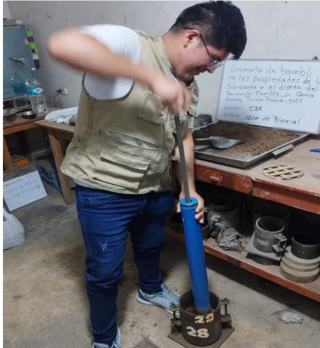
Figura 25. Compactación a una altura de 12cm
